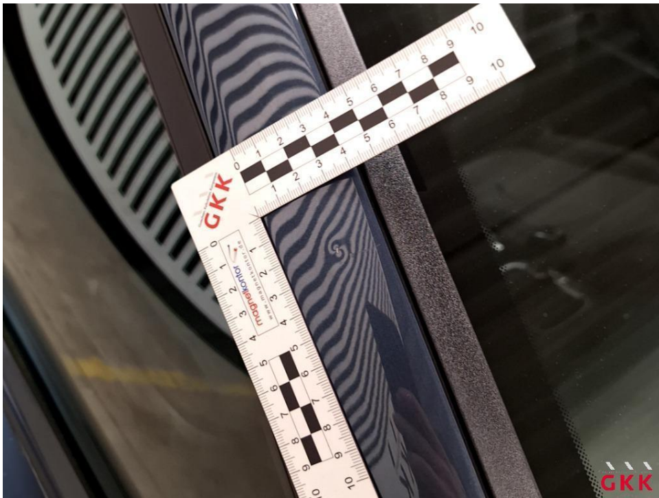
Bild 20 A- Säule rechts, beschädigt, Smartrepair
