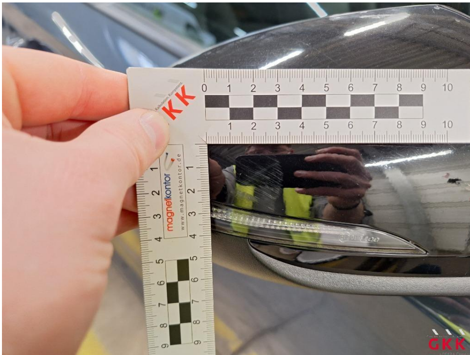
Bild 22 Spiegelgehäuse rechts, Blende -lackiert-, verkratzt, lackieren ohne LV
