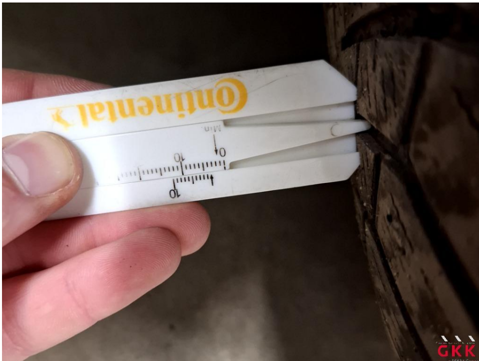
Bild 18 Reifen, vorn links und rechts, Untermaß, ersetzen
