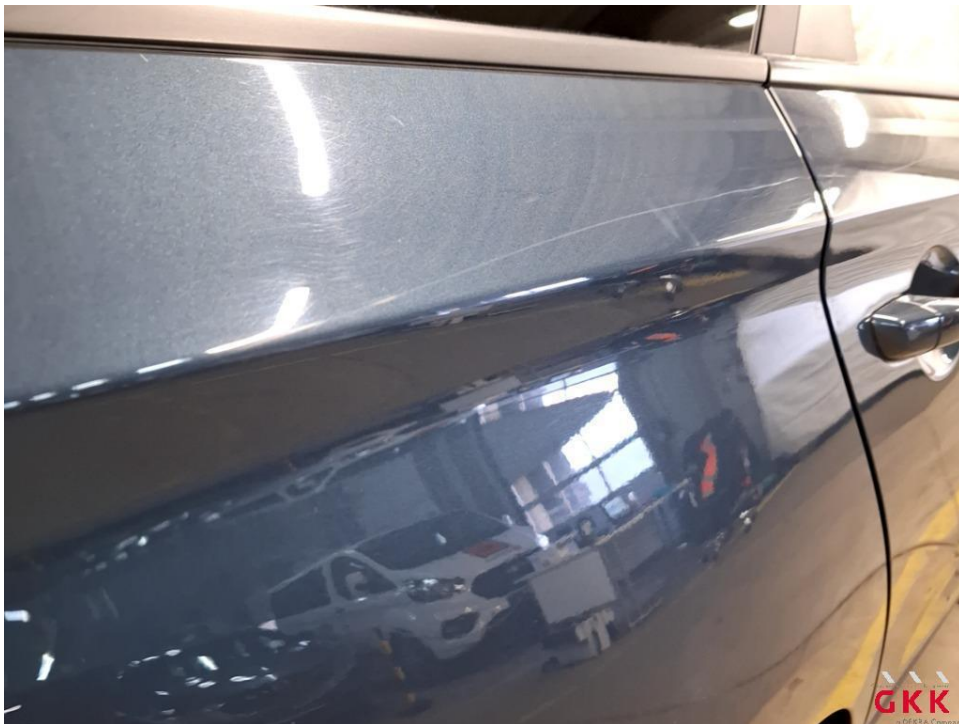
Bild 24 Fahrzeug, außen, verkratzt, polieren
