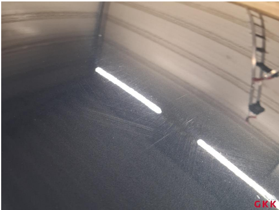
Bild 26 Fahrzeug, außen, verkratzt, polieren
