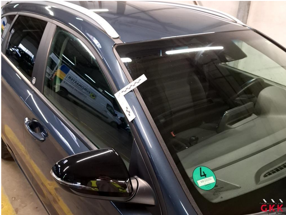
Bild 19 A- Säule rechts, beschädigt, Smartrepair
