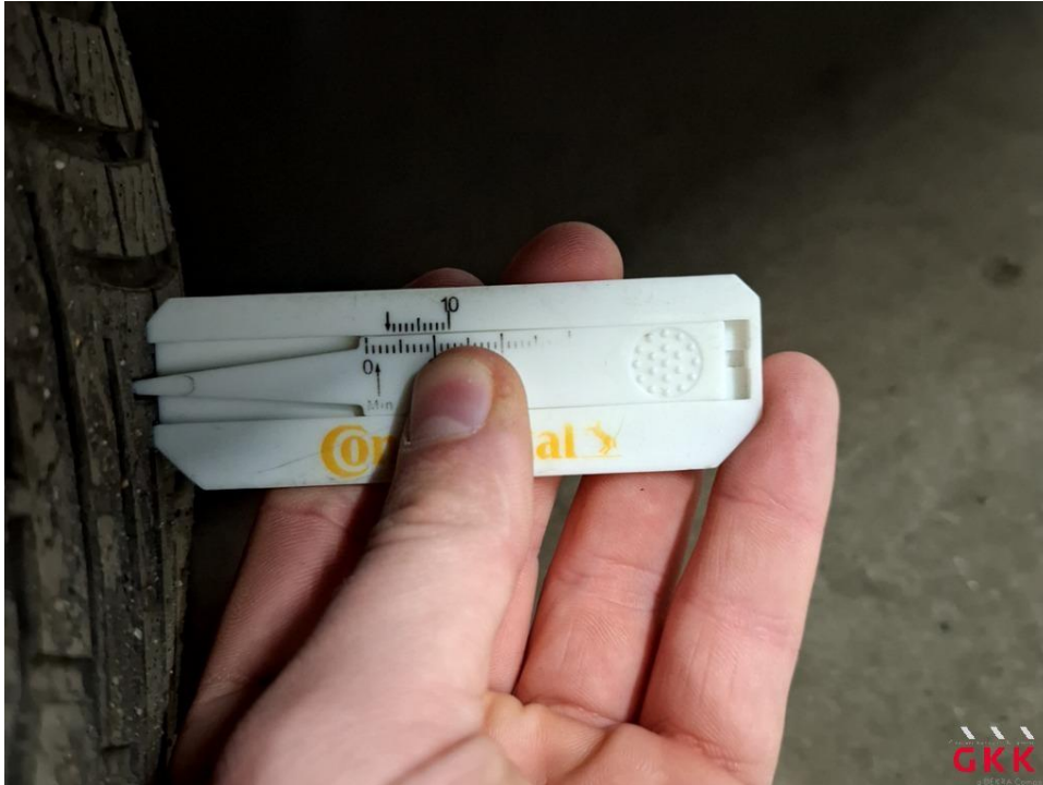
Bild 15 Reifen, hinten links und rechts, Untermaß, ersetzen
