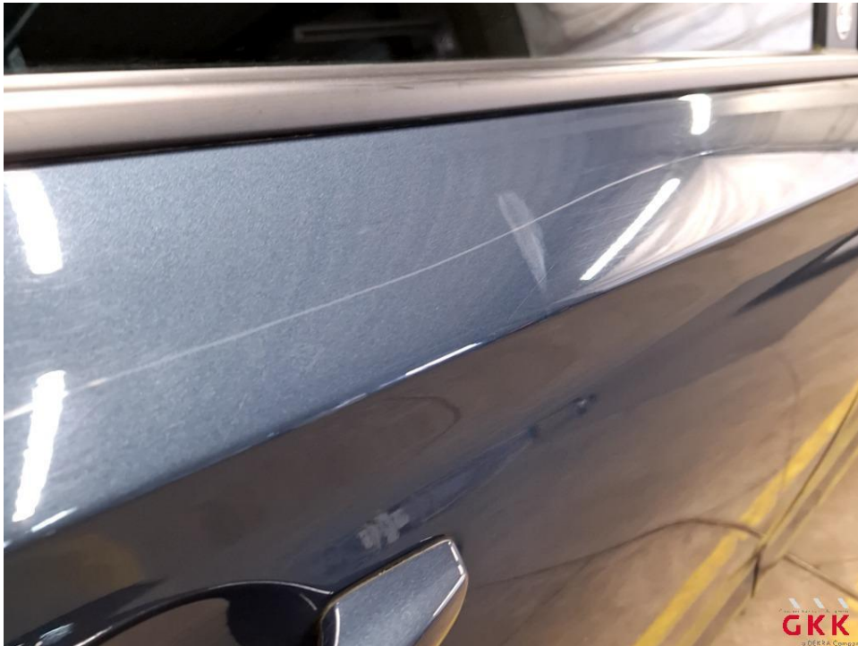
Bild 25 Fahrzeug, außen, verkratzt, polieren
