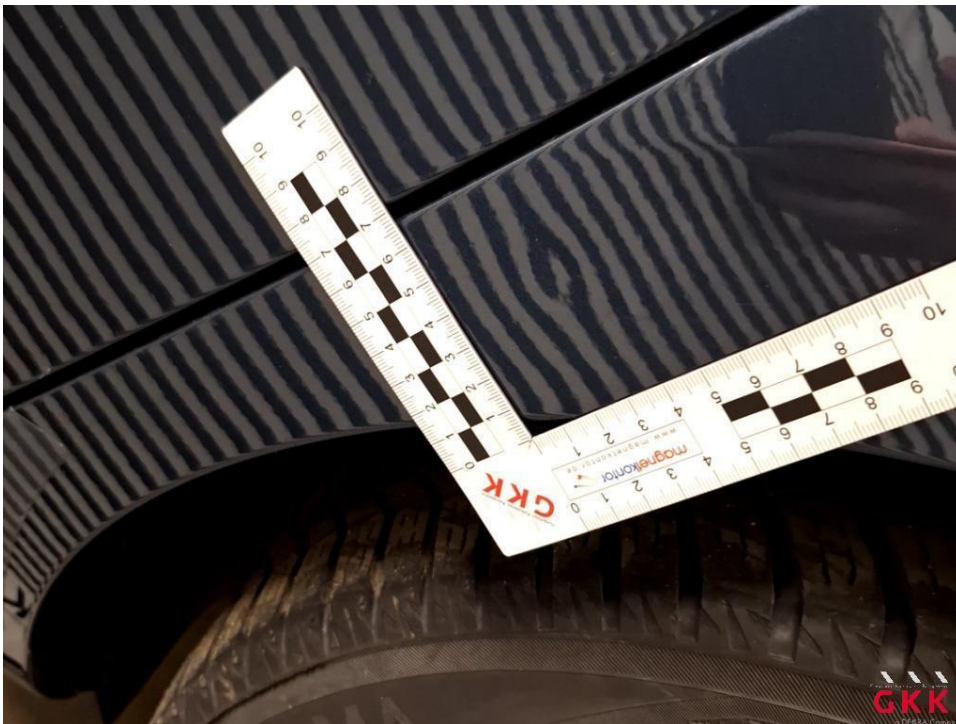
Bild 28 Seitenwand links, beschädigt, kalt drücken
