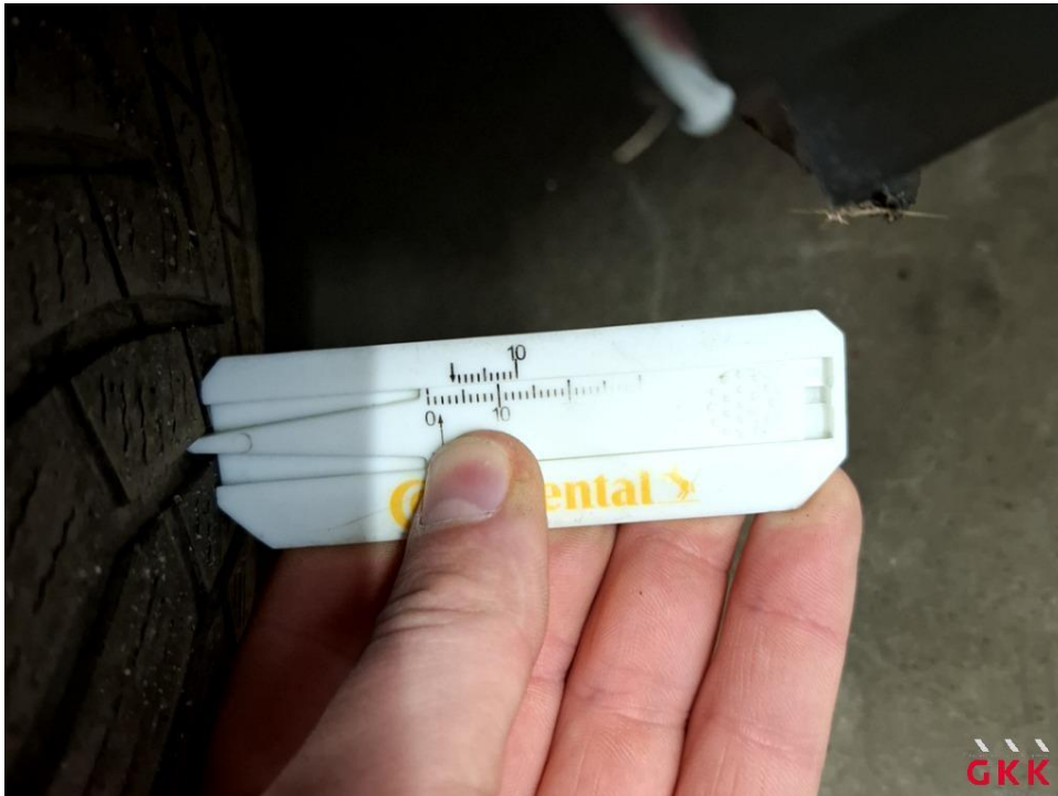
Bild 17 Reifen, vorn links und rechts, Untermaß, ersetzen
