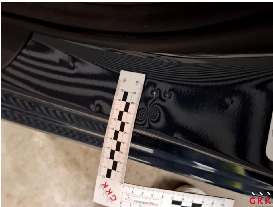
Bild 30 Tür vorne links, Einstieg, beschädigt, instand setzen - lackieren
