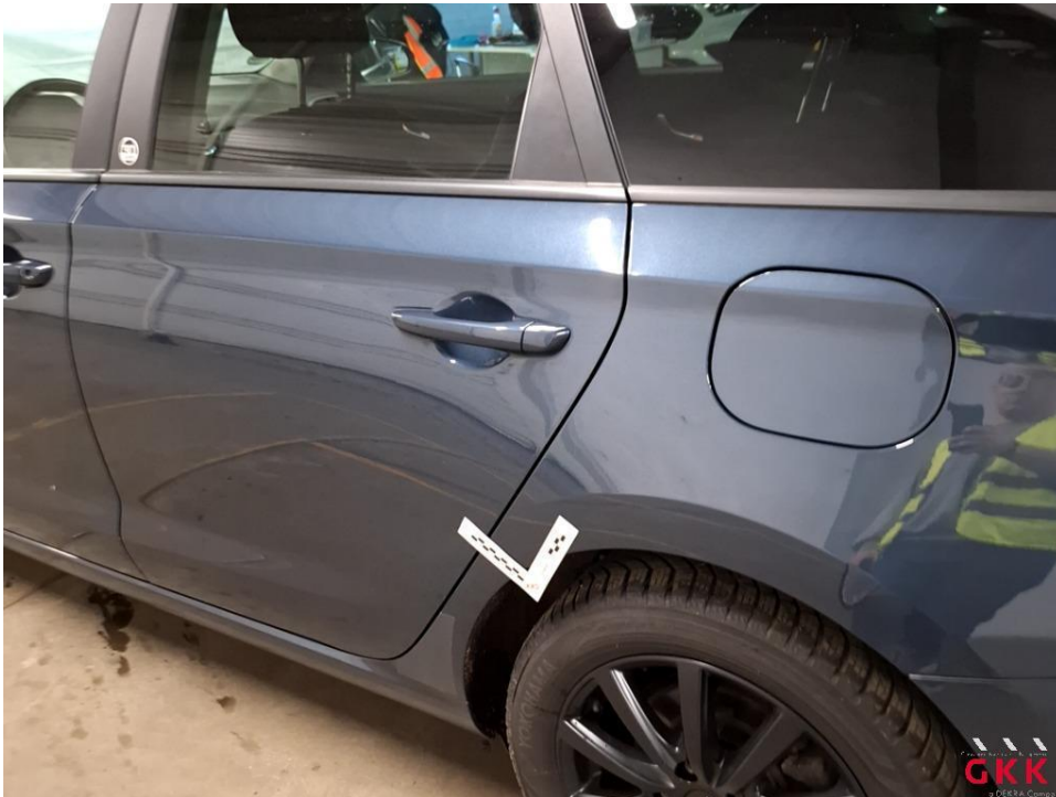
Bild 27 Seitenwand links, beschädigt, kalt drücken
