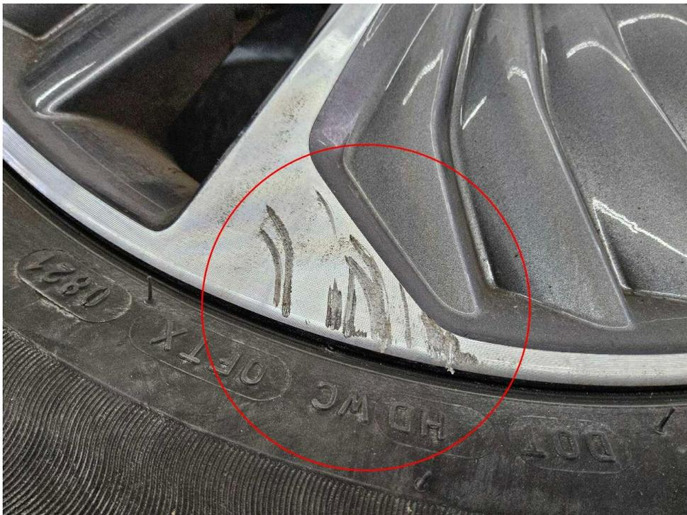
Bild 16 : Alufelge hinten links, verschrammt - Minderwert
