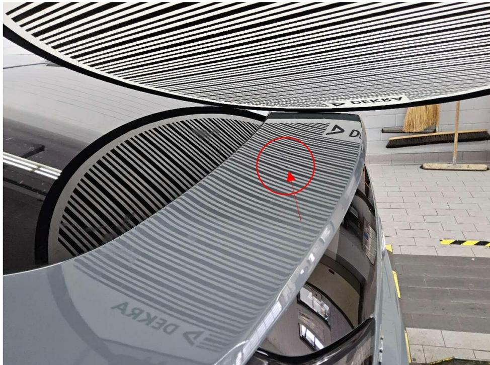
Bild 19 : Heckklappe, Dellen
