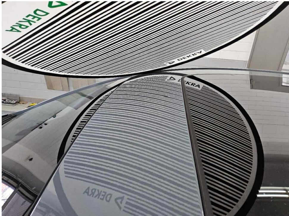
Bild 17 : Dach, Delle
