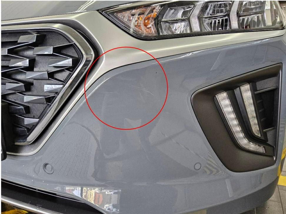
Bild 23 : Stoßfänger vorne, verschrammt
