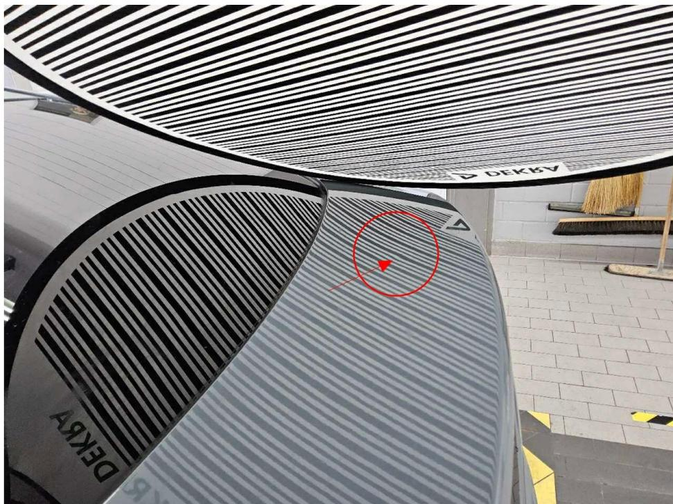
Bild 18 : Heckklappe, Dellen
