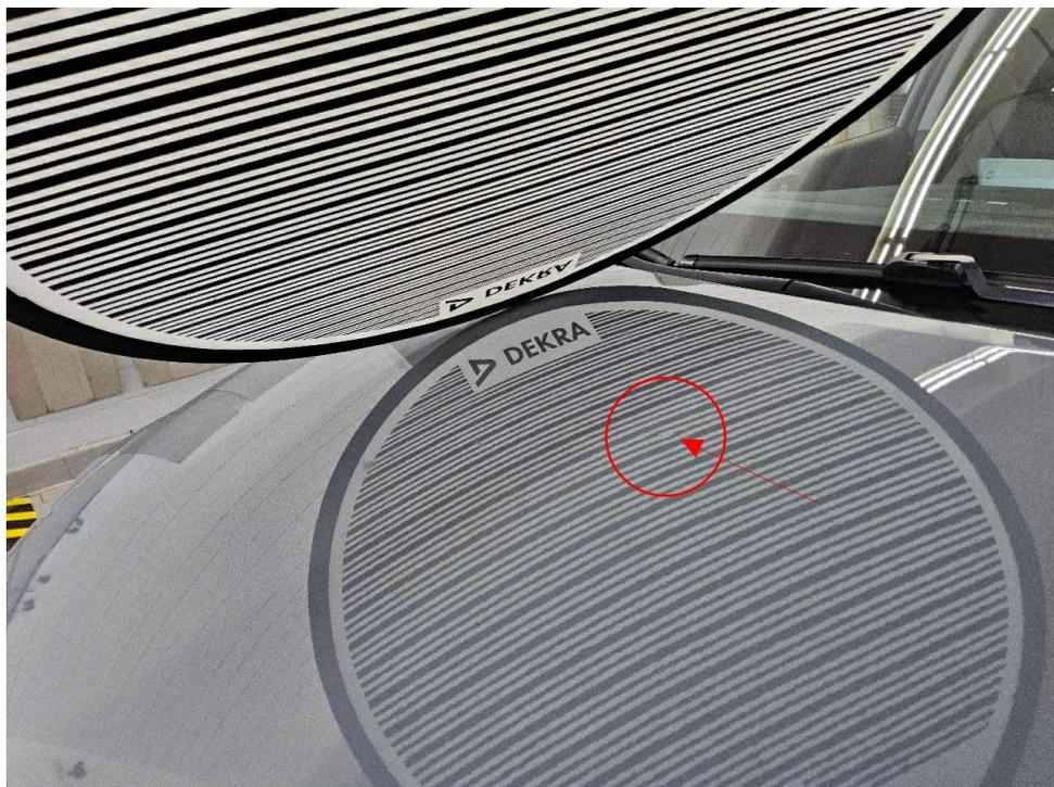
Bild 22 : Motorhaube, Delle
