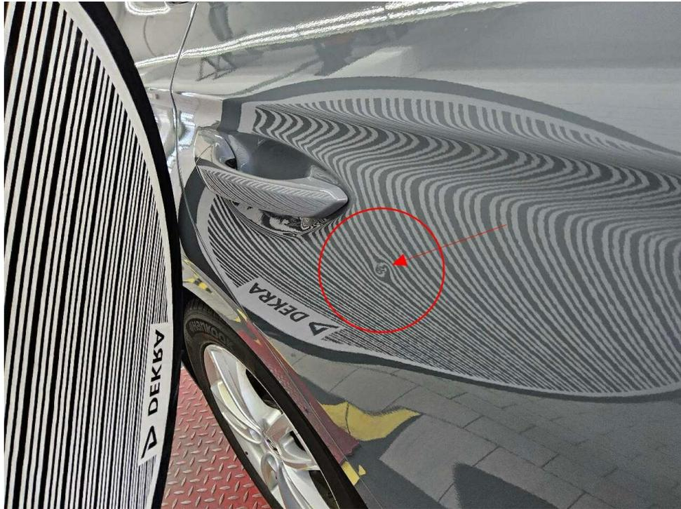
Bild 21 : Tür hinten rechts, Delle
