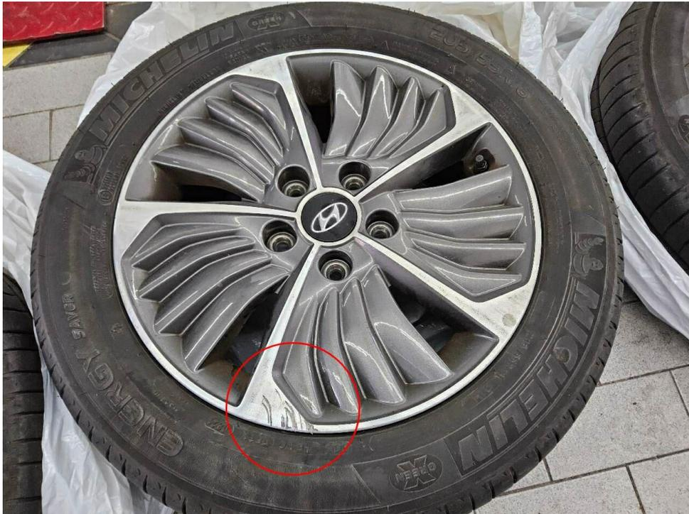
Bild 15 : Alufelge hinten links, verschrammt -Minderwert
