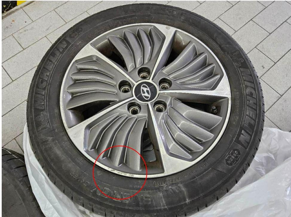
Bild 13 : Alufelge hinten rechts, Kratzer
