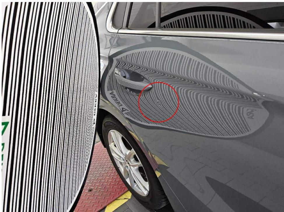
Bild 20 : Tür hinten rechts, Delle
