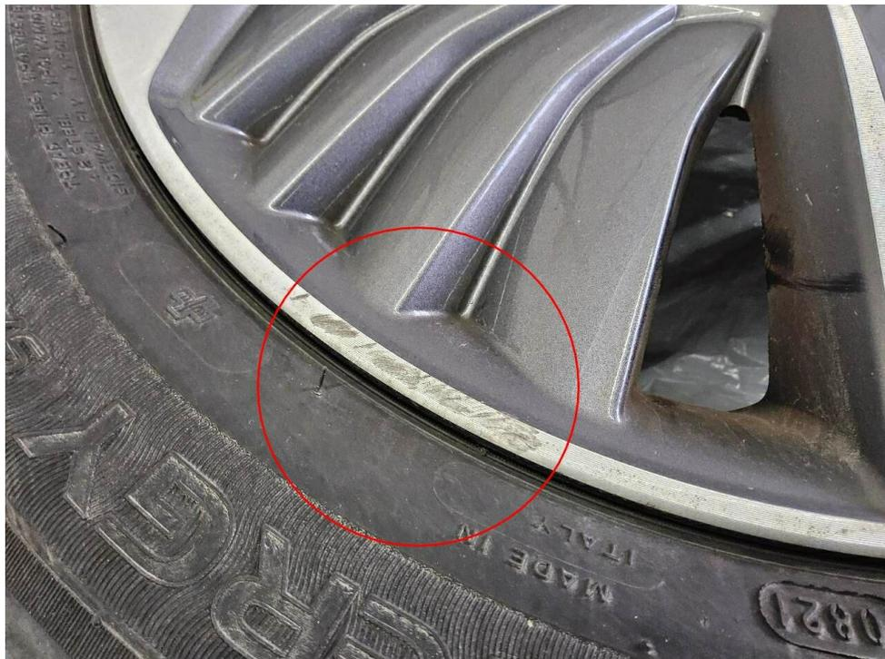
Bild 14 : Alufelge hinten rechts, Kratzer
