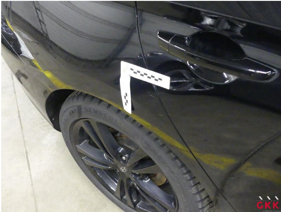
Bild 27 Seitenwand rechts, beschädigt, instand setzen - lackieren
