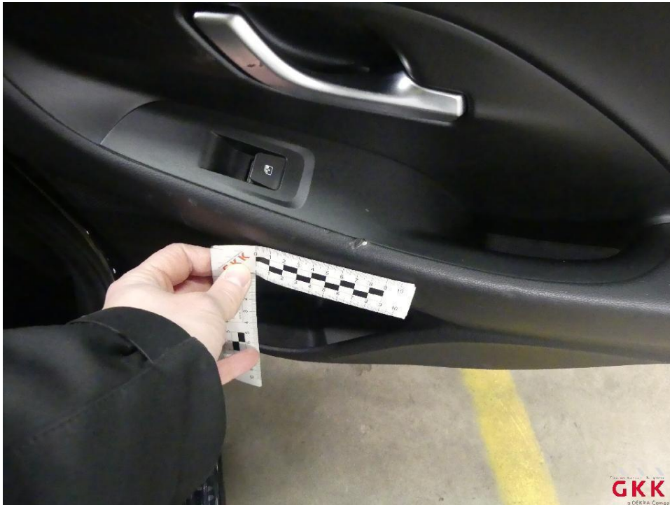
Bild 33 Tür hinten rechts, Innenverkleidung -Abdeckung-, beschädigt, ersetzen
