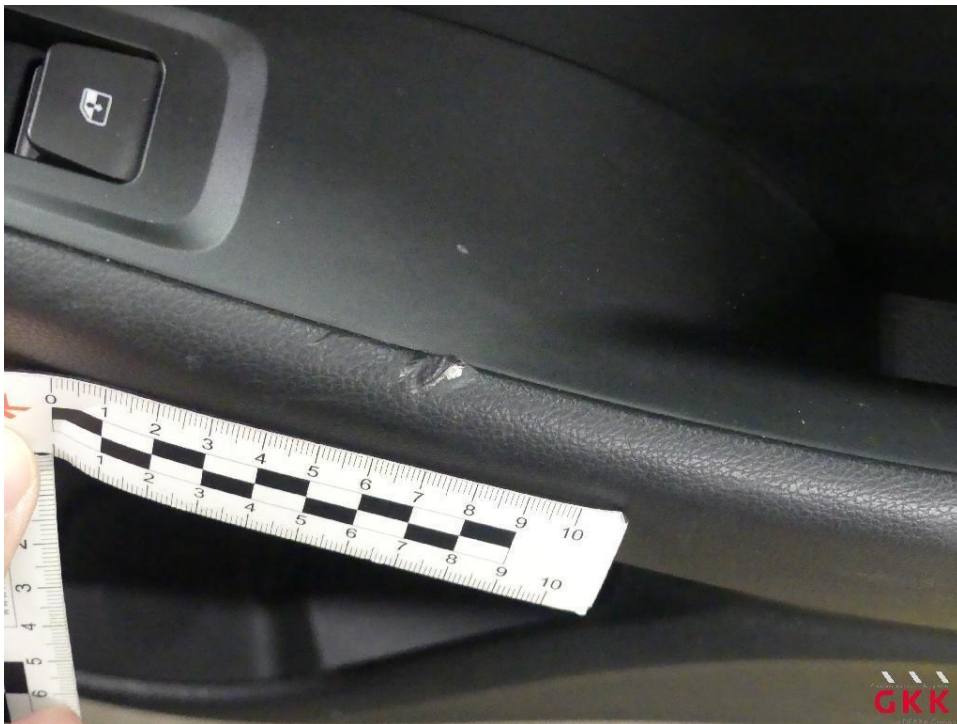
Bild 34 Tür hinten rechts, Innenverkleidung -Abdeckung-, beschädigt, ersetzen
