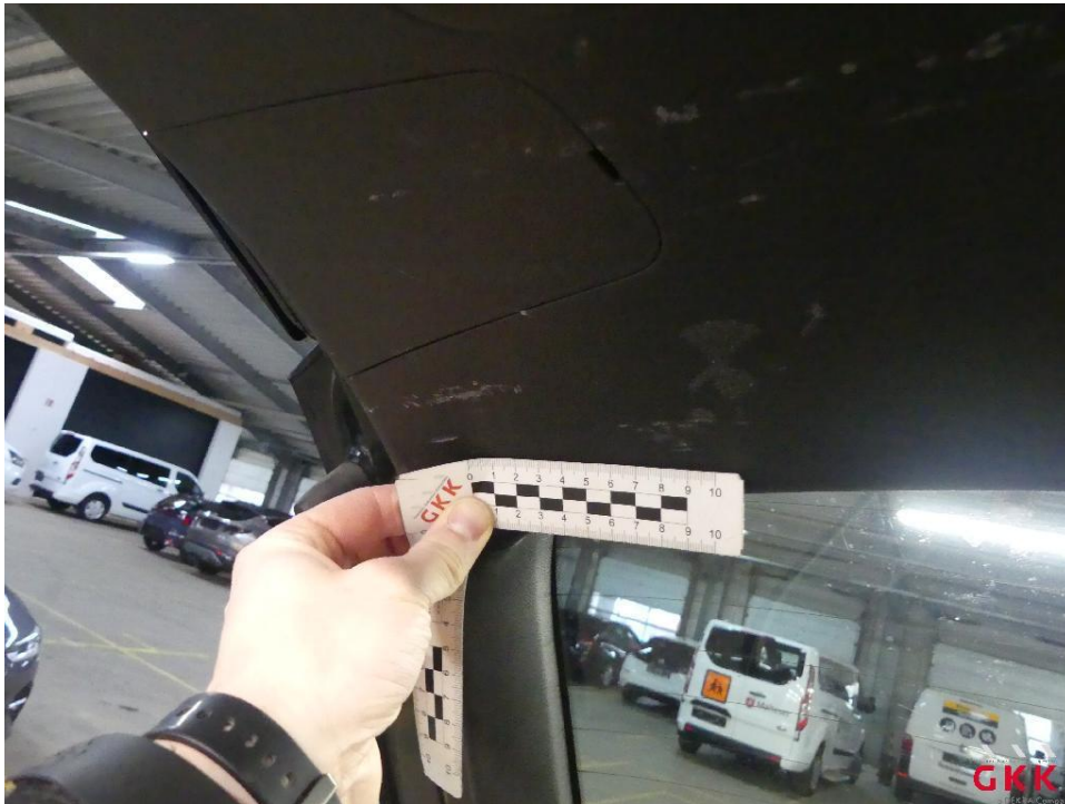
Bild 37 Heckklappe, Innenverkleidung, verkratzt, ersetzen
