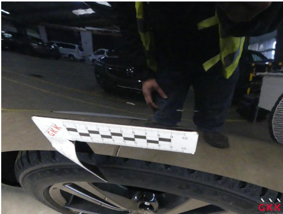
Bild 46 Seitenwand links, beschädigt, instand setzen - lackieren
