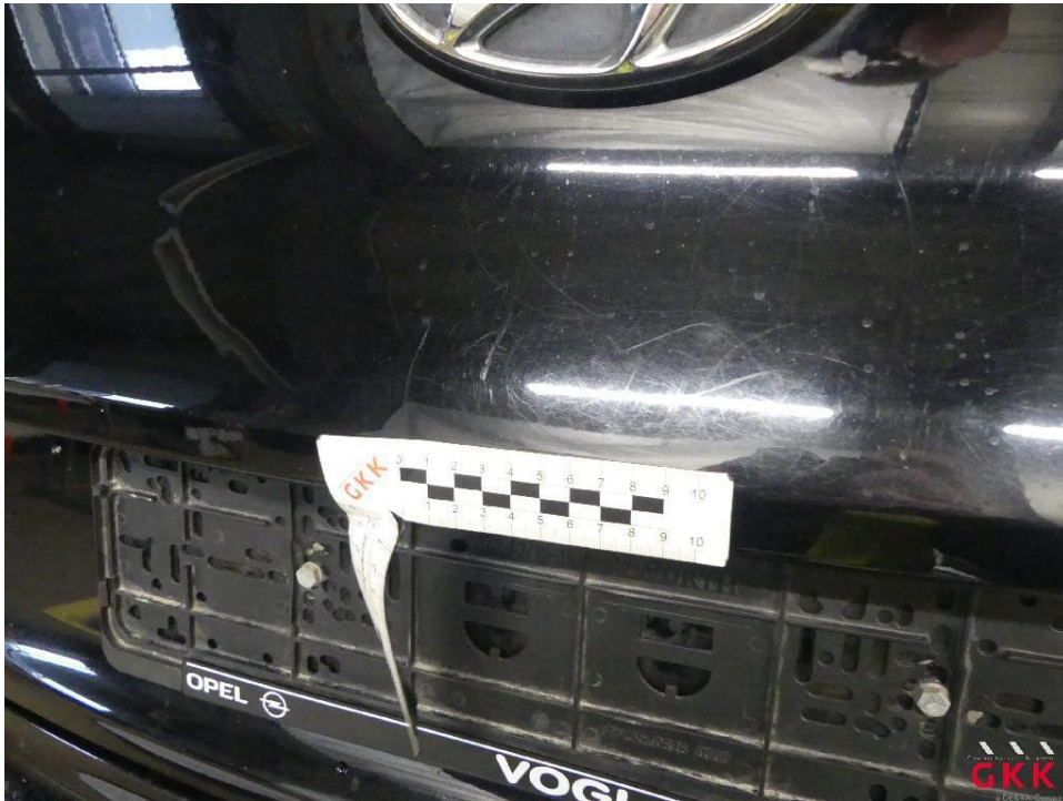
Bild 39 Heckklappe, verkratzt, lackieren
