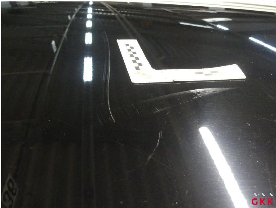
Bild 32 Dach, verkratzt, lackieren
