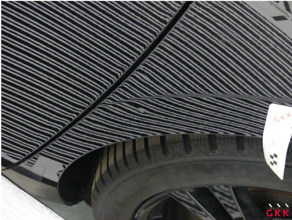
Bild 47 Seitenwand links, beschädigt, instand setzen - lackieren
