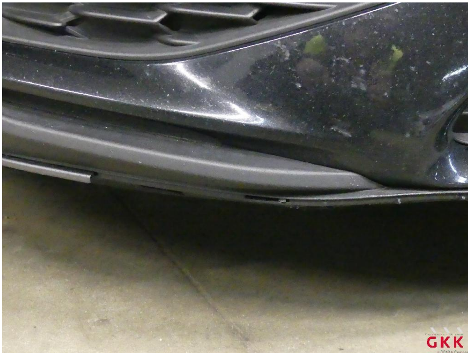
Bild 20 Stoßfänger vorne, Leiste -rechts-, beschädigt, ersetzen
