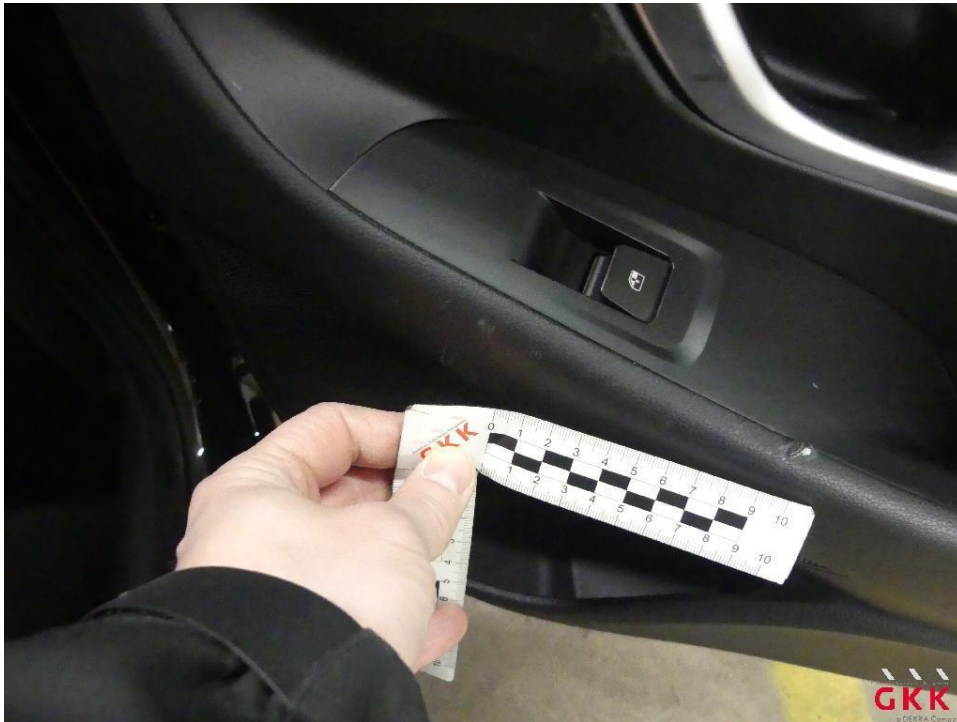
Bild 35 Tür hinten rechts, Innenverkleidung -Abdeckung-, beschädigt, ersetzen
