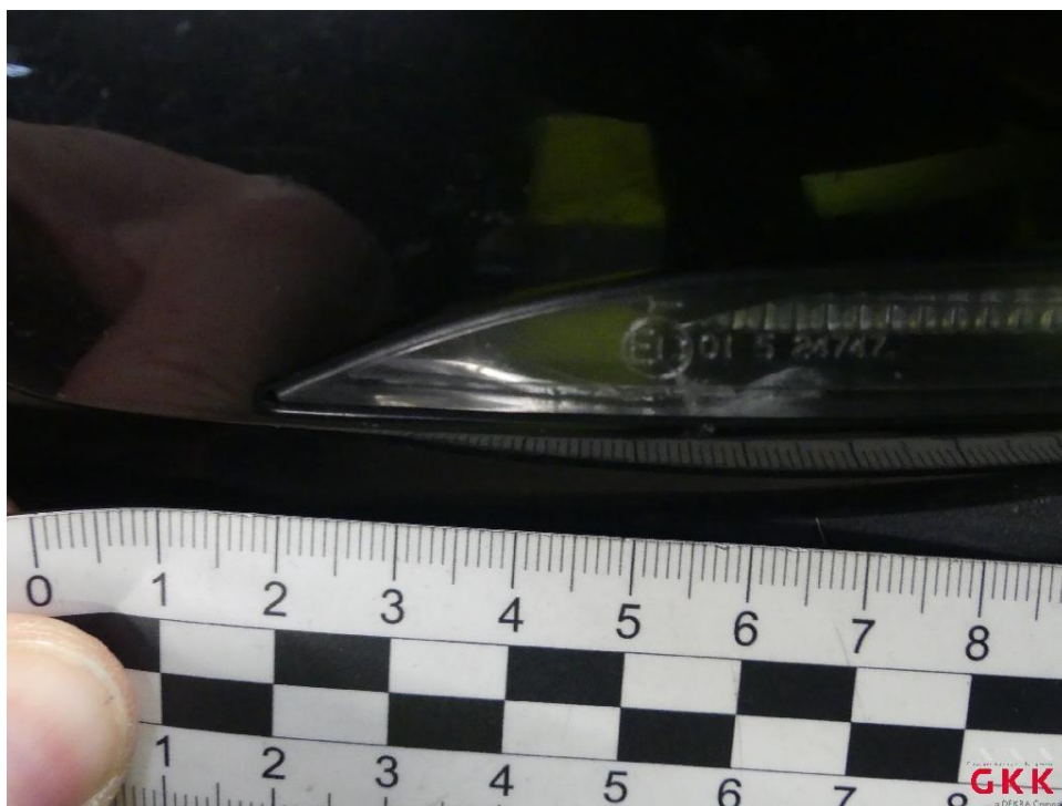
Bild 16 Spiegelgehäuse links, Blinker, zerbrochen, ersetzen
