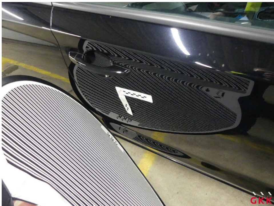
Bild 21 Tür vorne rechts, beschädigt, instand setzen - lackieren
