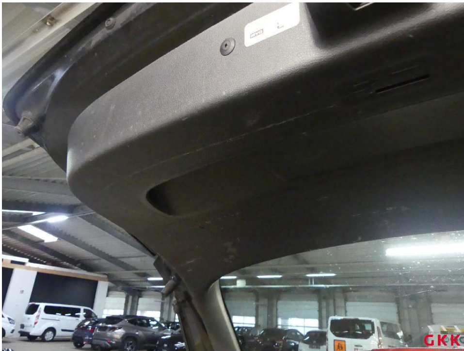
Bild 36 Heckklappe, Innenverkleidung, verkratzt, ersetzen
