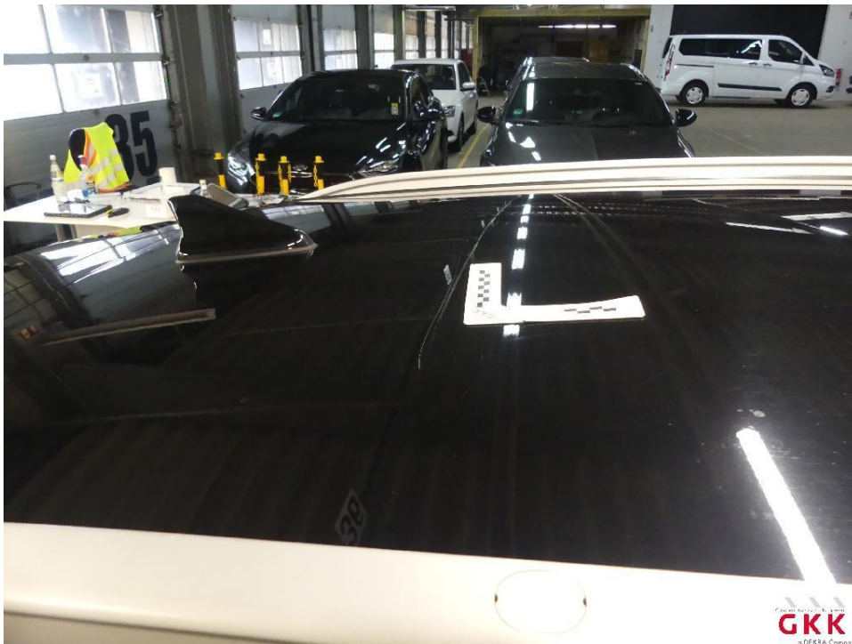
Bild 30 Dach, verkratzt, lackieren
