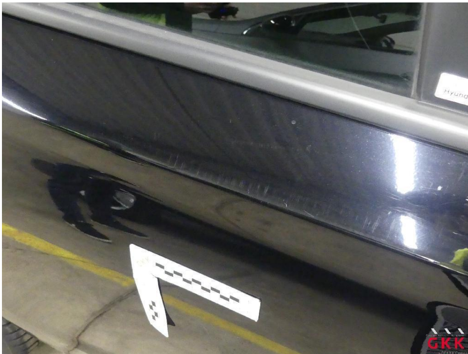
Bild 26 Tür hinten rechts, verkratzt, lackieren
