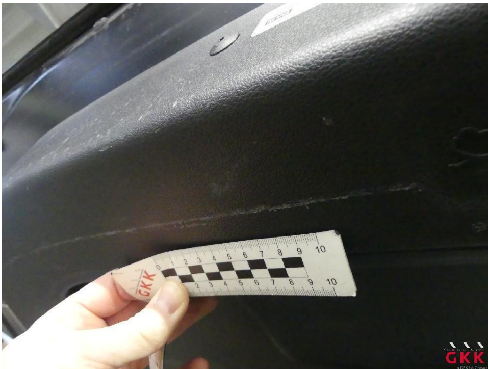
Bild 38 Heckklappe, Innenverkleidung, verkratzt, ersetzen
