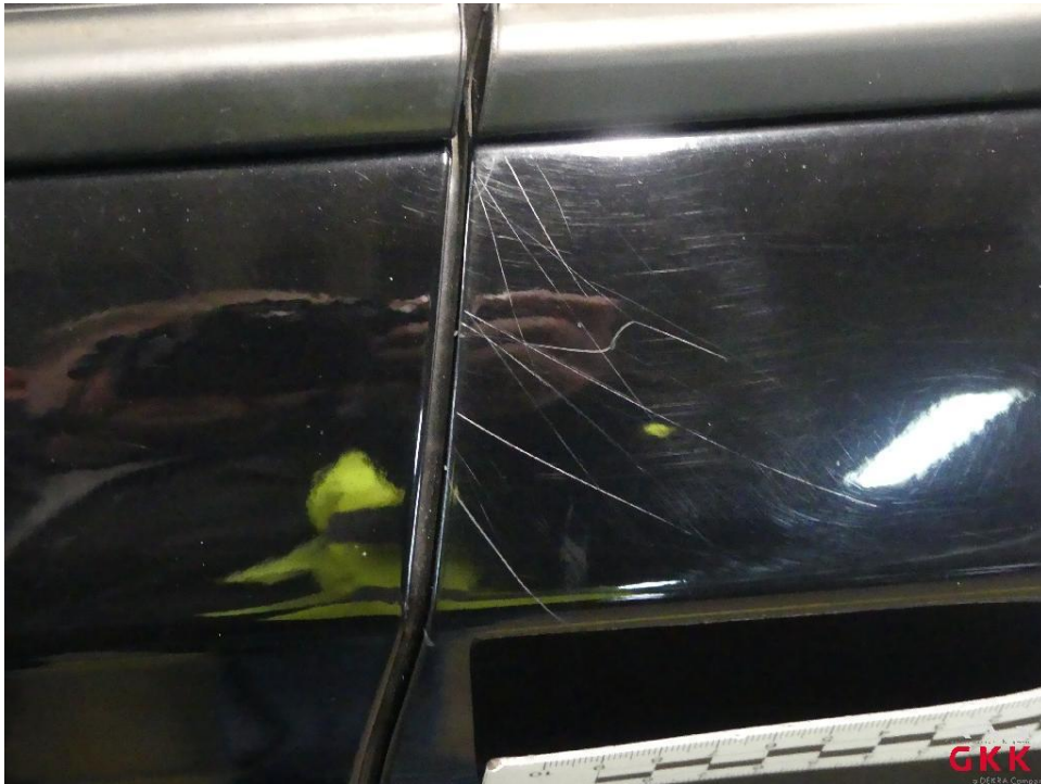
Bild 49 Tür hinten links, verkratzt, lackieren
