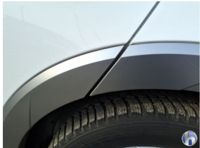
6. Radlaufverbreiterung li.hi. Kratzer - Lackieren
