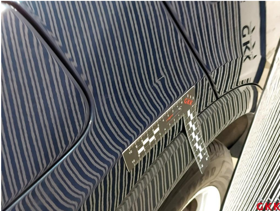
Bild 30. Seitenwand rechts, beschädigt, instand setzen - lackieren
