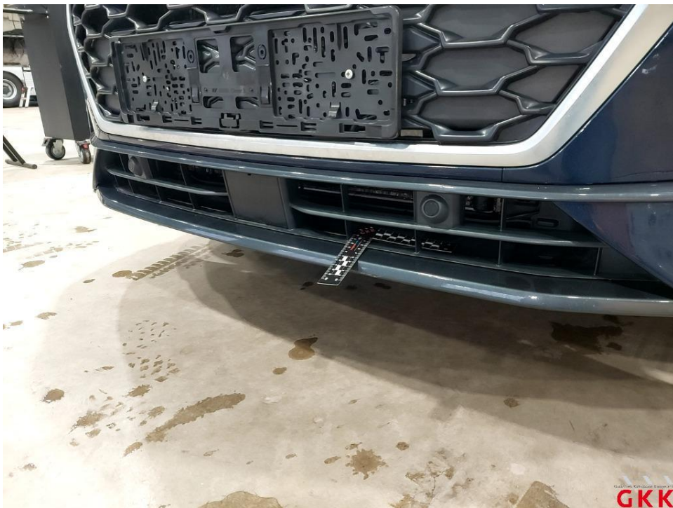
Bild 16. Stoßfänger vorne, Spoiler -lackiert-, verkratzt, lackieren
