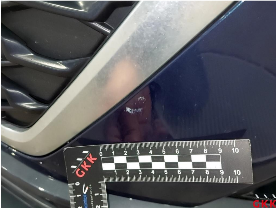
Bild 19. Stoßfänger vorne, Verkleidung -lackiert-, Steinschlag und Kratzer, auslegen, schleifen, polieren
