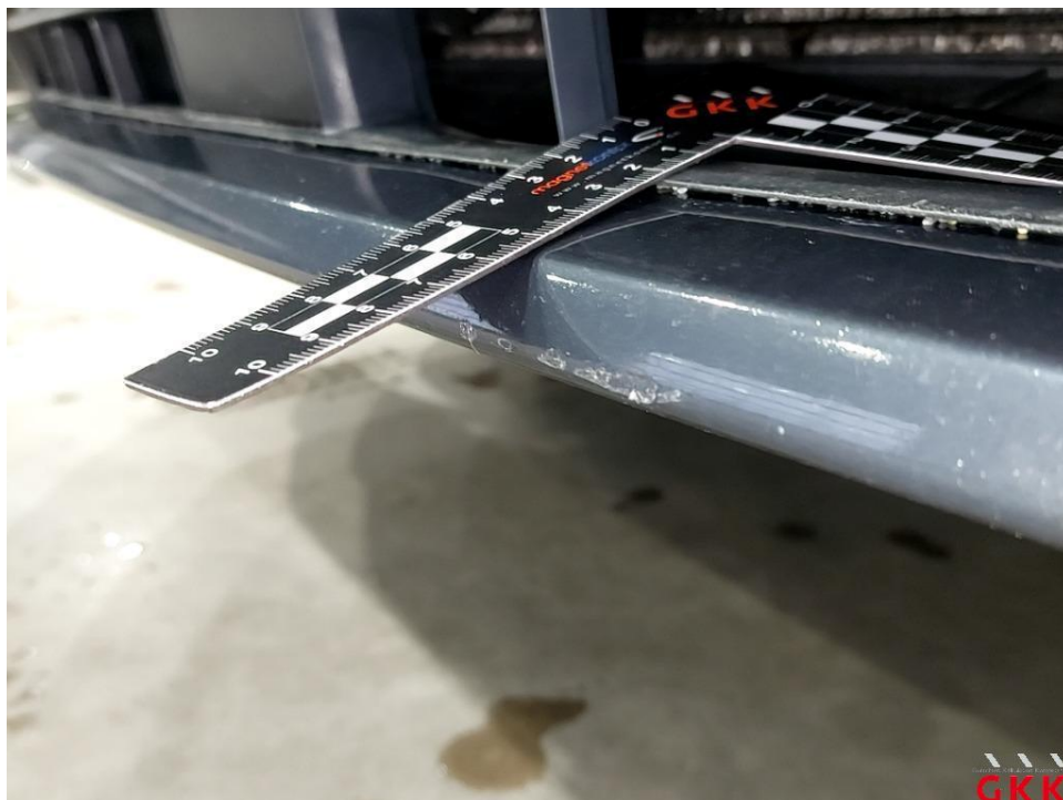
Bild 17. Stoßfänger vorne, Spoiler -lackiert-, verkratzt, lackieren
