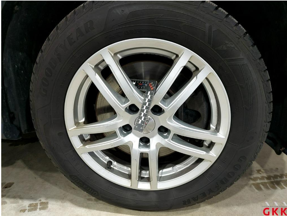
Bild 31. LM-Rad, vorne rechts, verkratzt, lackieren
