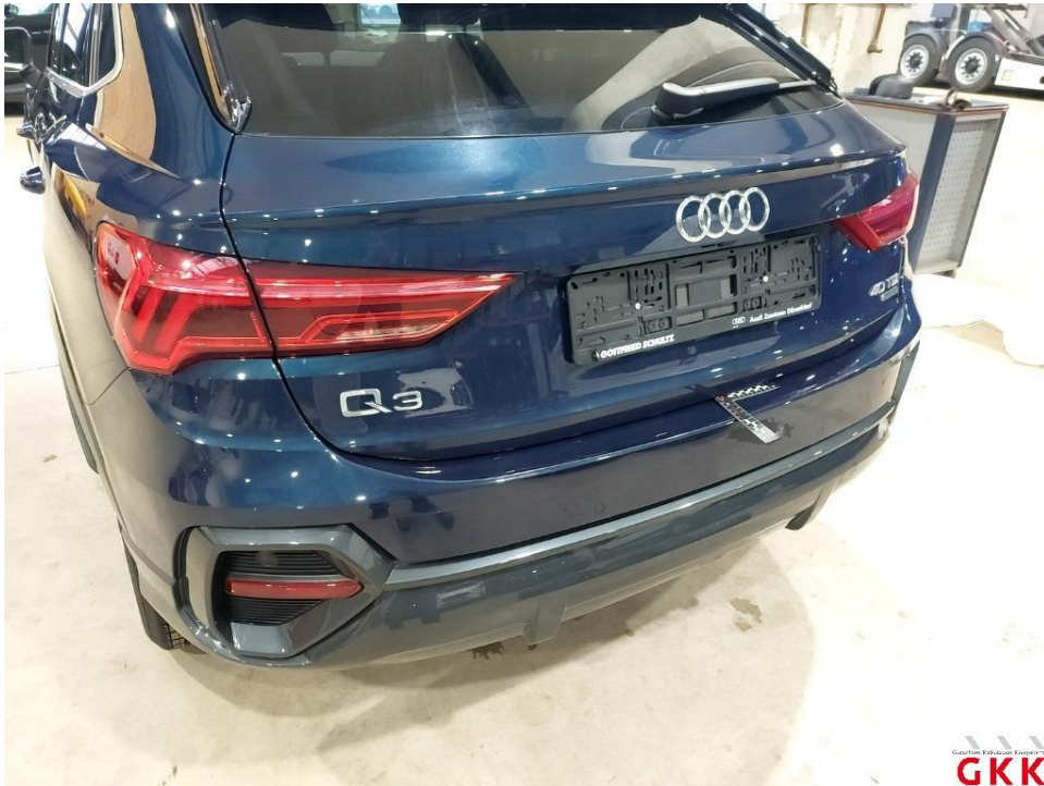
Bild 24. Stoßfänger hinten, Verkleidung oberhalb -lackiert-, verkratzt, lackieren
