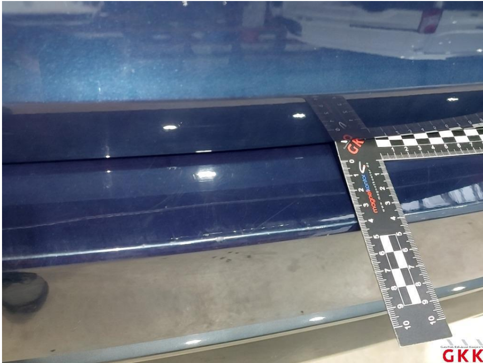
Bild 25. Stoßfänger hinten, Verkleidung oberhalb -lackiert-, verkratzt, lackieren
