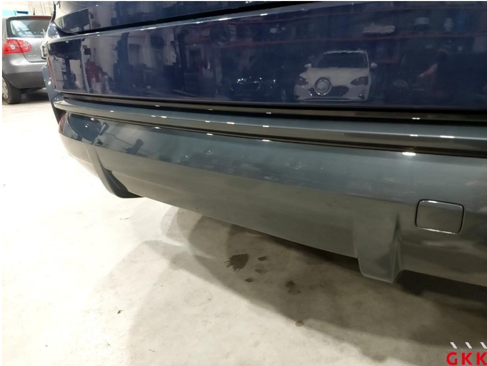
Bild 27. Stoßfänger hinten, Verkleidung unterhalb -lackiert-, verkratzt, lackieren
