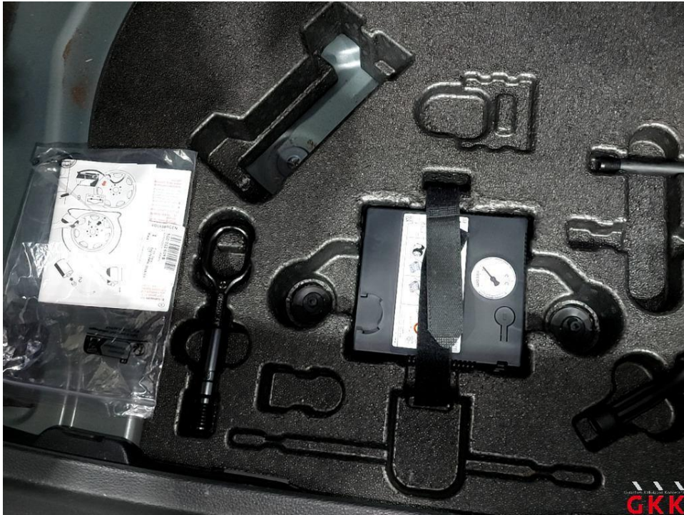
Bild 13. Reifenreparaturset, Füllflasche, fehlt, ersetzen
