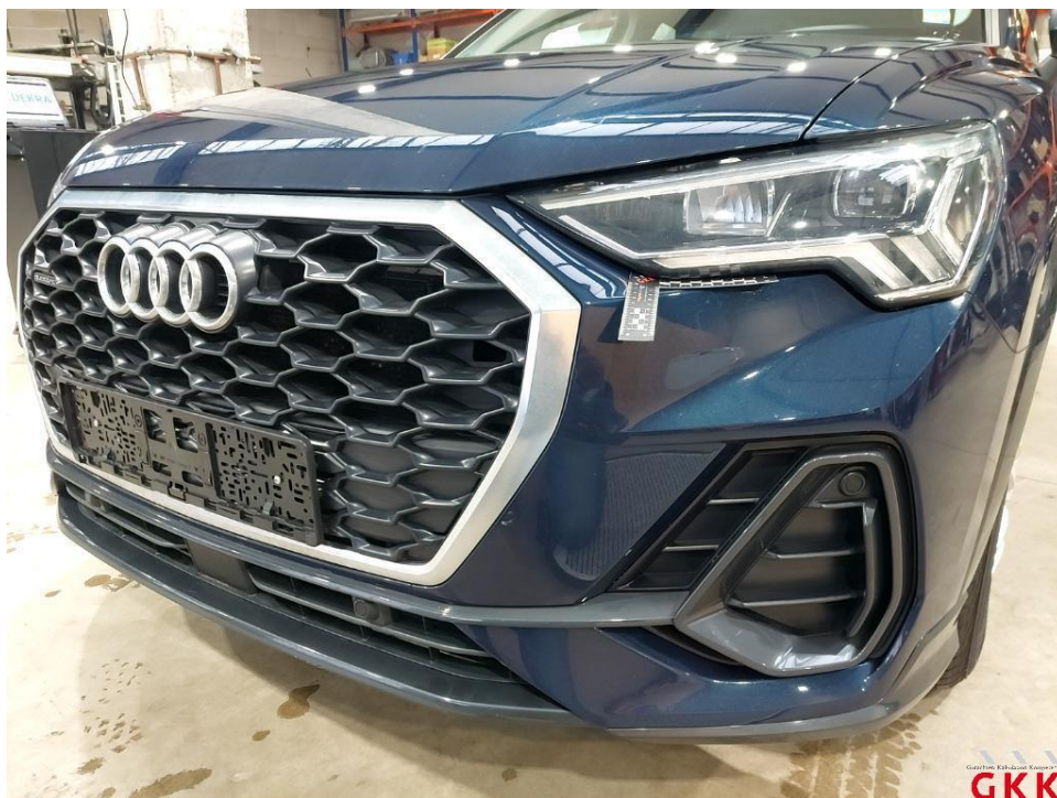
Bild 18. Stoßfänger vorne, Verkleidung -lackiert-, Steinschlag und Kratzer, auslegen, schleifen, polieren
