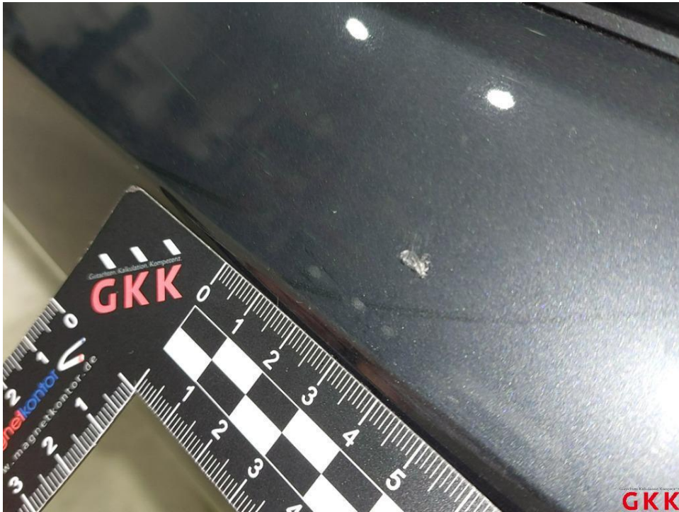
Bild 28. Stoßfänger hinten, Verkleidung unterhalb -lackiert-, verkratzt, lackieren
