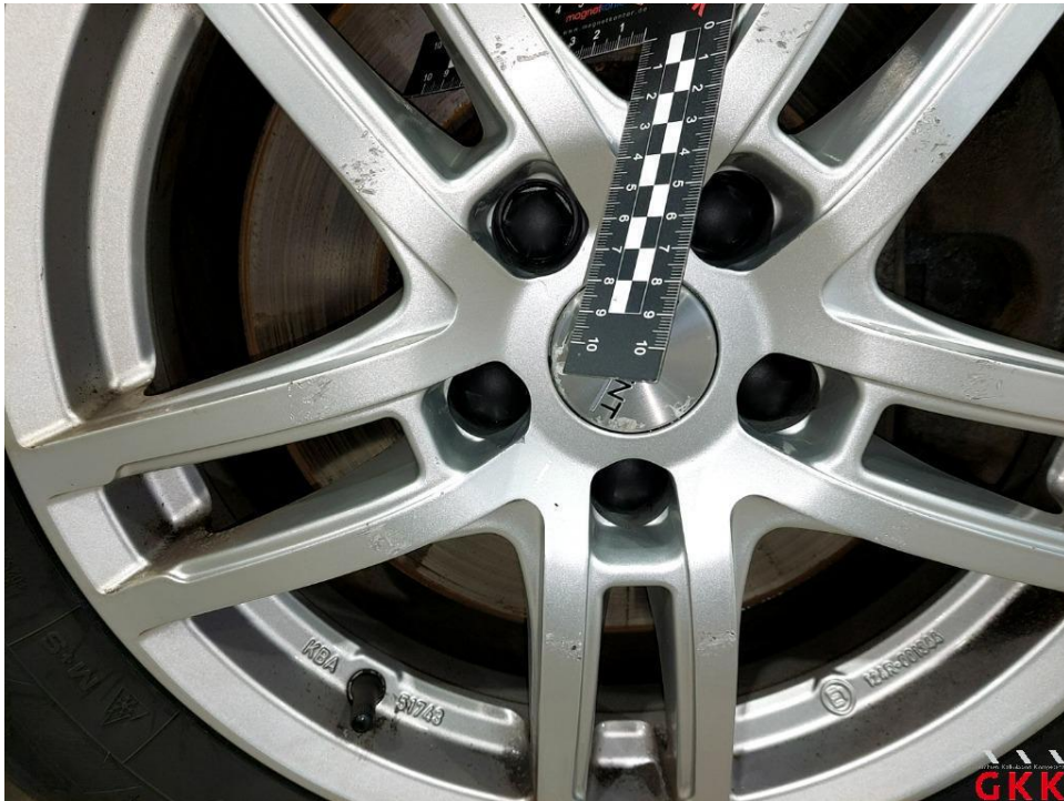
Bild 32. LM-Rad, vorne rechts, verkratzt, lackieren
