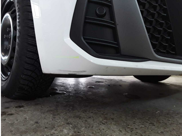
Domage #2: Pare-chocs avant: Pare-chocs avant - Rayure(s) - Réparation intelligente
