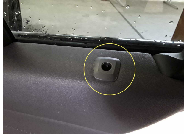
Domage #7: Habillages/Protections: Habillages/Protections (Stift Fehlt Tür hi re.) - Démontier/monter
