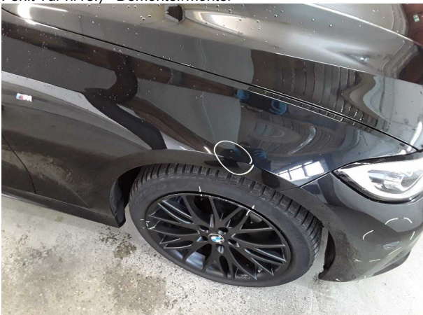
Domage #8: Garde-boue droit: Garde-boue droit - bosse(s) - B... travail de réparation
