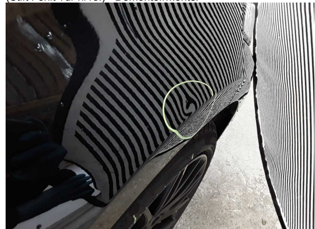
Domage #8: Garde-boue droit: Garde-boue droit - bosse(s) - Bon travail de réparation
