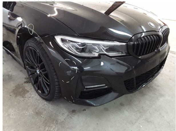
Domage #11: Pare-chocs avant: Pare-chocs avant - Erafilé - Réparer et repeindre
