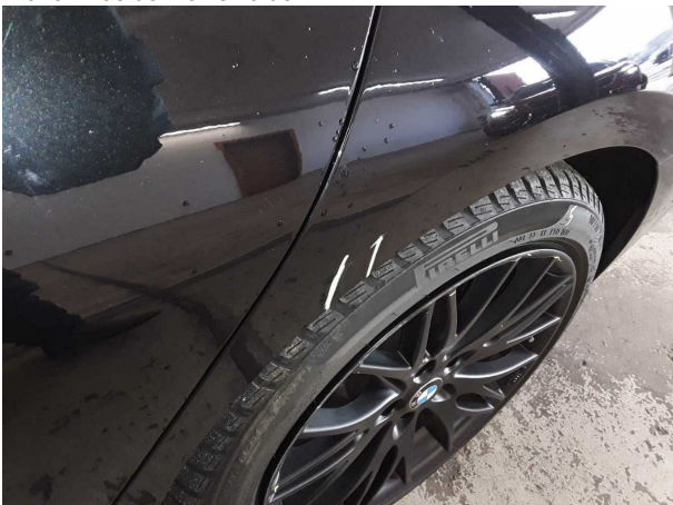
Domage #6: Panneau latéral arrière gauche: Paroi latérale - Rayure(s) - Revêtement/polissage
