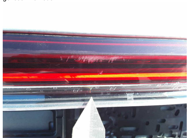
Beschädigung #5: Heckleuchte: Heckleuchte - verkratzt / verschürft - erneuern
