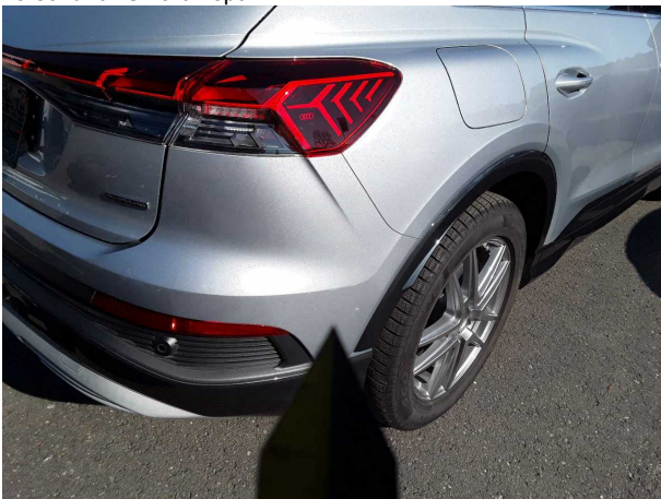
Beschädigung #2: Stossfänger hinten: Stossfänger hinten - verkratzt / verschürft - Smart Repair
