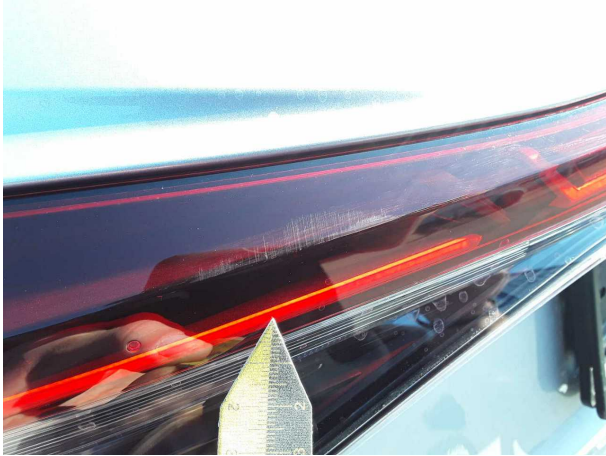
Beschädigung #5: Heckleuchte: Heckleuchte - verkratzt / verschürft - erneuern
