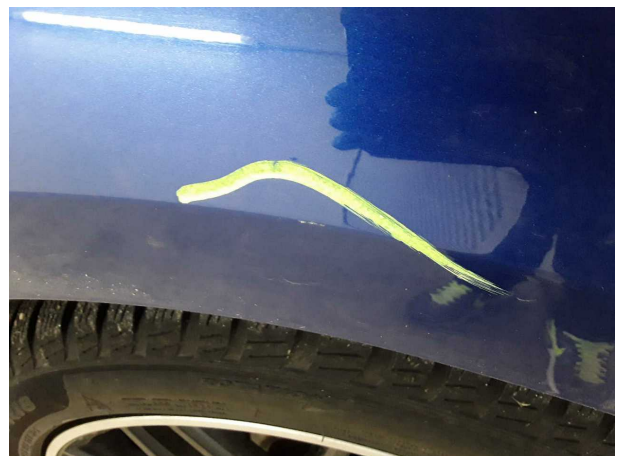
Domage #11: Panneau latéral arrière droit: Paroi latérale - Bosse, dommage peinture - Réparer et repeindre
