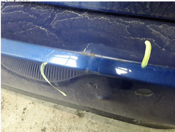
Domage #12: Pare-chocs arrière: Pare-chocs arrière - Déformé - Remplacer
