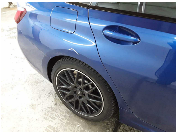
Domage #11: Panneau latéral arrière droit: Paroi latérale - Bos... dommage peinture - Réparer et repeindre
