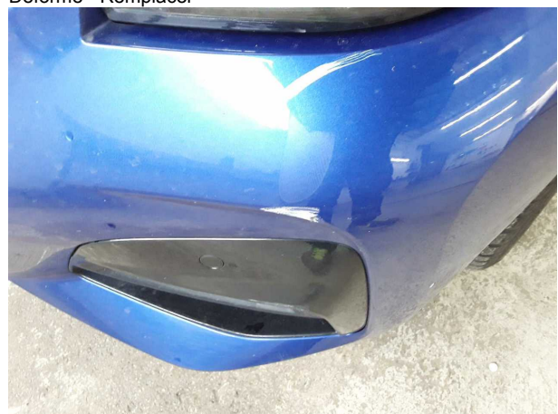
Domage #13: Pare-chocs avant: Pare-chocs avant - Déformé - Remplacer
