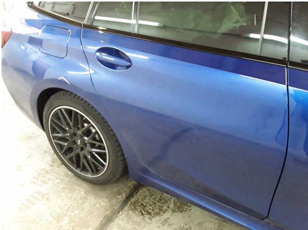
Domage #10: Porte ArD: Porte - Eraflé - Réparer et repeindre
