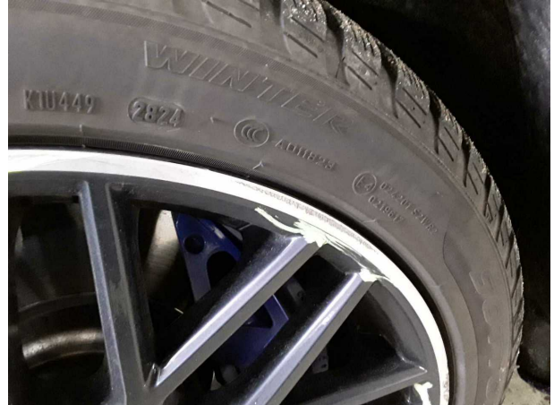
Dommage #1: Roue / Pneumatiques: Jante alliage avant gauche - Erafilé - Pas de moins-value
