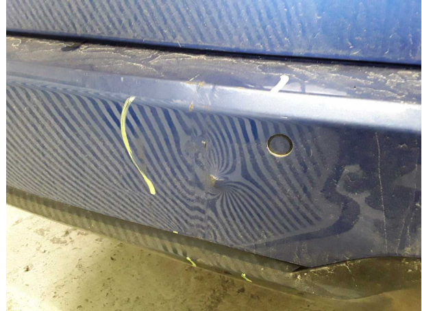
Domage #12: Pare-chocs arrière: Pare-chocs arrière - Déformé - Remplacer
