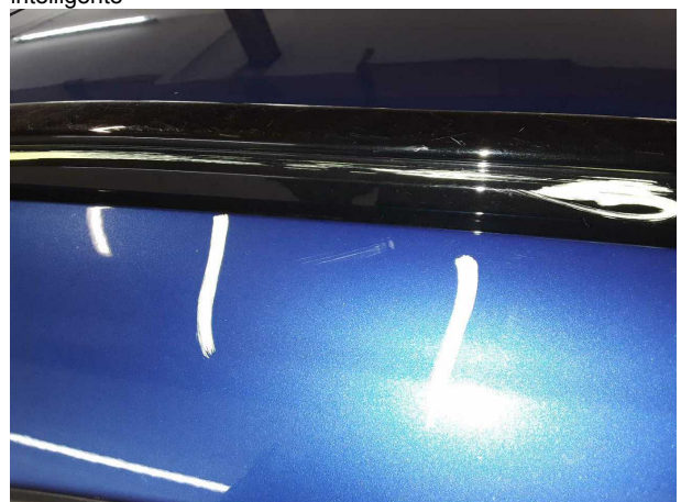
Domage #5: Toit: Rail de toit droit - Erafilé - Réparation intelligente
