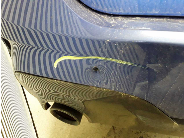
Domage #12: Pare-chocs arrière: Pare-chocs arrière - Déformé - Remplacer
