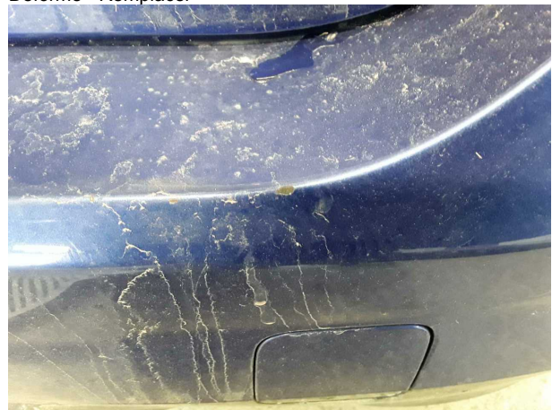
Domage #12: Pare-chocs arrière: Pare-chocs arrière - Déformé - Remplacer
