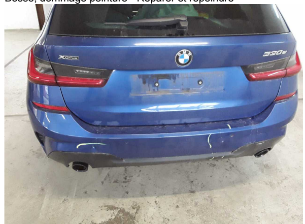
Domage #12: Pare-chocs arrière: Pare-chocs arrière - Déformé - Remplacer
