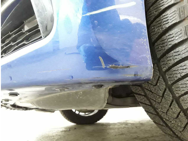
Domage #13: Pare-chocs avant: Pare-chocs avant - Déformé - Remplacer
