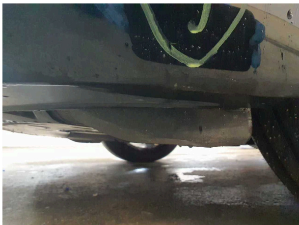
Domage #3: Pare-chocs avant: Pare-chocs avant - Erafilé - Réparer et repeindre
