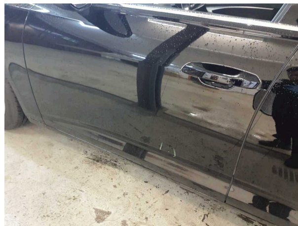
Domage #4: Porte AvG: Porte - Bosse, dommage peinture - Réparer et repeindre
