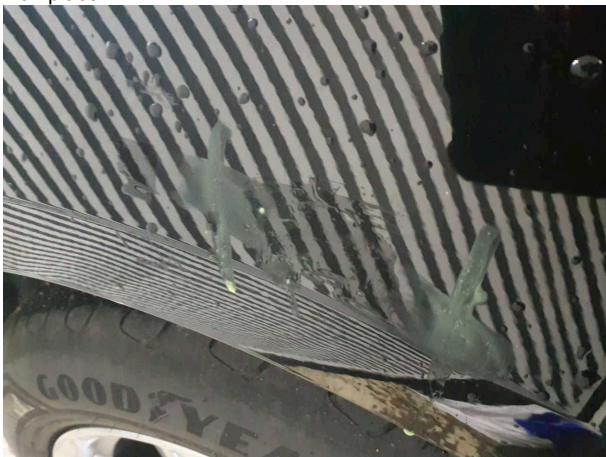
Domage #2: Panneau latéral arrière droit: Paroi latérale - Eraflé - Peinture
