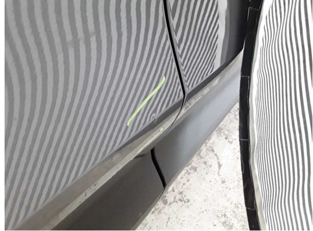
Beschädigung #8: Tür hinten rechts: Tür - Delle(n) - instandsetzen und lackieren
