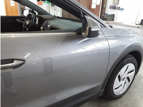
Beschädigung #2: Tür vorn rechts: Tür - Kratzer - auslegen / polieren
