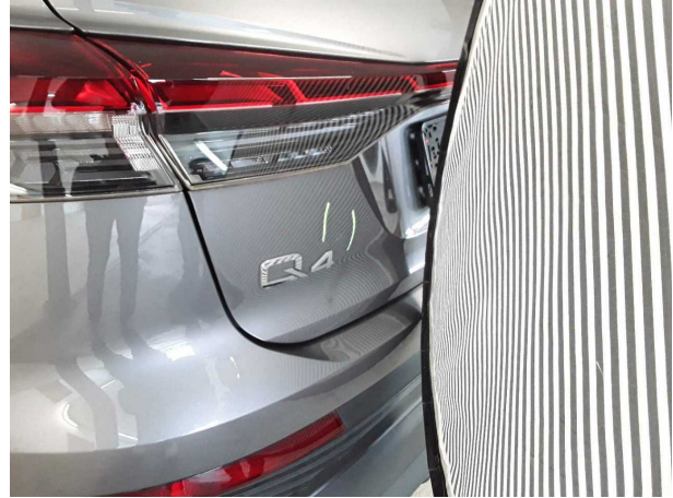
Beschädigung #5: Heckklappe/-tür: Heckklappe - Delle(n) - sanft instandsetzen
