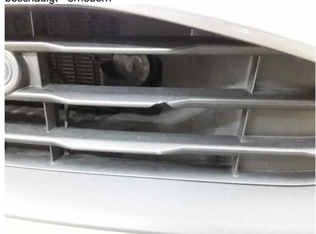
Beschädigung #7: Stossfänger vorn: Lufteinlassgitter - beschädigt - erneuern
