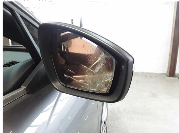
Beschädigung #6: Außenspiegel rechts: Spiegelglas - beschädigt - erneuern
