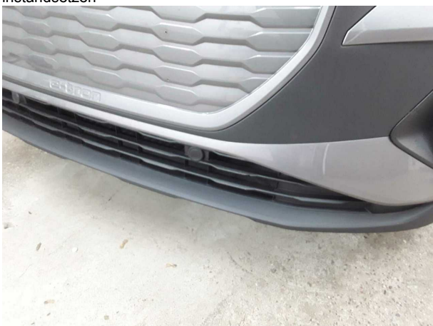
Beschädigung #7: Stossfänger vorn: Lufteinlassgitter - beschädigt - erneuern
