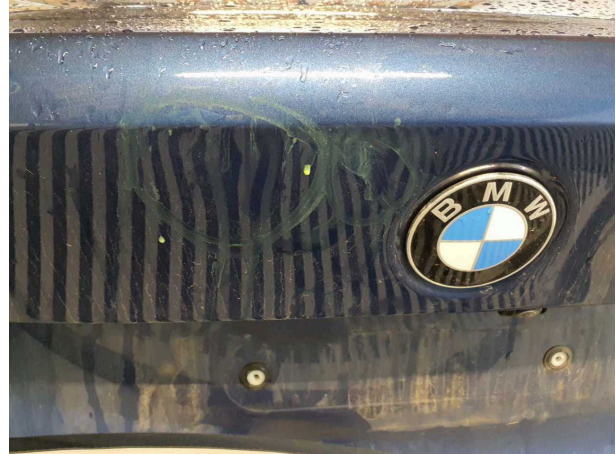
Beschädigung #4: Heckklappe/-tür: Heckklappe - Delle(n) - sanft instandsetzen
