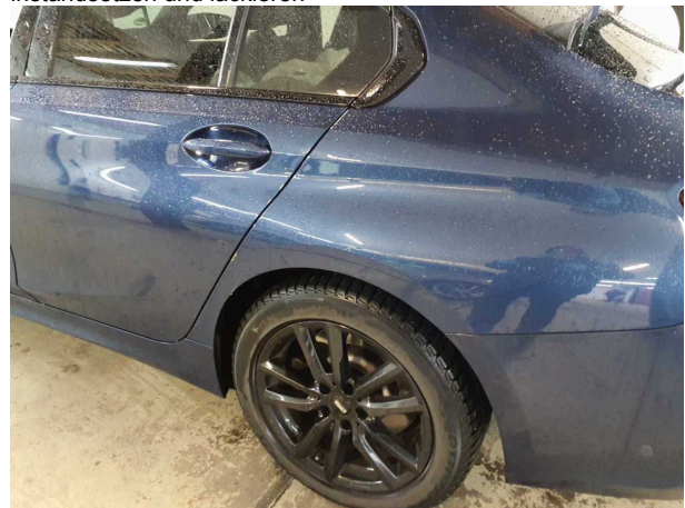
Beschädigung #8: Seitenwand links: Seitenwand - verkratzt / verschürft - instandsetzen und lackieren
