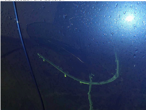
Beschädigung #7: Tür vorn rechts: Tür - verkratzt / verschürft - instandsetzen und lackieren
