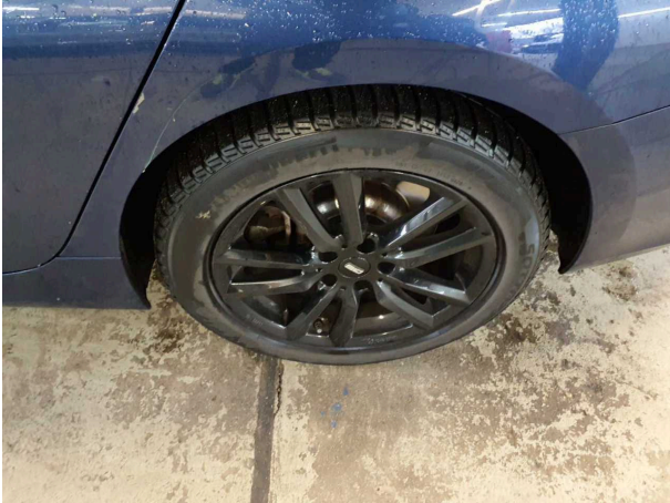
Beschädigung #1: Rad/Reifen: Reifen hinten - verschlissen - kein Abzug
