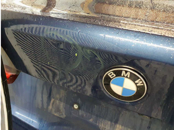
Beschädigung #4: Heckklappe/-tür: Heckklappe - Delle(n) - sanft instandsetzen
