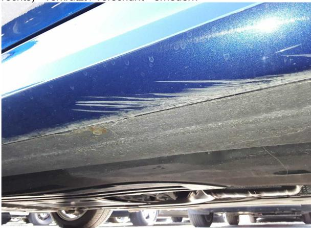
**Beschädigung #4:** Schweller links: Verkleidung - verkratzt / verschürft - instandsetzen und lackieren
