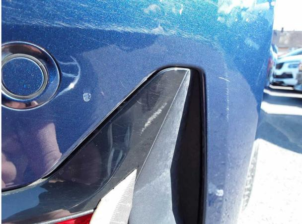
**Beschädigung #3:** Stossfänger hinten: Schutzleiste rechts (hinten rechts) - verkratzt / verschürft - erneuern
