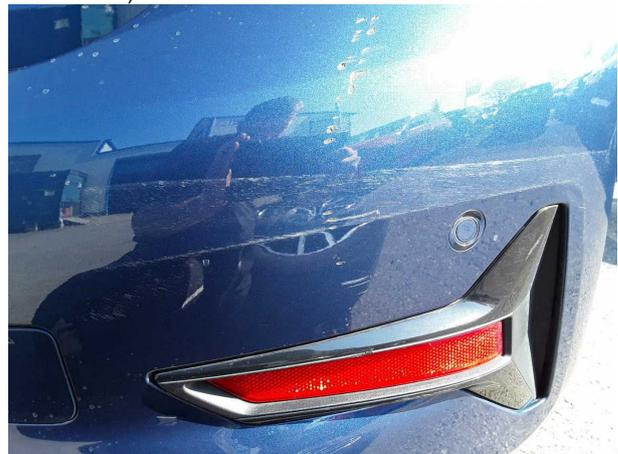
**Beschädigung #6:** Stossfänger hinten: Stossfänger hinten (+ Druckstellen) - verkratzt / verschürft - instandsetzen und
