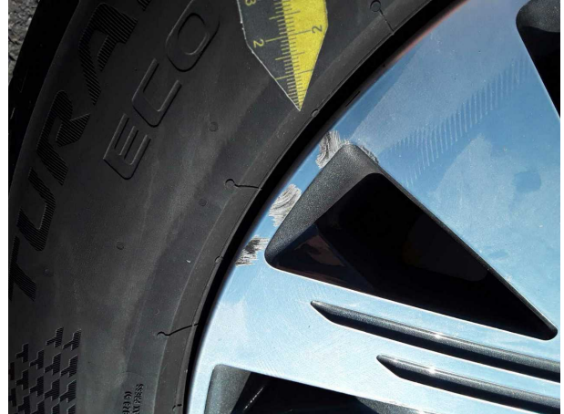
Beschädigung #4: 2.Radsatz: 2 Leichtmetallfelgen - verkratzt / verschürft - Wertminderung
