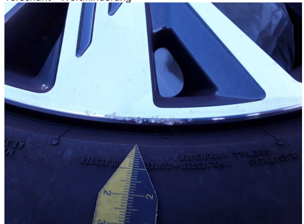
Beschädigung #4: 2.Radsatz: 2 Leichtmetallfelgen - verkratzt / verschürft - Wertminderung
