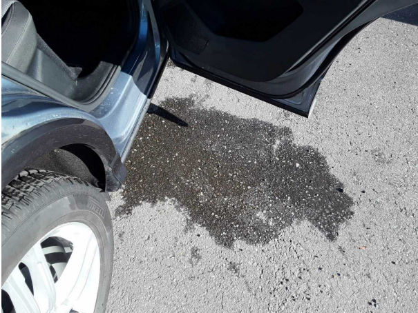
Beschädigung #1: Karosserie: Türdichtung hinten rechts (Wasser sammelt sich in der Tür) - undicht - befunden ggf. instandsetzen
