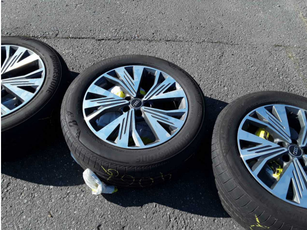
Beschädigung #4: 2.Radsatz: 2 Leichtmetallfelgen - verkratzt / verschürft - Wertminderung
