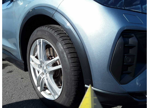
Beschädigung #2: Kotflügel rechts: Radhausverbreiterung - verkratzt / verschürft - Smart Repair
