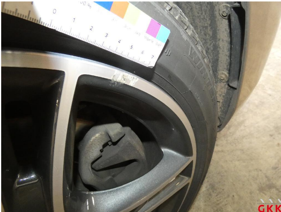
Bild 21. LM-Rad, vorne rechts, Materialabtrag, ersetzen
