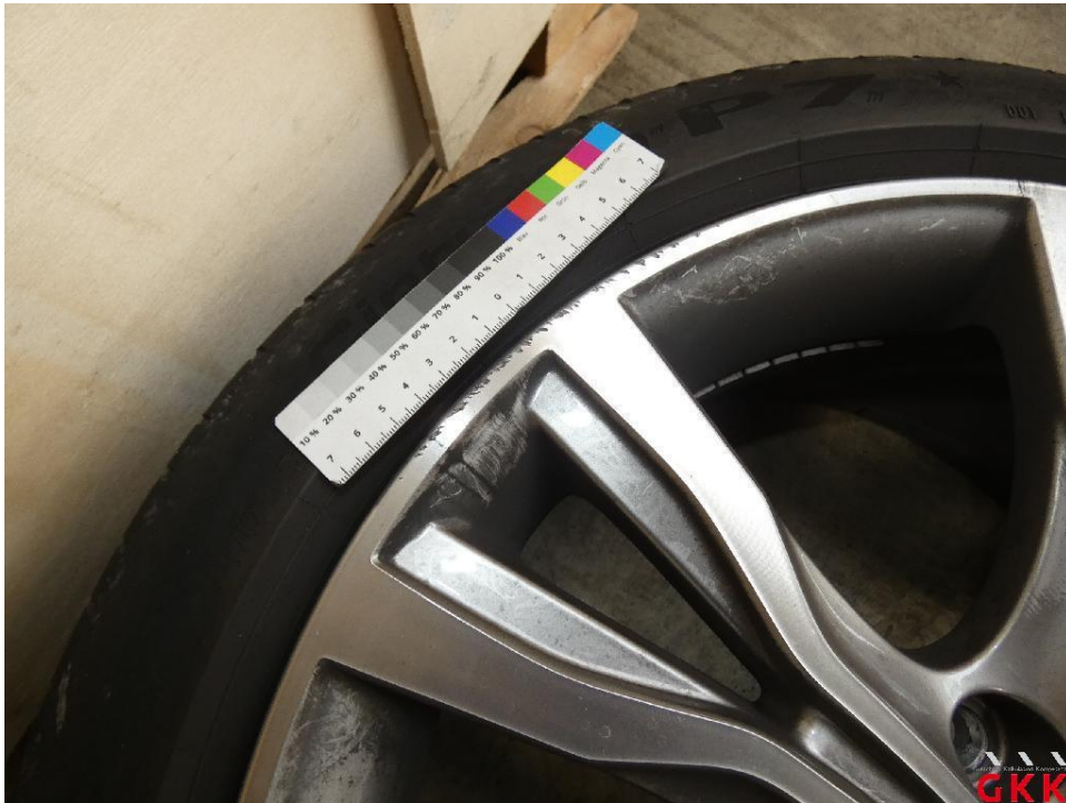
Bild 24. LM-Rad, 3 x beiliegend, beschädigt, ersetzen
