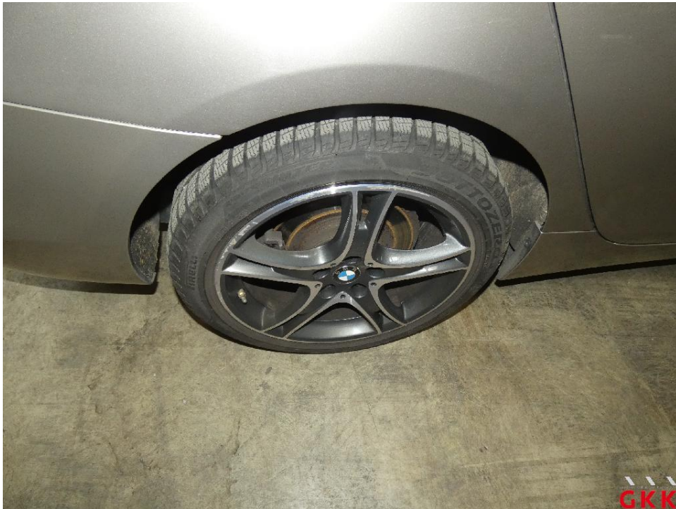
Bild 18. LM-Rad, hinten rechts, Materialabtrag, ersetzen
