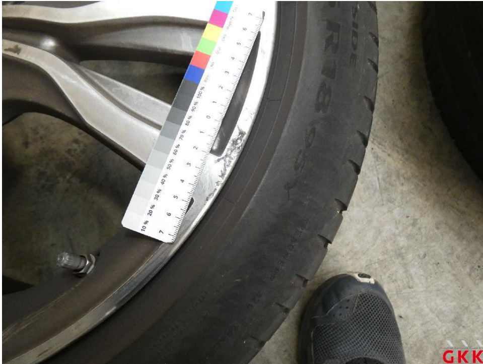
Bild 23. LM-Rad, 3 x beiliegend, beschädigt, ersetzen
