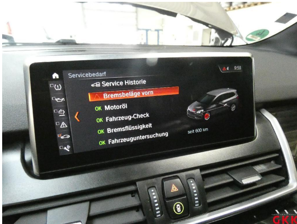
Bild 14. Bremsbeläge vorne, Servicehinweis, prüfen
