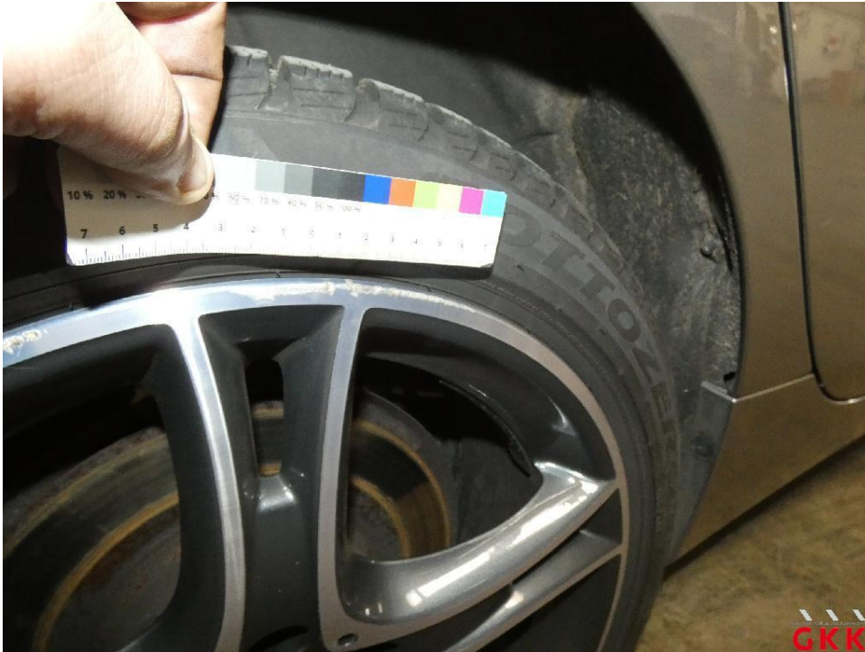
Bild 19. LM-Rad, hinten rechts, Materialabtrag, ersetzen
