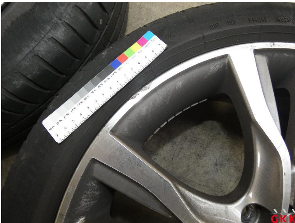
Bild 22. LM-Rad, 3 x beiliegend, beschädigt, ersetzen
