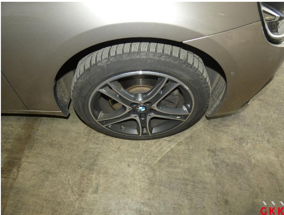
Bild 20. LM-Rad, vorne rechts, Materialabtrag, ersetzen
