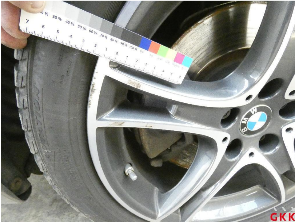
Bild 17. LM-Rad, vorne links, Materialabtrag, ersetzen
