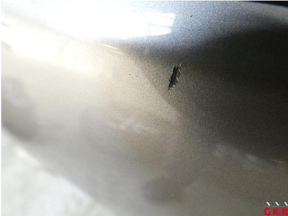
Bild 31. Stoßfänger hinten, Verkleidung -lackiert-, verkratzt, lackieren
