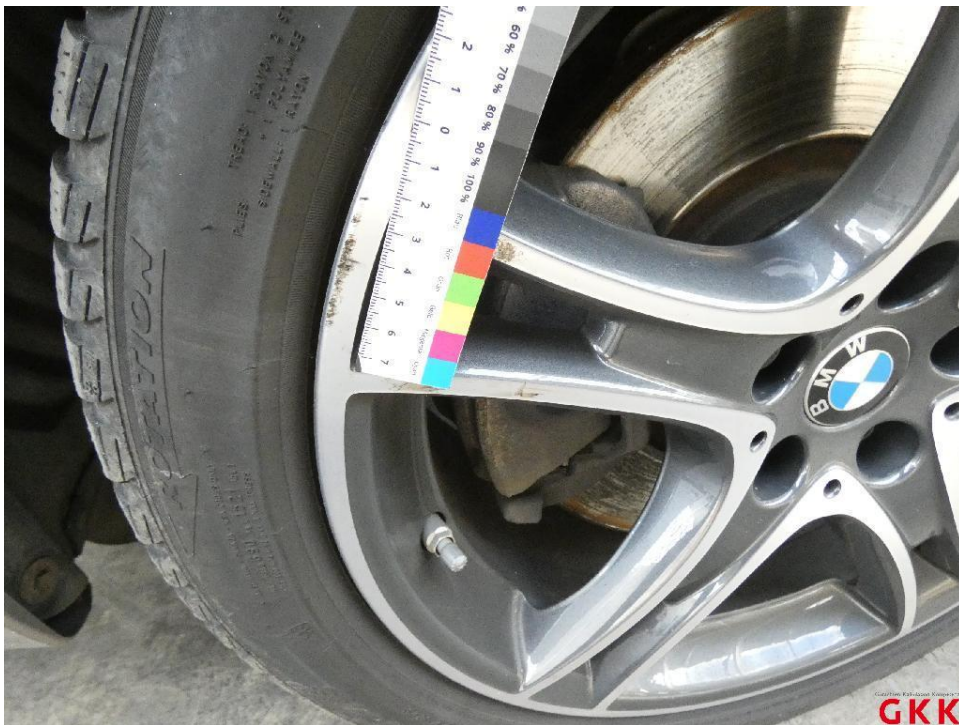
Bild 16. LM-Rad, vorne links, Materialabtrag, ersetzen
