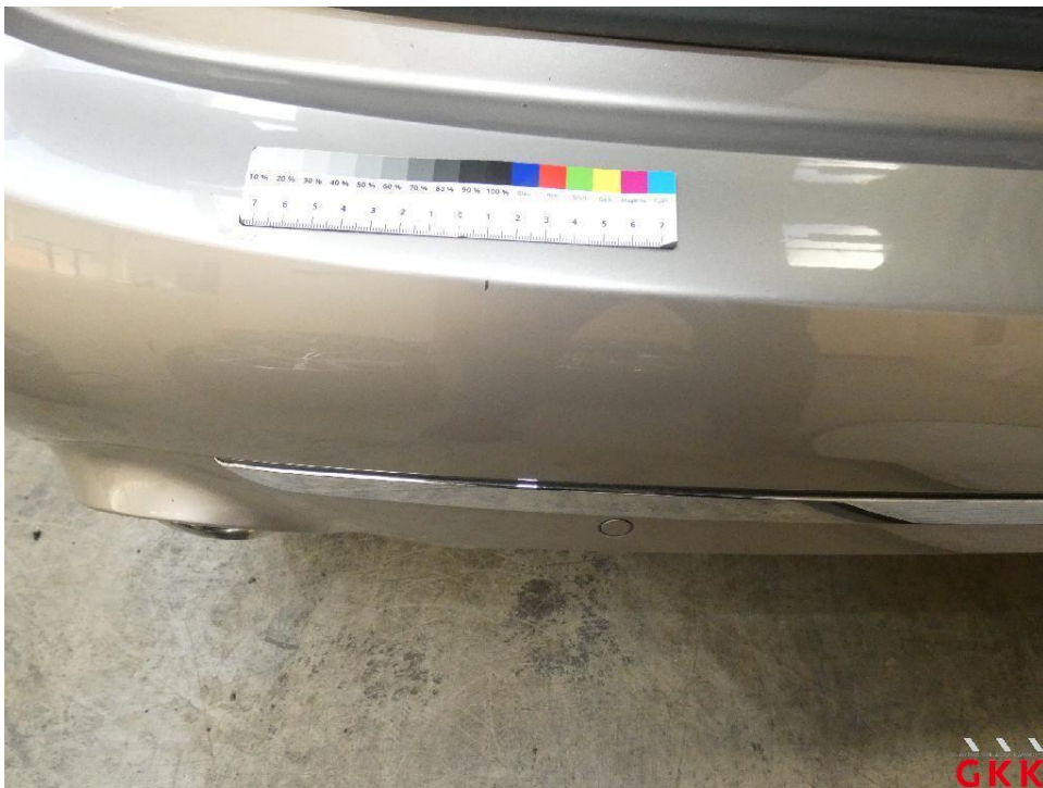
Bild 30. Stoßfänger hinten, Verkleidung -lackiert-, verkratzt, lackieren
