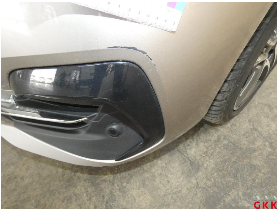
Bild 28. Stoßfänger vorne, Verkleidung -lackiert-, verkratzt, lackieren
