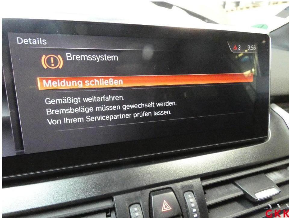
Bild 13. Bremsbeläge vorne, Servicehinweis, prüfen
