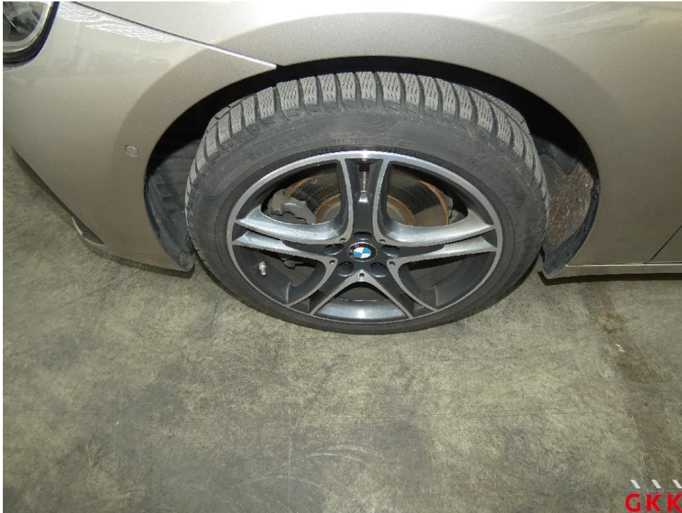
Bild 15. LM-Rad, vorne links, Materialabtrag, ersetzen
