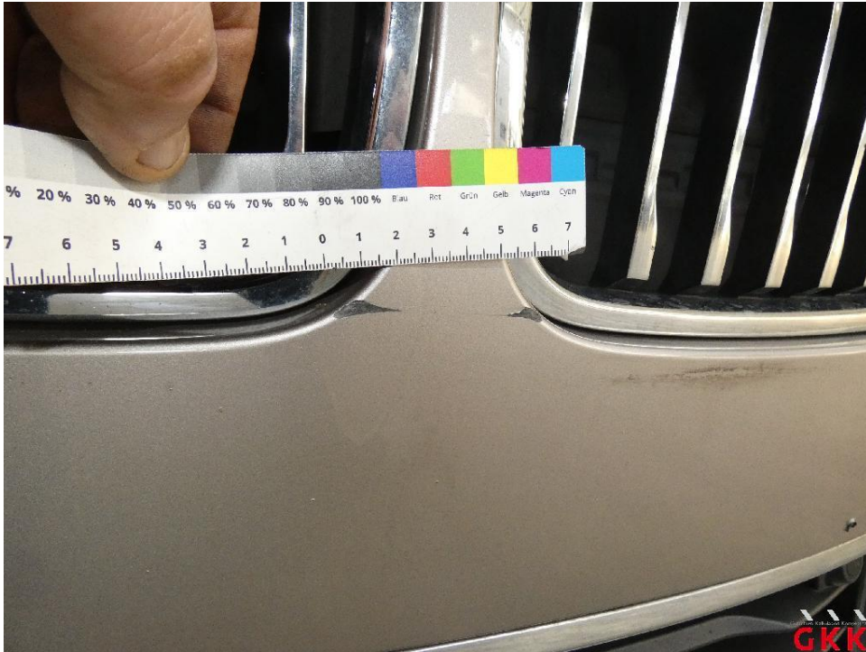
Bild 29. Stoßfänger vorne, Verkleidung -lackiert-, verkratzt, lackieren
