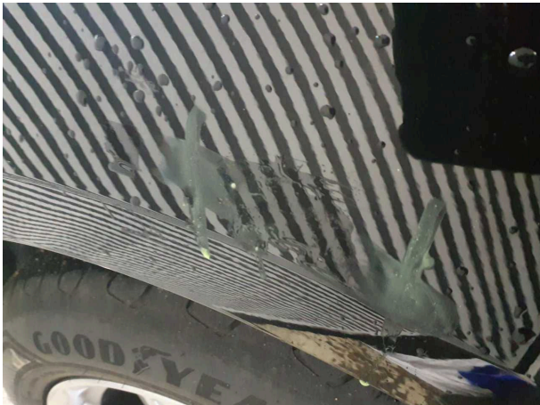
Beschädigung #2: Seitenwand rechts: Seitenwand - verkratzt / verschürft - lackieren
