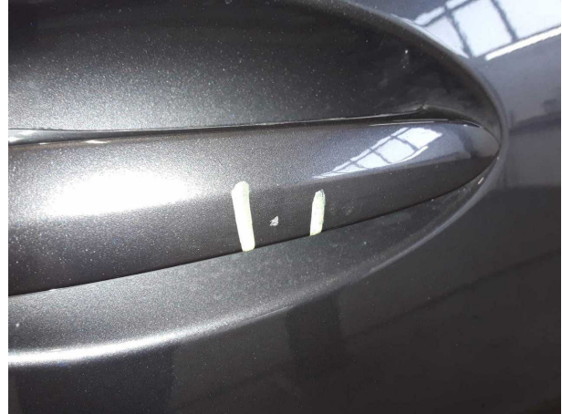
Dommage #1: Porte AvD: Poignée de porte extérieure - Rayure(s) - Revêtement/polissage
