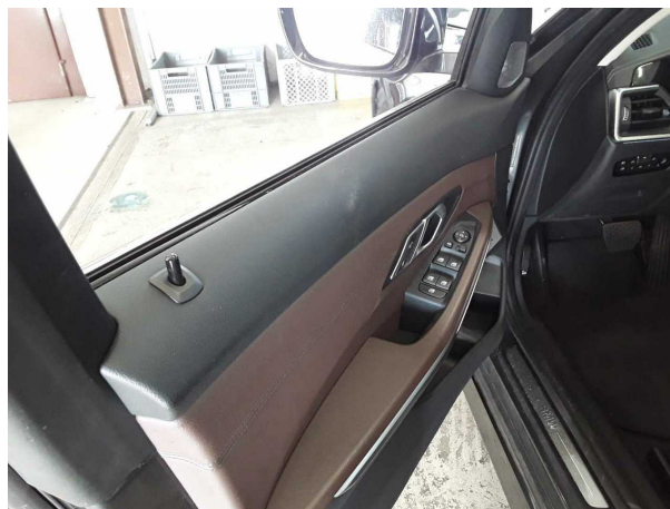
Domage #4: Habillages/Protections: Habillage porte avant gauche - bosse(s) - Remplacer
