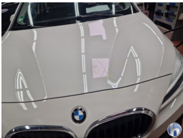
2. Motorhaube Steinschlag - Lackieren
