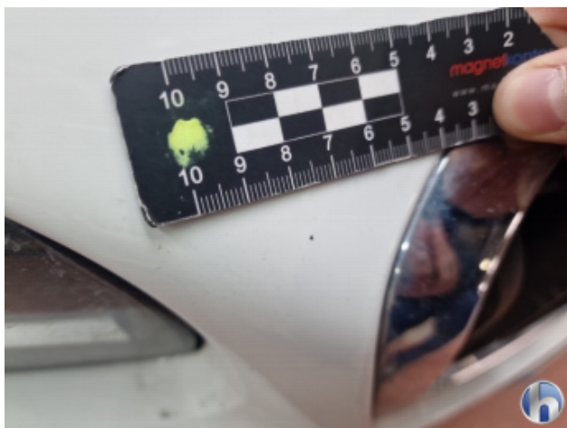
3. Stoßfänger Vorne Gebrauchsspuren - Ohne Reparatur
