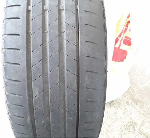
**Beschädigung #6:** Vermessung: Fahrwerk - abgelaufen - durchführen
