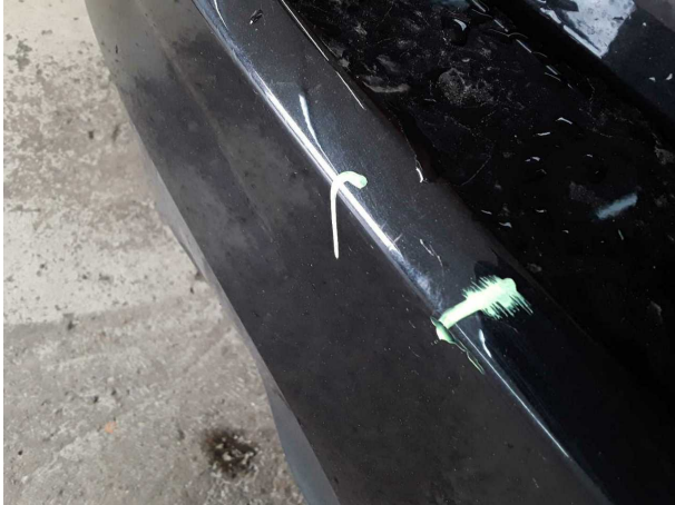
Beschädigung #9: Stossfänger hinten: Stossfänger hinten - verkratzt / verschürft - Smart Repair
