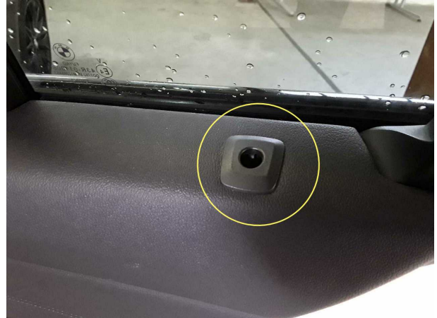
Beschädigung #7: Verkleidungen/Abdeckungen: Verkleidungen/Abdeckungen (Stift Fehlt Tür hi re.) - de-/
