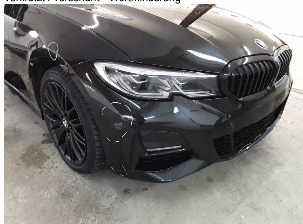
Beschädigung #11: Stossfänger vorn: Stossfänger vorn - verkratzt / verschürft - instandsetzen und lackieren
