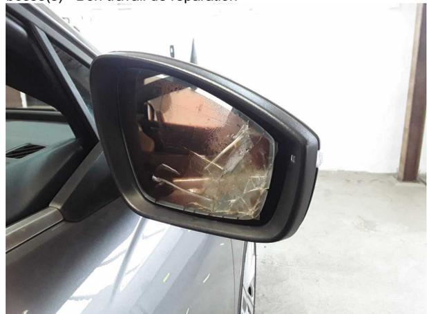
**Domage #6:** Rétroviseur droit: Verre de rétroviseur - Dommages - Remplacer
