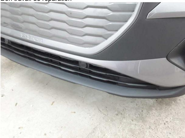
**Domage #7:** Pare-chocs avant: Grille d'admission d'air - Dommages - Remplacer
