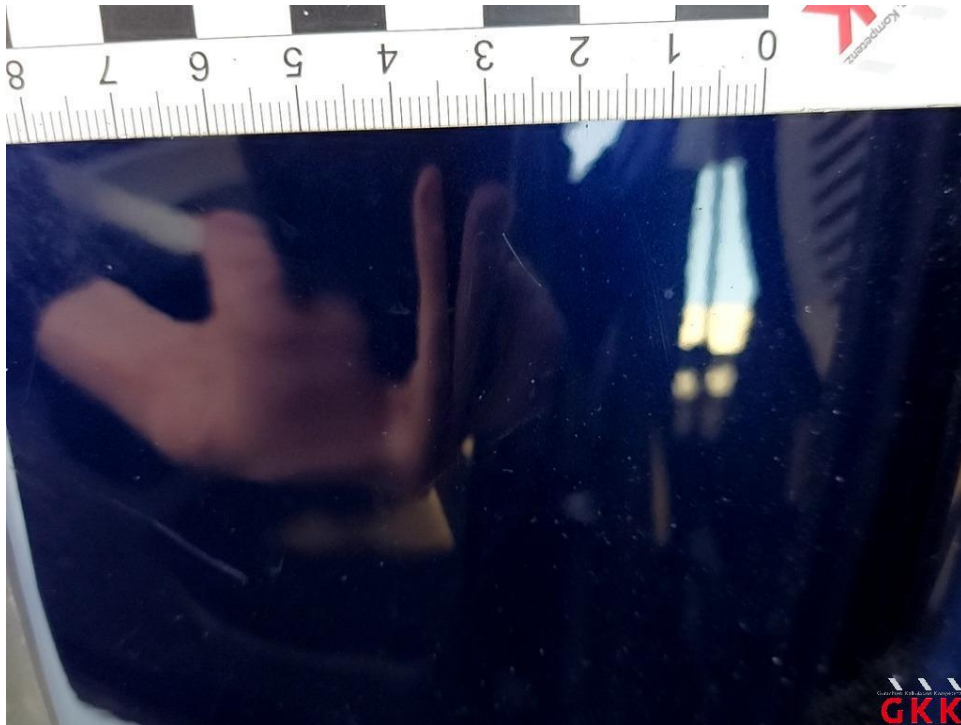
Bild 23. Tür hinten rechts, Einstieg, verkratzt, Smartrepair
