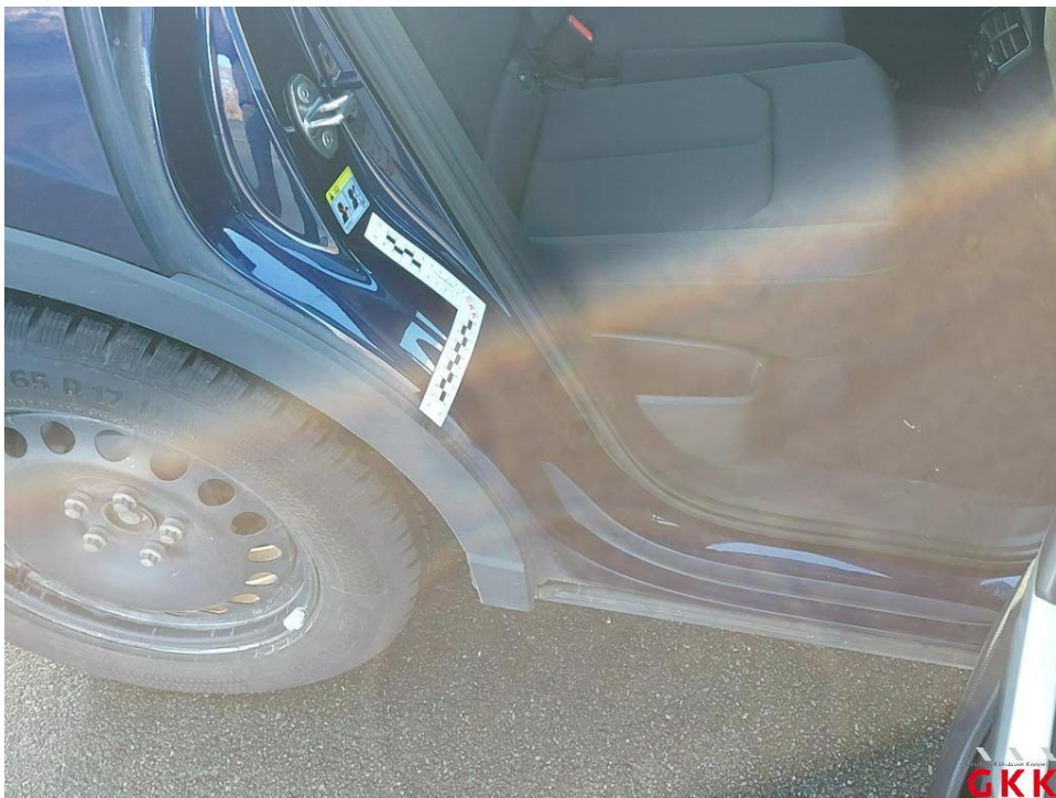
Bild 22. Tür hinten rechts, Einstieg, verkratzt, Smartrepair
