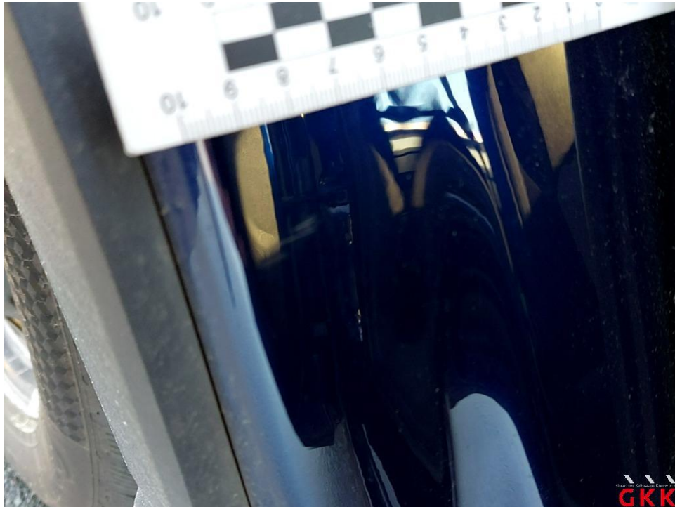
Bild 24. Tür hinten rechts, Einstieg, verkratzt, Smartrepair
