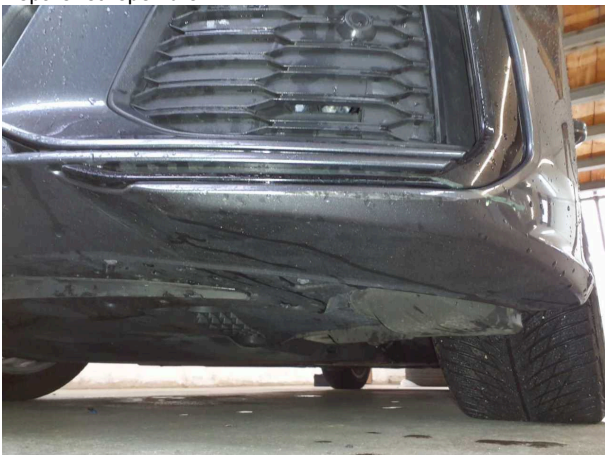
Domage #3: Pare-chocs avant: Pare-chocs avant - Eraflé - Réparer et repeindre
