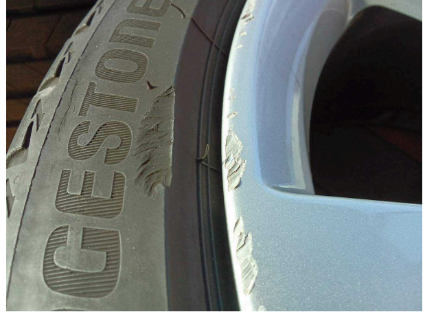
Beschädigung #3: 2.Radsatz: 2 Reifen - gebrochen / gerissen - erneuern
