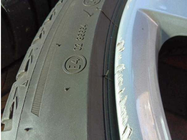
Beschädigung #5: 2.Radsatz: 2 Leichtmetallfelgen (Materialabri... - verkratzt / verschürft - erneuern
