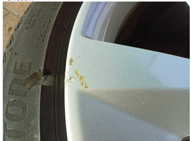
Beschädigung #3: 2.Radsatz: 2 Reifen - gebrochen / gerissen - erneuern
