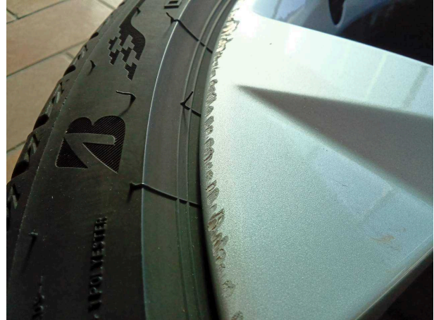
Beschädigung #5: 2.Radsatz: 2 Leichtmetallfelgen (Materialabrieb) - verkratzt / verschürft - erneuern
