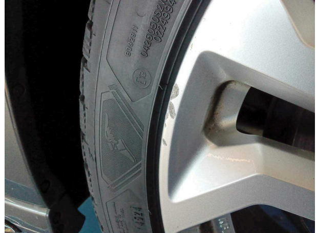
Beschädigung #1: Rad/Reifen: Leichtmetallfelge vorn rechts - verkratzt / verschürft - Smart Repair
