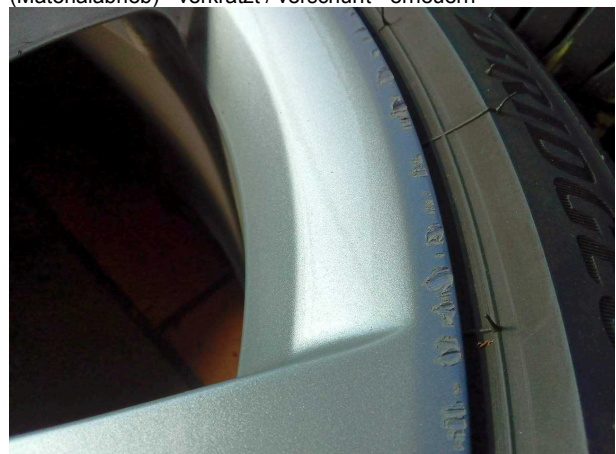
Beschädigung #5: 2.Radsatz: 2 Leichtmetallfelgen (Materialabrieb) - verkratzt / verschürft - erneuern
