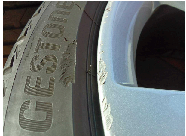
Beschädigung #5: 2.Radsatz: 2 Leichtmetallfelgen (Materialabrieb) - verkratzt / verschürft - erneuern
