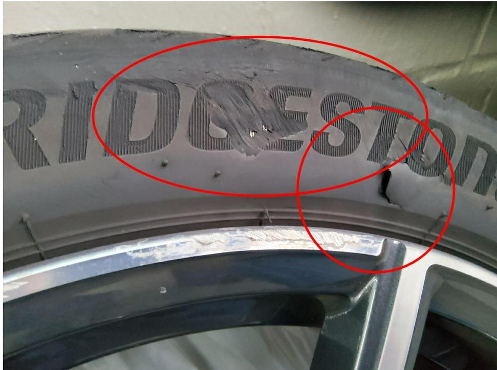
Bild 29 : 1 Sommerreifen beschädigt
