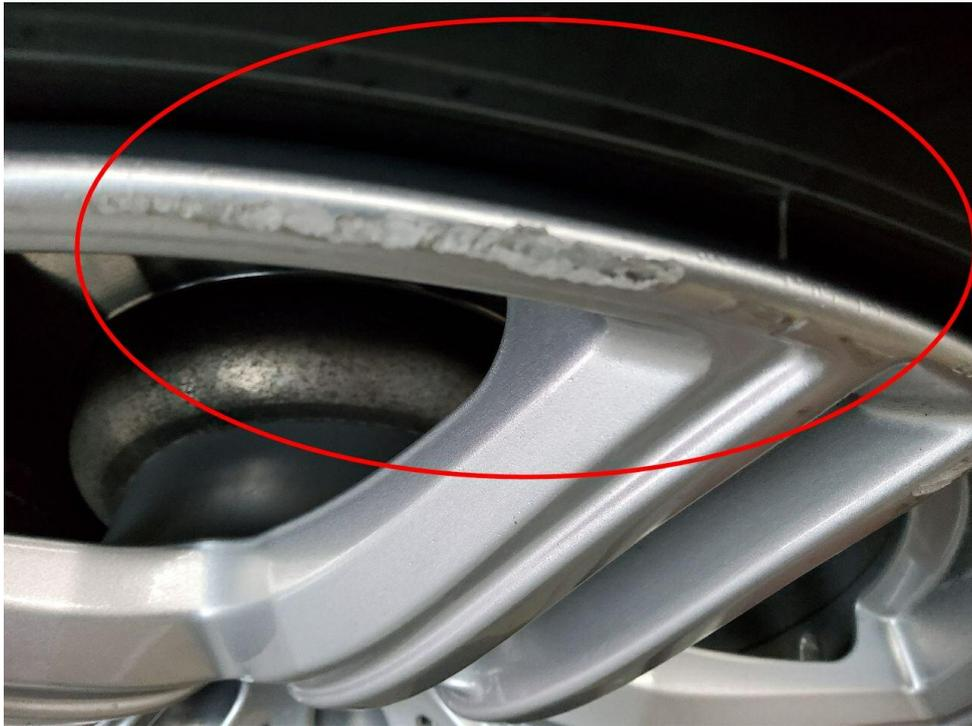
Bild 23 : Alle 4 Winteralufelgen beschädigt
