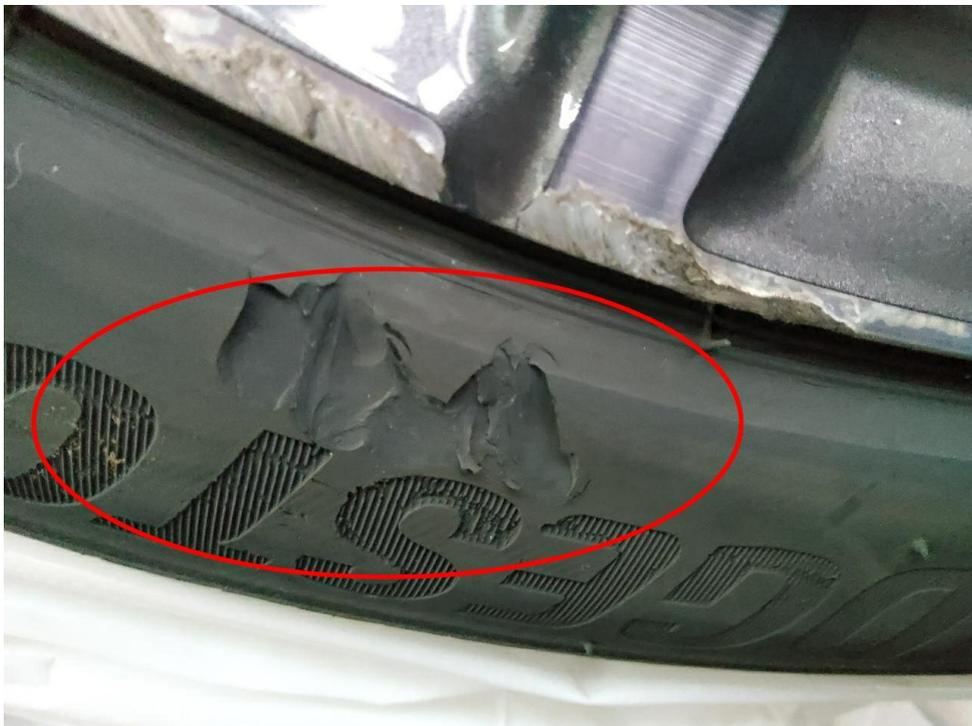
Bild 28 : 1 Sommerreifen beschädigt
