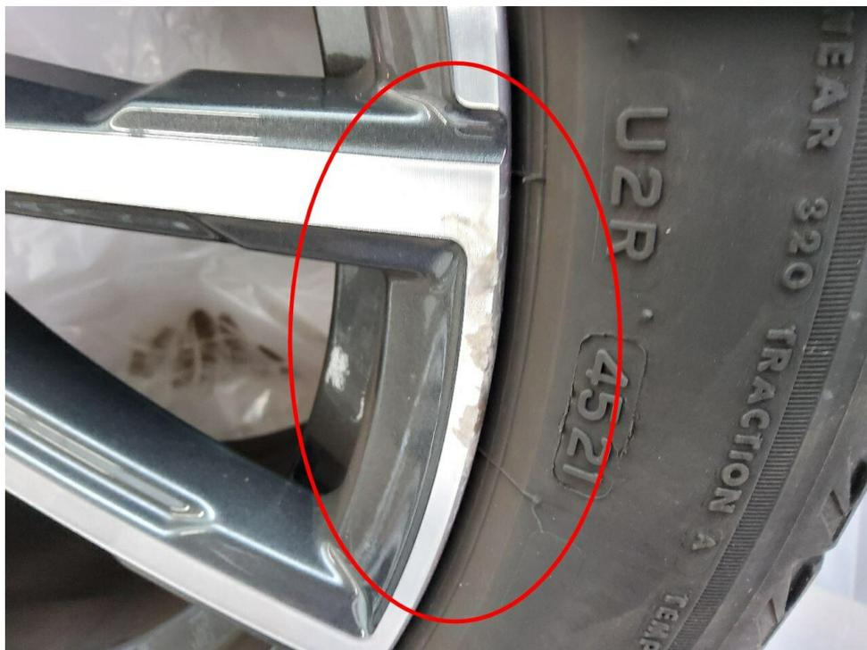
Bild 26 : 2 Sommalufelgen beschädigt ( Glanzgedreht )
