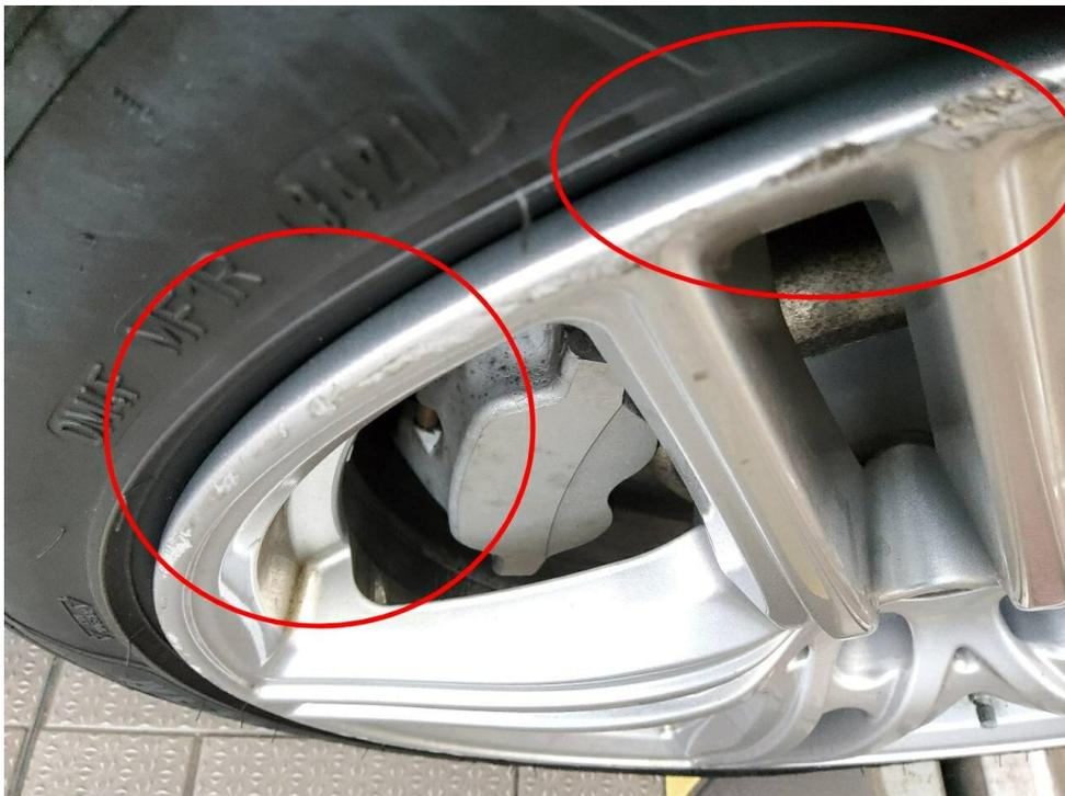
Bild 24 : Alle 4 Winteralufelgen beschädigt
