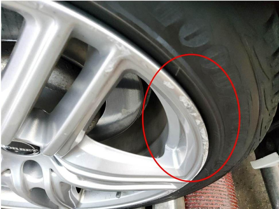
Bild 21 : Alle 4 Winteralufelgen beschädigt
