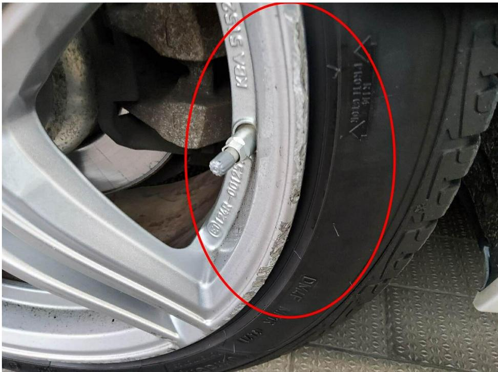
Bild 22 : Alle 4 Winteralufelgen beschädigt
