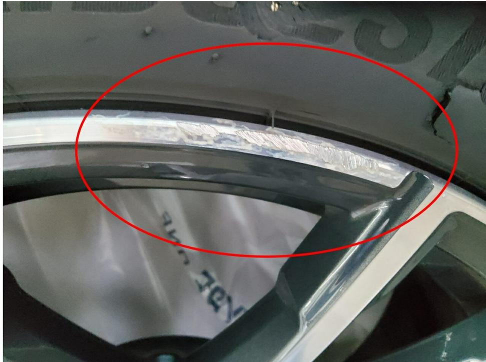
Bild 25 : 2 Sommalufelgen beschädigt ( Glanzgedreht )
