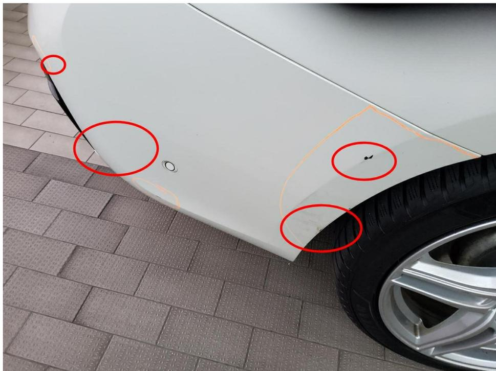
Bild 17 : Stoßfänger hinten Lackierung, verschrammt, lackieren mit Lackaufbau
