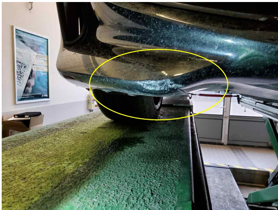
Bild 13 : Stoßfänger vorn rechts verschrammt und bleibend verformt
