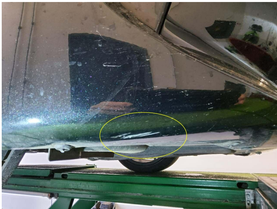
Bild 14 : Frontspoiler rechts unten zerkratzt
