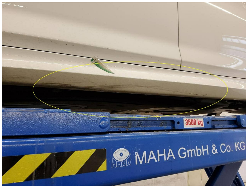
Bild 15 : Seitenschweller links Lackierung, zerkratzt, lackieren mit Lackaufbau
