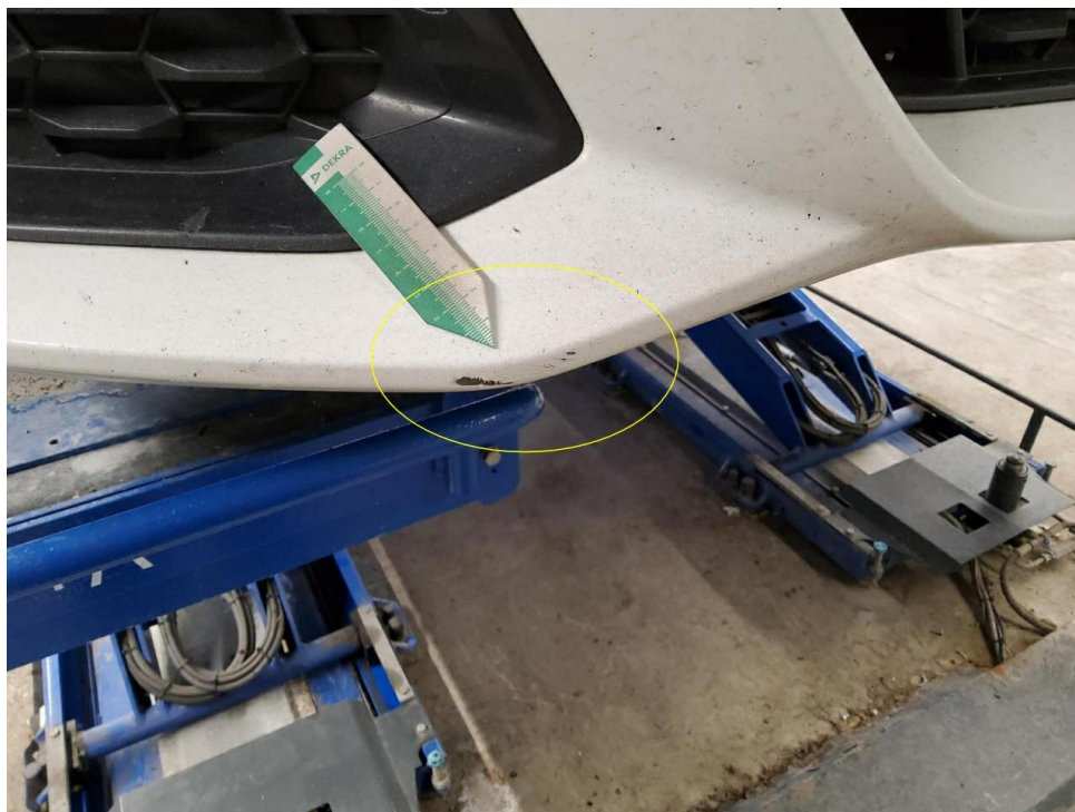
Bild 13 : Stoßfänger vorne Lackierung, zerkratzt, smart repair
