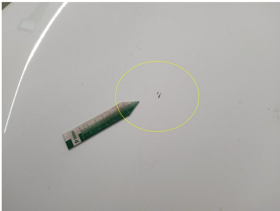
Bild 14 : Motorhaube Lackierung, Steinschlag, lackieren mit Lackaufbau
