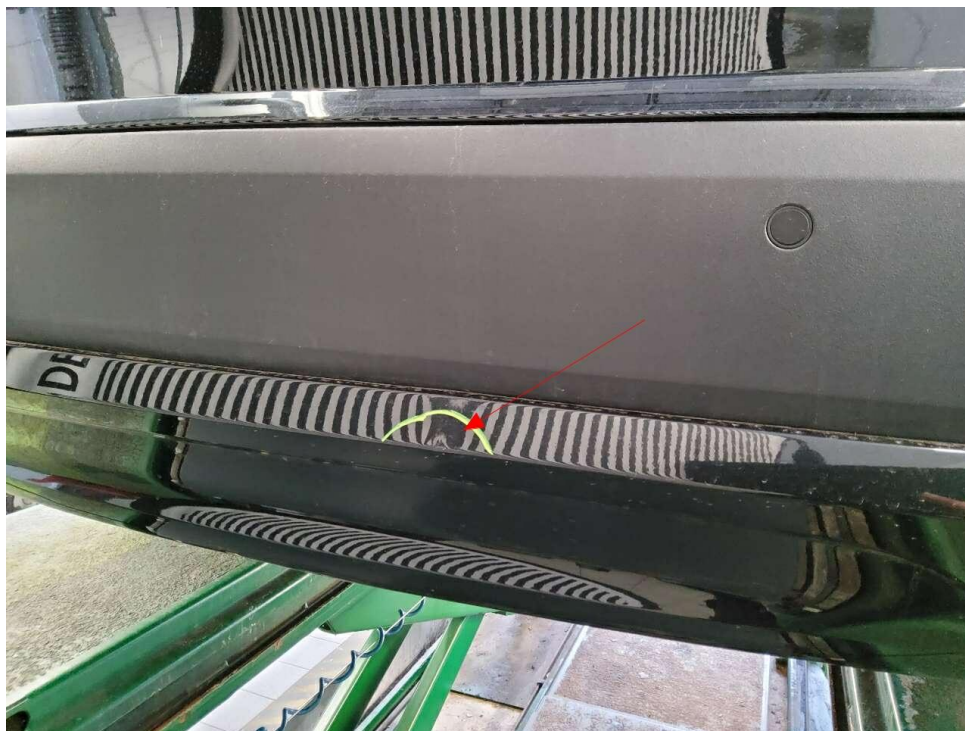
Bild 22 : Heckspoiler plastisch verformt
