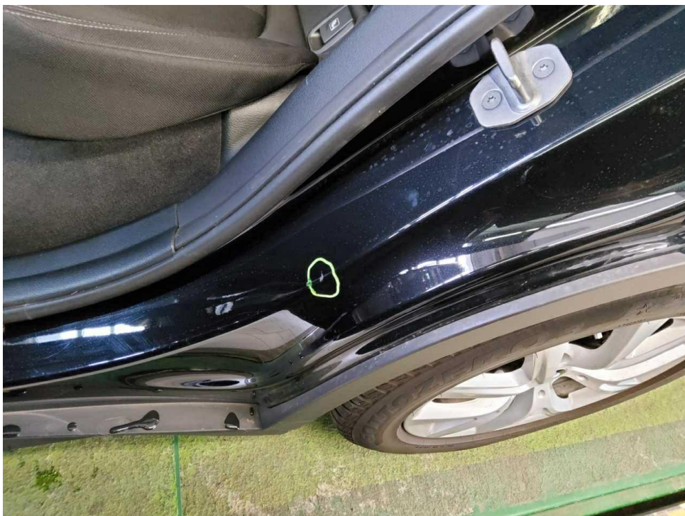
Bild 14 : Seitenteil hinten links Lackierung, zerkratzt, smart repair
