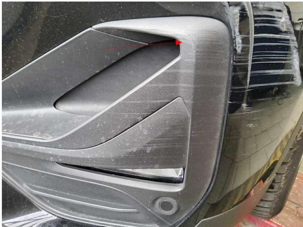
Bild 18 : Stoßfänger vorne gebrochen
