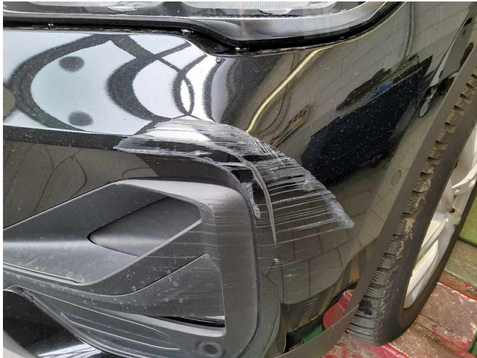
Bild 17 : Stoßfänger vorne gebrochen
