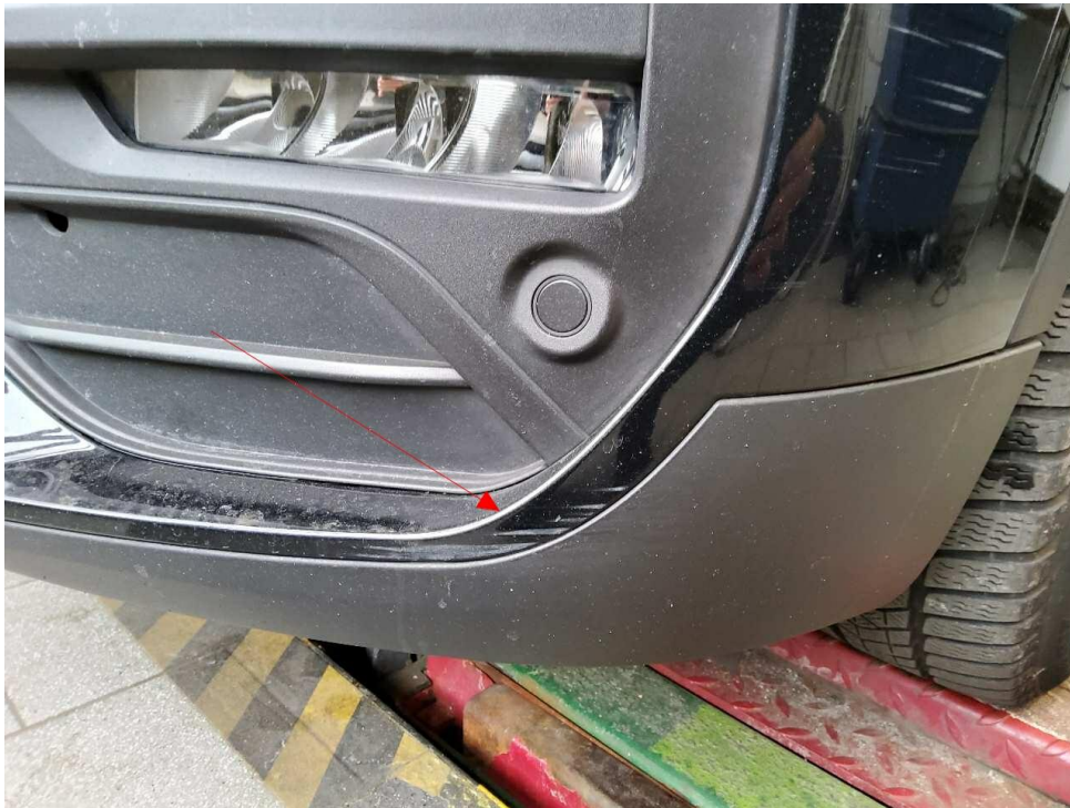
Bild 19 : Stoßfänger vorne gebrochen
