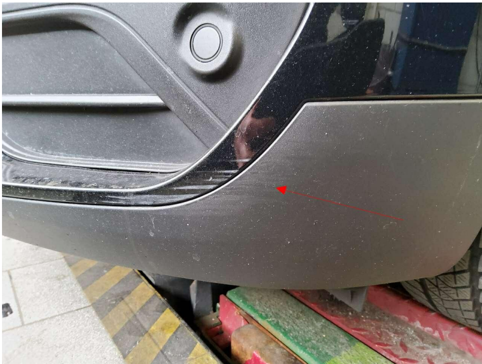
Bild 20 : Stoßfänger vorne gebrochen
