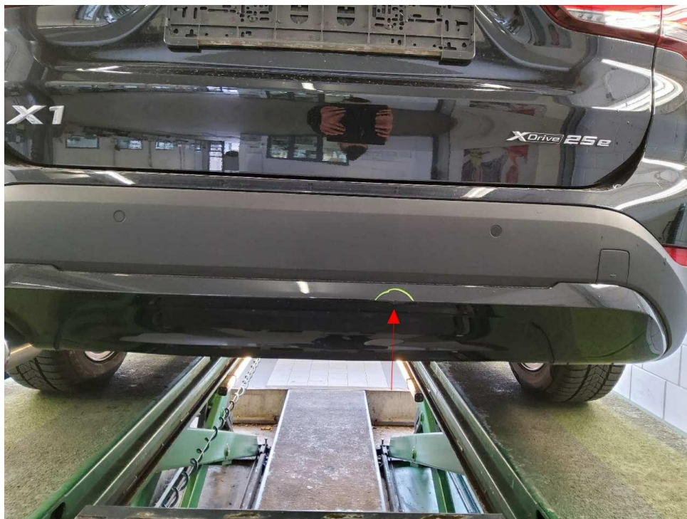
Bild 21 : Heckspoiler plastisch verformt
