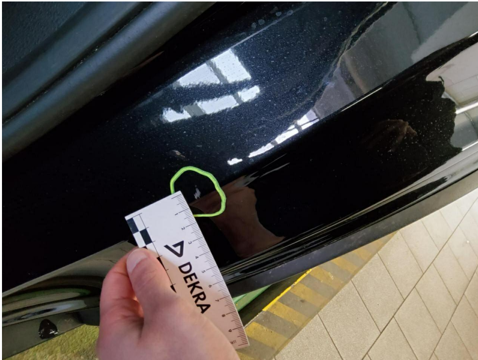
Bild 15 : Seitenteil hinten links Lackierung, zerkratzt, smart repair
