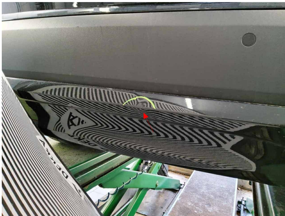
Bild 23 : Heckspoiler plastisch verformt
