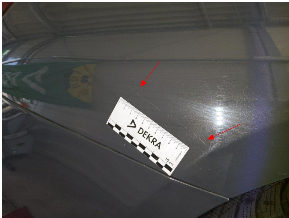
Bild 20 : Seitenteil hinten rechts Lackierung, zerkratzt, lackieren mit Lackaufbau
