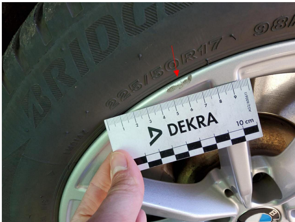
Bild 18 : Felge vorne rechts Lackierung, zerkratzt, smart repair
