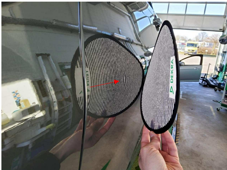
Bild 22 : Tür hinten links, eingedellt, drücken
