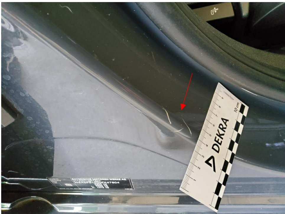
Bild 14 : Tür vorne rechts Einstieg Lackierung, zerkratzt, smart repair
