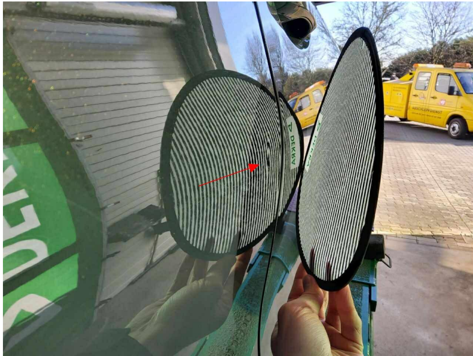
Bild 17 : Tür hinten rechts, eingedellt, drücken
