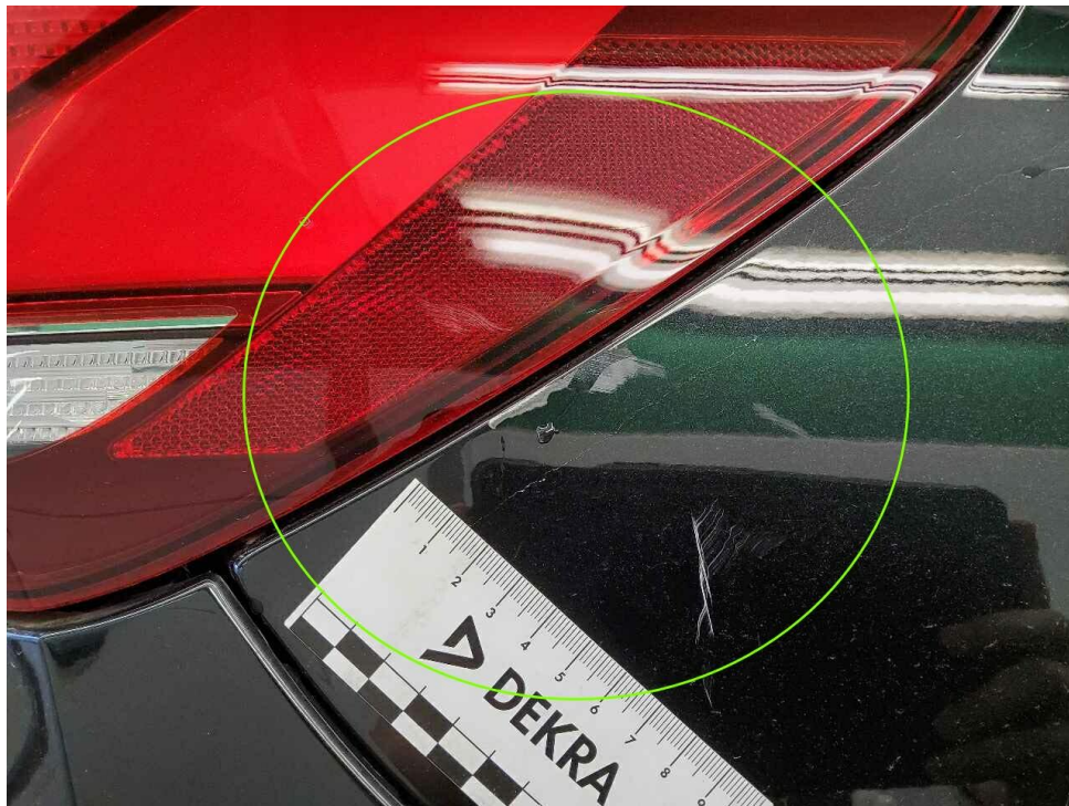
Bild 21 : Anfahrschaden hinten rechts
