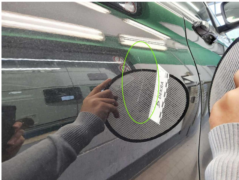
Bild 16 : Tür hinten rechts, eingedellt, drücken
