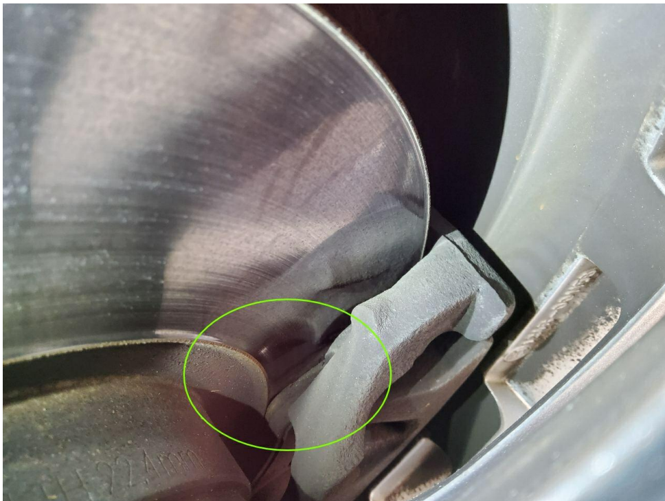
Bild 18 : Bremse Vorderachse Verschleißgränze Augenscheinlich erreicht
