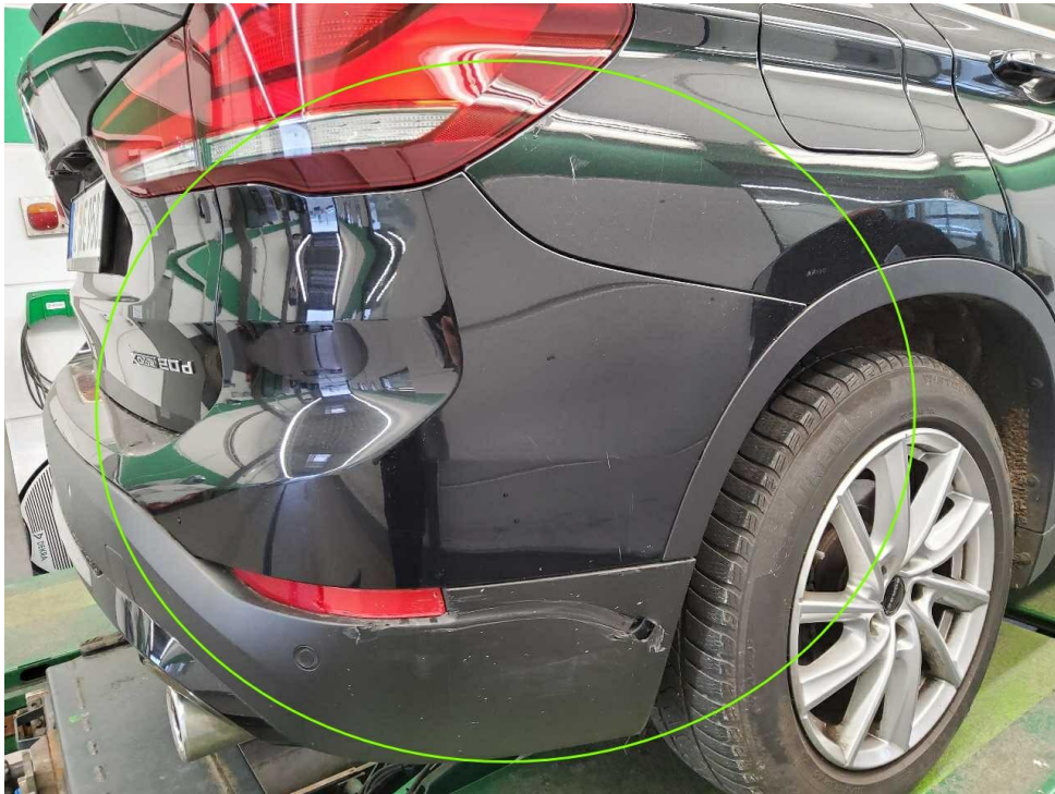
Bild 19 : Anfahrtschaden hinten rechts
