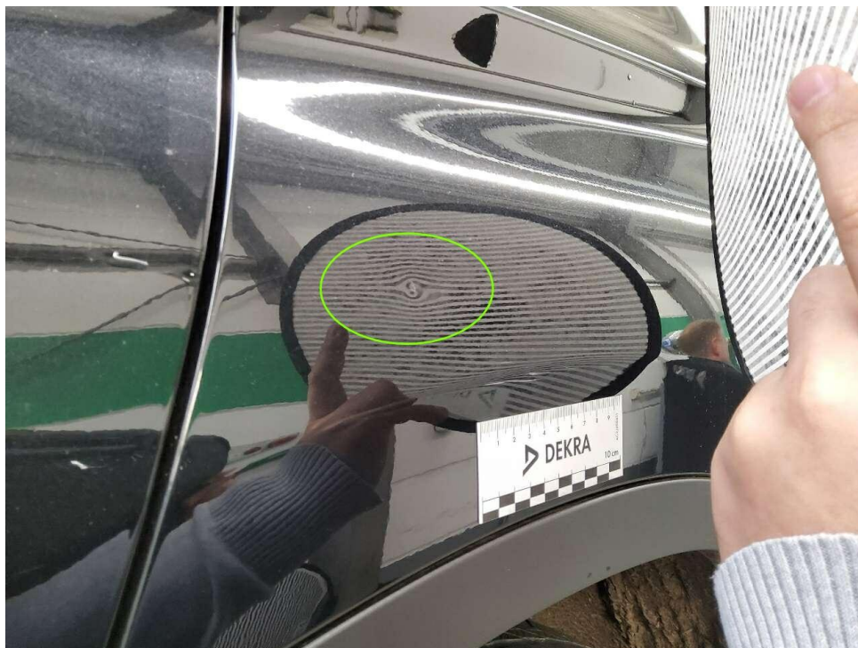
Bild 15 : Seitenteil hinten links, deformiert, instandsetzen und lackieren mit Lackaufbau
