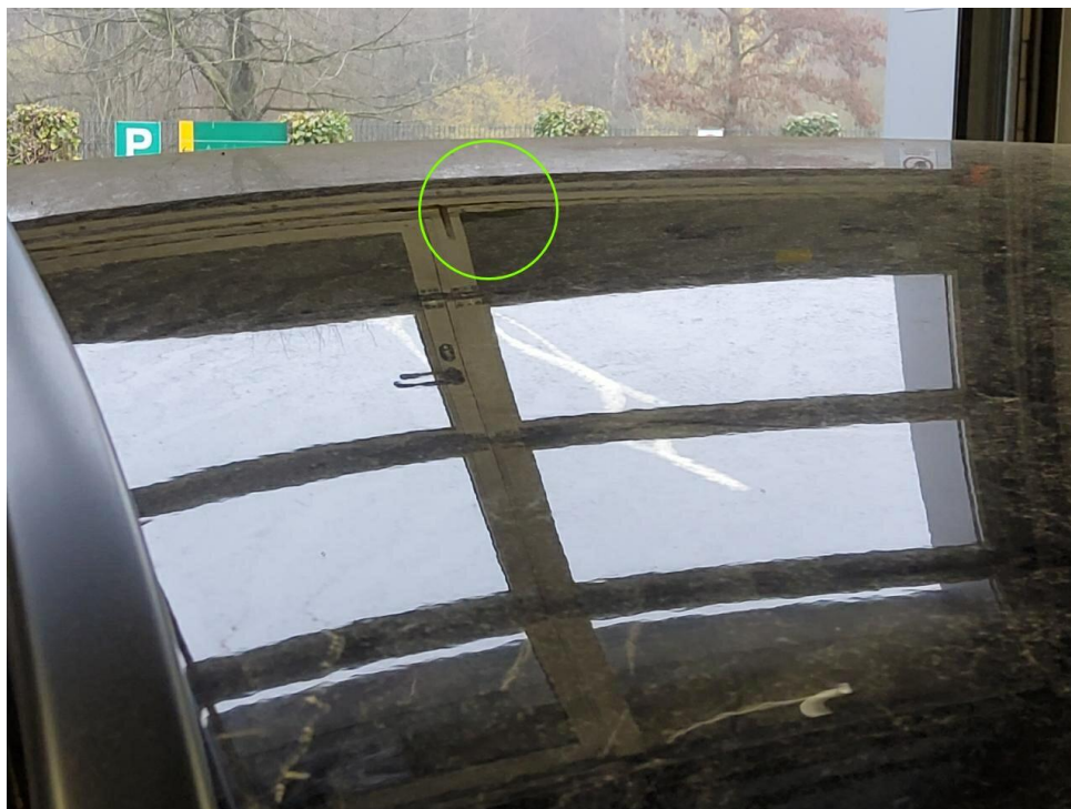
Bild 25 : Dach, eingedellt, drücken
