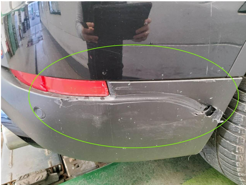
Bild 20 : Anfahrtschaden hinten rechts
