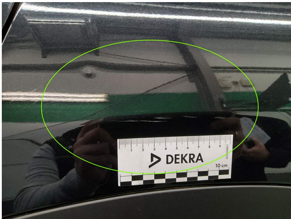
Bild 14 : Seitenteil hinten links, deformiert, instandsetzen und lackieren mit Lackaufbau
