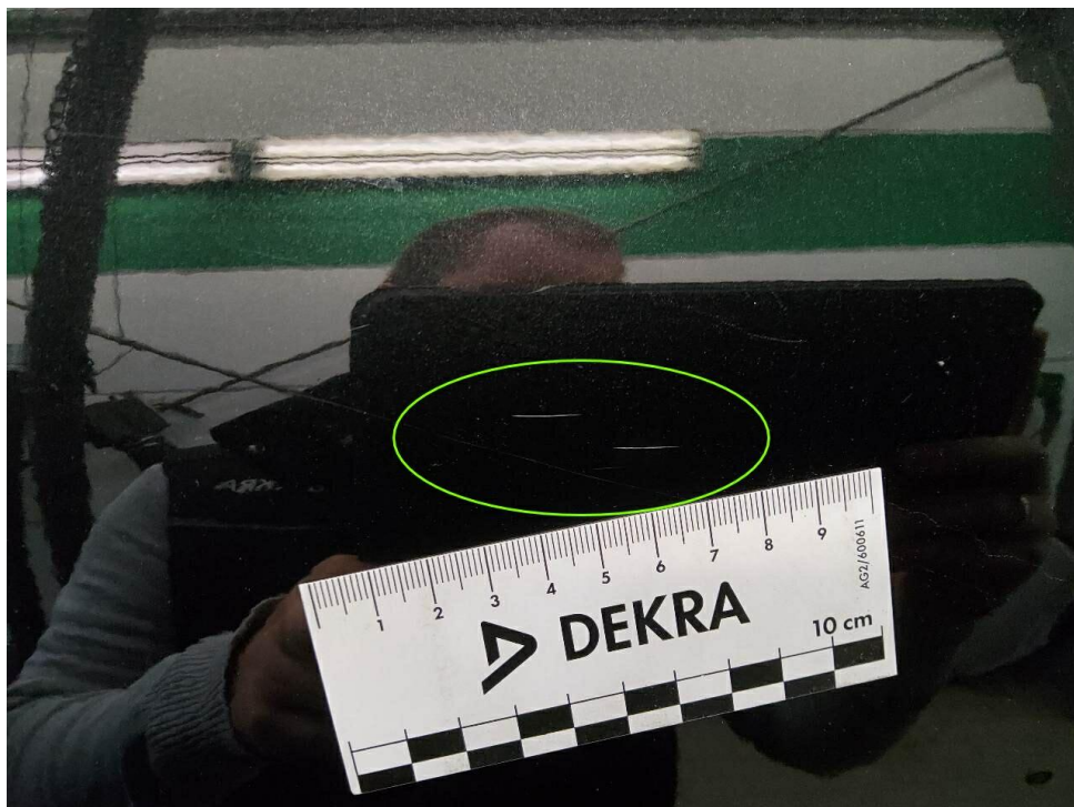
Bild 24 : Tür hinten links Lackierung, zerkratzt, lackieren
