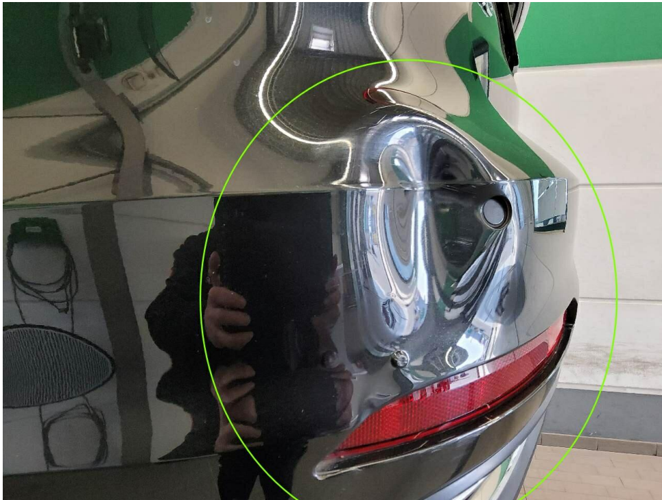
Bild 23 : Stoßfänger hinten, eingedrückt
