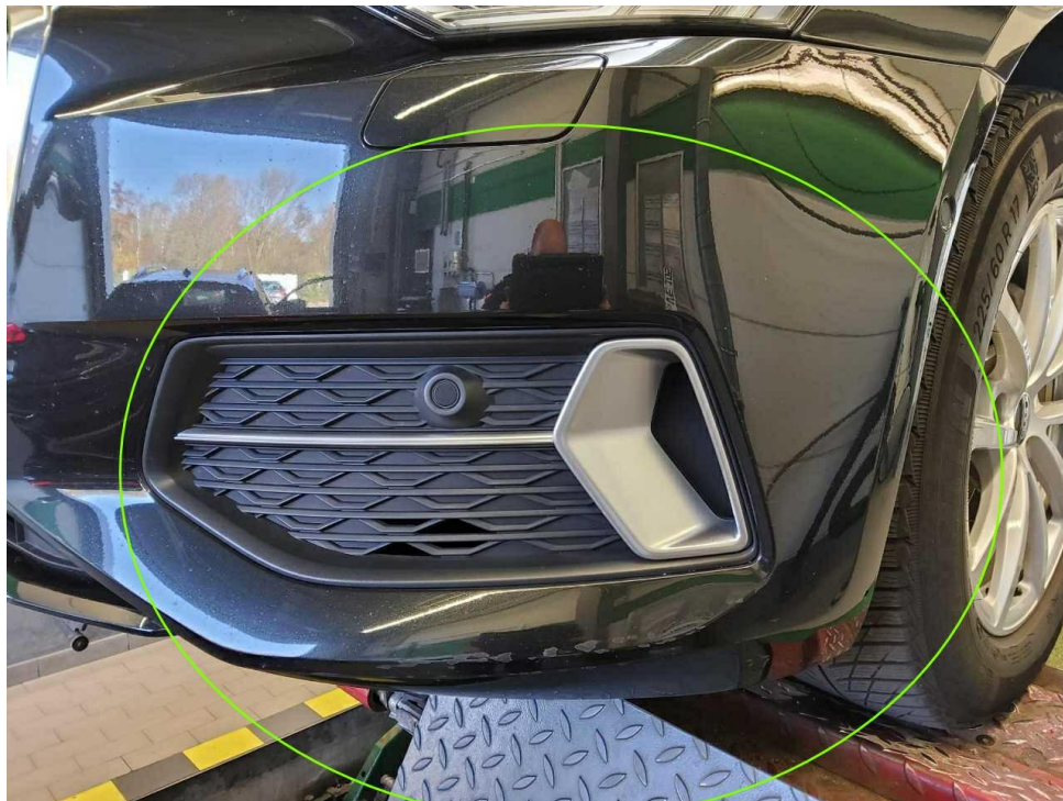
Bild 15 : Stoßfänger vorne Lackierung, verschrammt, lackieren mit Lackaufbau
