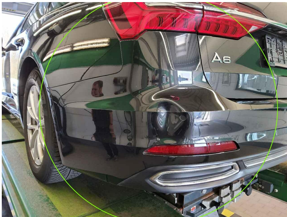
Bild 22 : Stoßfänger hinten, eingedrückt
