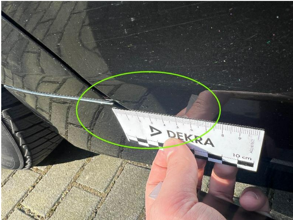
Bild 27 : Tür hinten rechts Lackierung, Steinschlag, Gebrauchsspur
