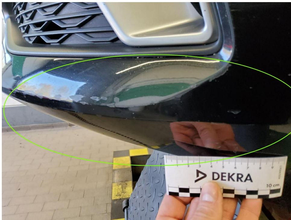
Bild 17 : Stoßfänger vorne Lackierung, verschrammt, lackieren mit Lackaufbau
