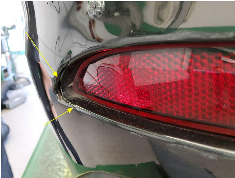
Bild 24 : Stoßfänger hinten, eingedrückt
