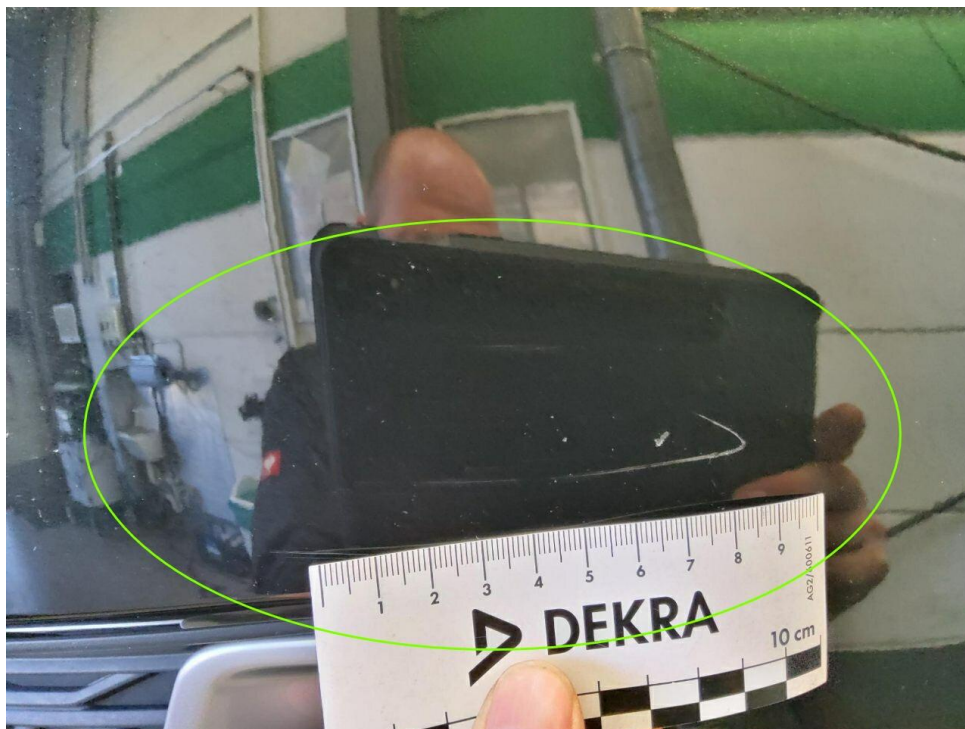
Bild 19 : Stoßfänger vorne Lackierung, verschrammt, lackieren mit Lackaufbau
