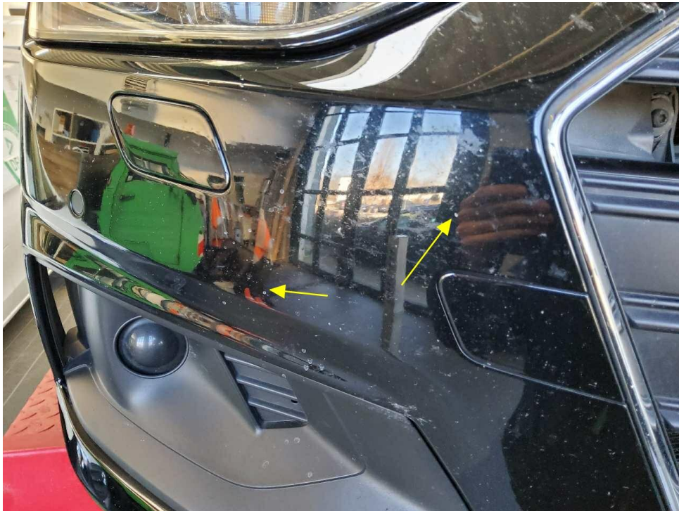
Bild 21 : Stoßfänger vorn leichte Steinschläge
