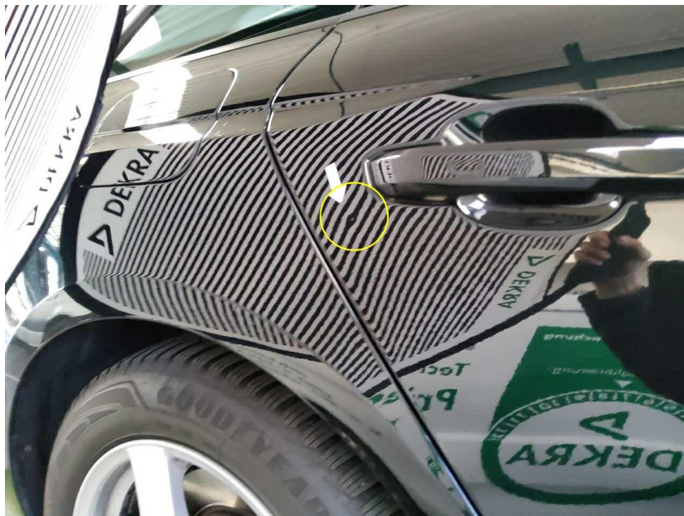
Bild 25 : Tür hinten rechts leicht eingedellt
