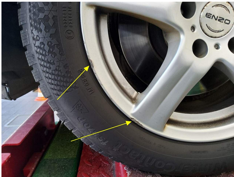
Bild 18 : Felge Winterradsatz vorn links zerkratzt
