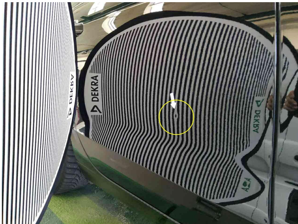
Bild 24 : Tür hinten rechts leicht eingedellt
