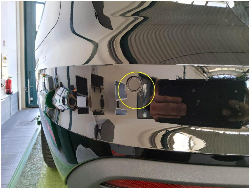
Bild 27 : Stoßfänger hinten links Restspuren der Nachlackierung
