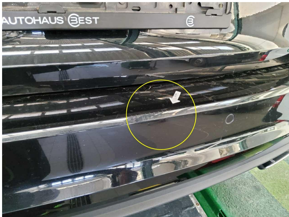
Bild 26 : Stoßfänger hinten Ladekante leicht zerkratzt
