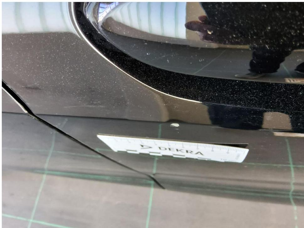
Bild 16 : Tür vorne rechts Lackierung, zerkratzt, lackieren mit Lackaufbau
