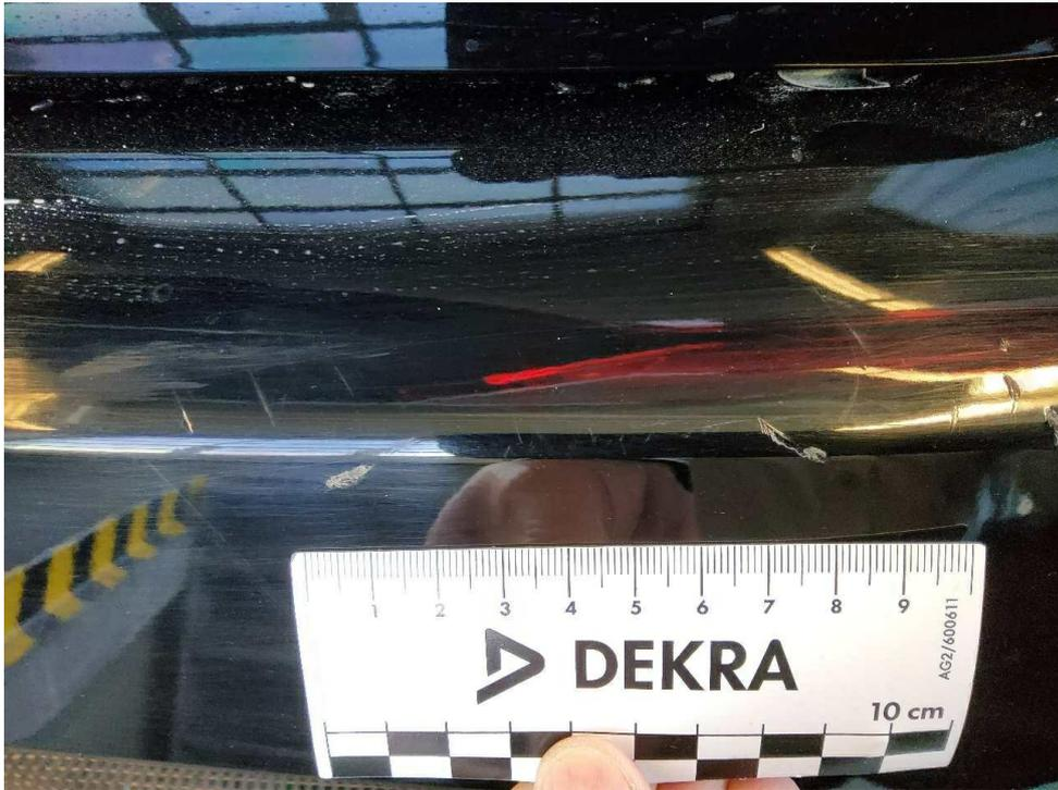
Bild 20 : Stoßfänger hinten Lackierung, zerkratzt, lackieren mit Lackaufbau
