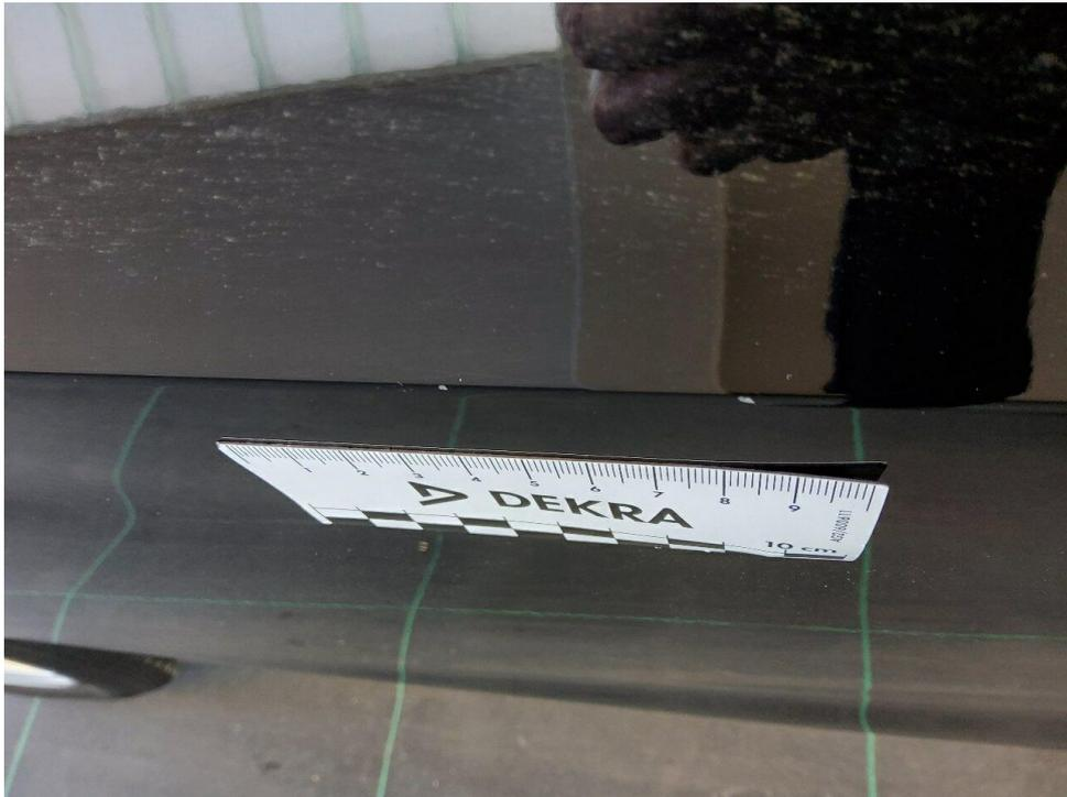
Bild 18 : Tür hinten rechts Lackierung, zerkratzt, lackieren mit Lackaufbau
