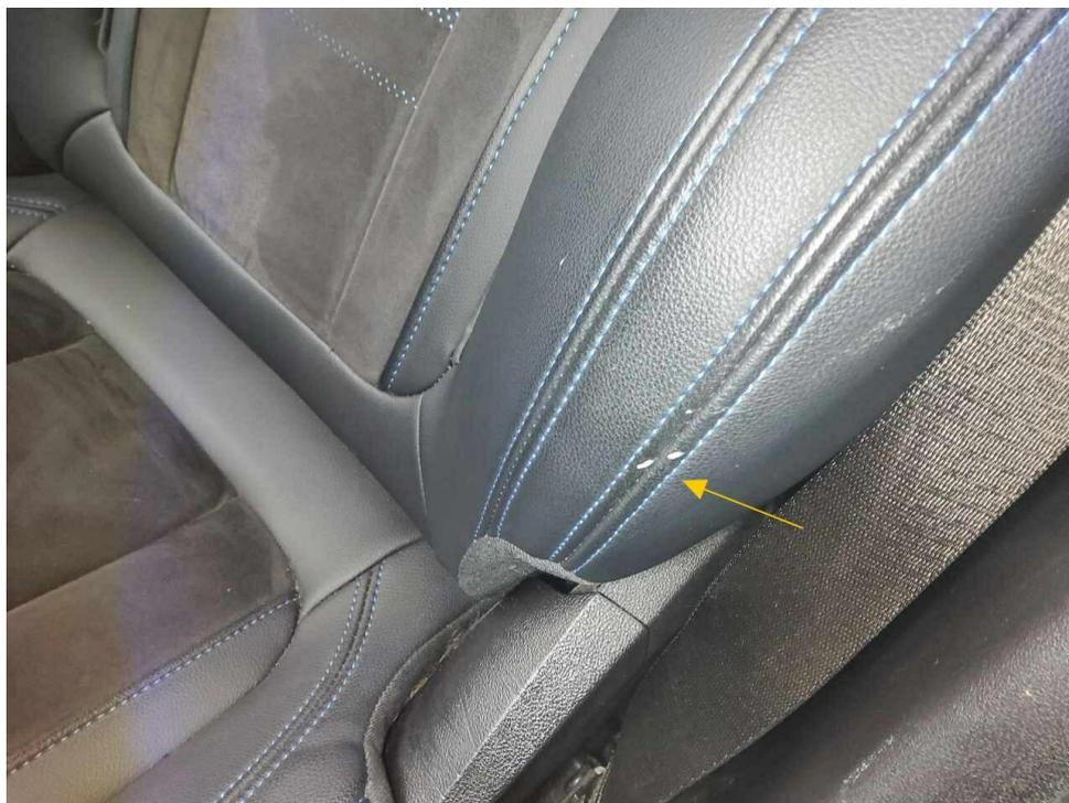
Bild 20 : Lehnenbezug vorne links zerkratzt
