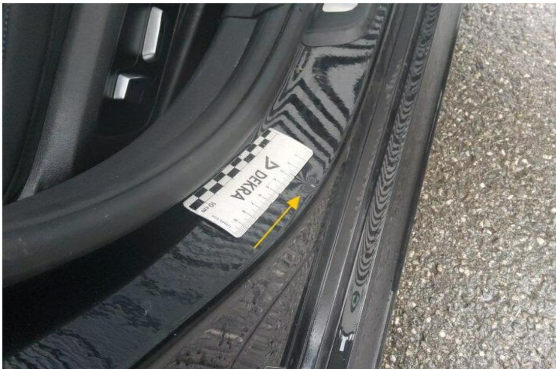
Bild 15 : Tür vorne rechts Einstieg Lackierung, zerkratzt, smart repair
