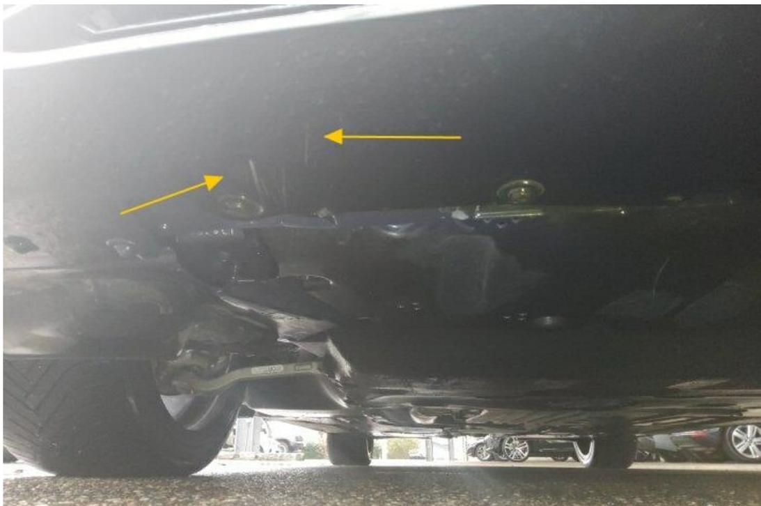
Bild 11 : Frontspoiler Lackierung, zerkratzt, lackieren mit Lackaufbau
