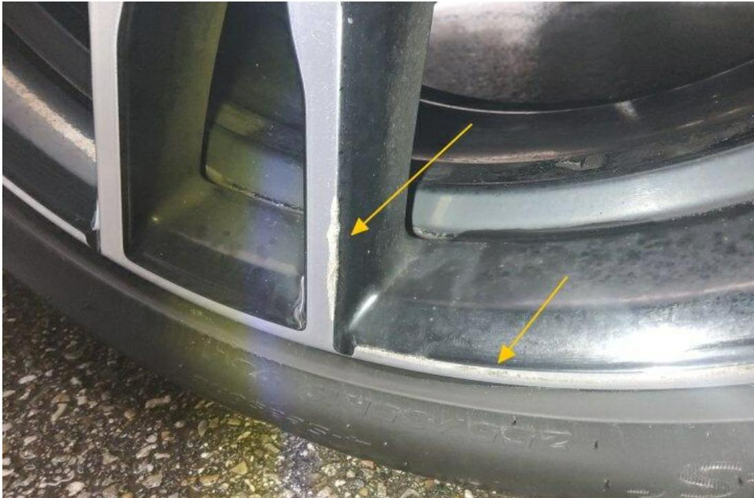
Bild 13 : Felge hinten links, verschrammt, erneuern
