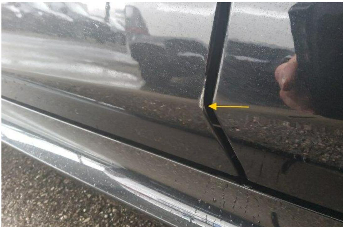
Bild 9 : Tür vorne links Lackierung, zerkratzt, lackieren mit Lackaufbau
