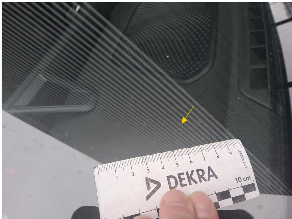
Bild 19 : Windschutzscheibe oberflächliche Steinschläge
