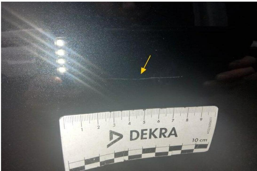
Bild 8 : Tür vorne links Lackierung, zerkratzt, lackieren mit Lackaufbau
