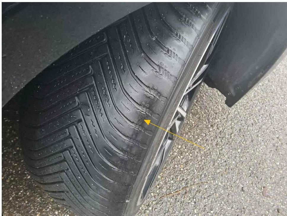
Bild 22 : Reifen Vorderachse außen abgefahren, vermessen
