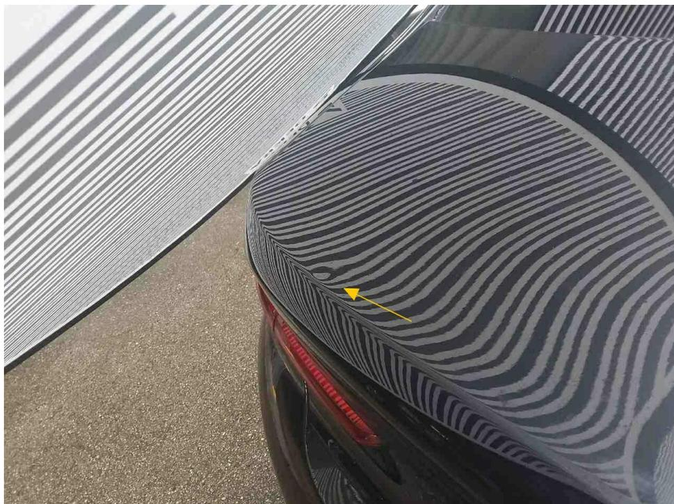
Bild 16 : Heckklappe eingedellt
