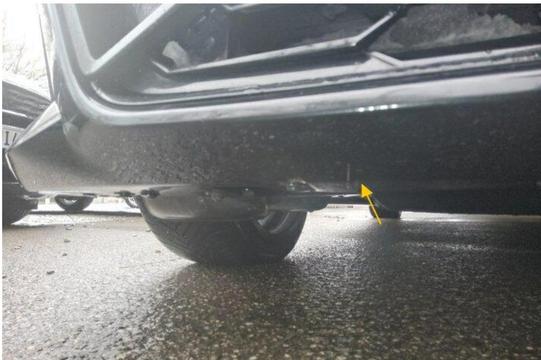
Bild 10 : Frontspoiler Lackierung, zerkratzt, lackieren mit Lackaufbau
