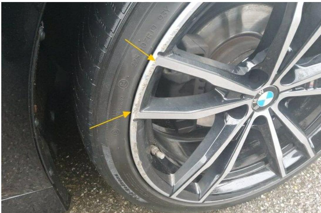
Bild 12 : Felge vorne rechts, verschrammt, erneuern
