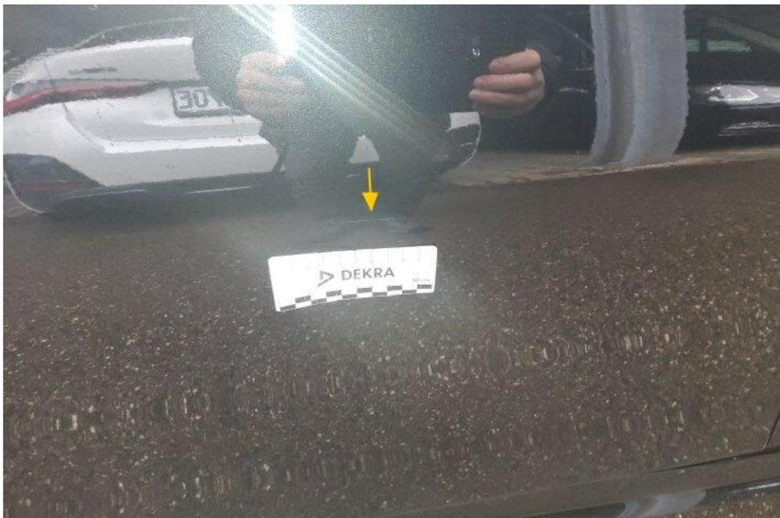
Bild 7 : Tür vorne links Lackierung, zerkratzt, lackieren mit Lackaufbau
