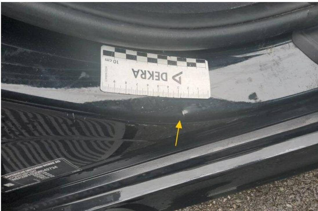
Bild 14 : Tür vorne rechts Einstieg Lackierung, zerkratzt, smart repair
