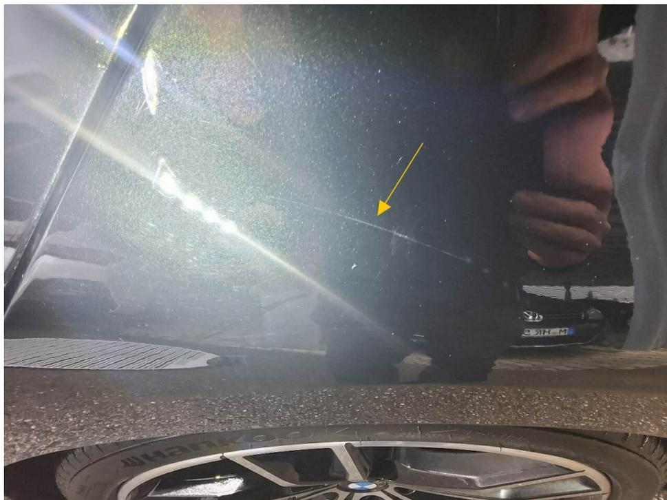
Bild 17 : Diverse Kratzer an der Fahrzeugaußenseite, schleifen und polieren
