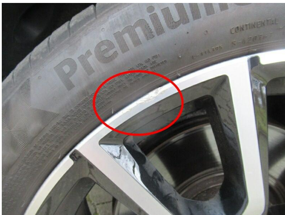
Bild 16 : Felge vorne links, verschrämmt, Gebrauchsspur
