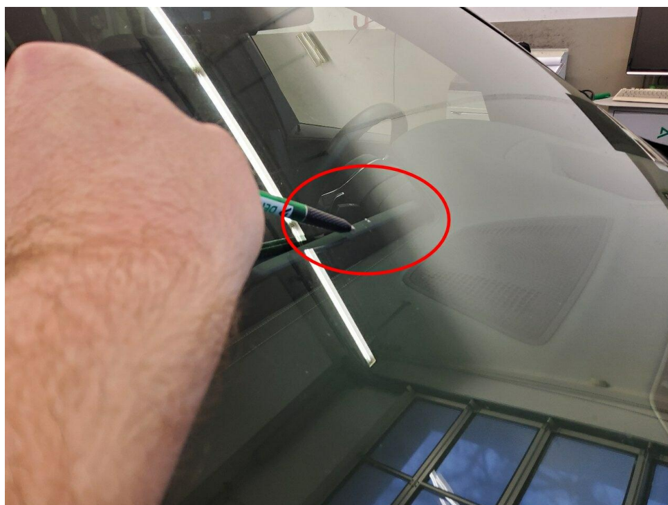
Bild 14 : Frontscheibe Steinschlag mit Rissbildung
