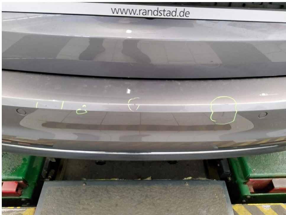
Bild 18 : Stoßfänger hinten, zerkratzt, Gebrauchsspur
