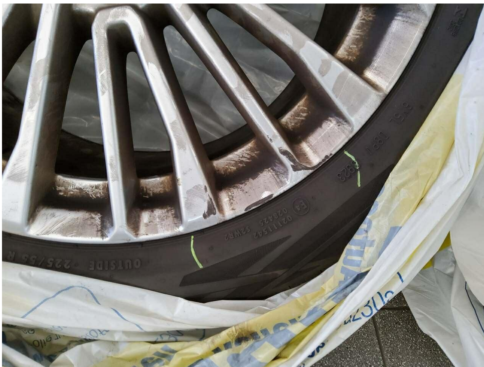
Bild 32 : 2x Alufelge (Sommer) kratzbeschädigt
