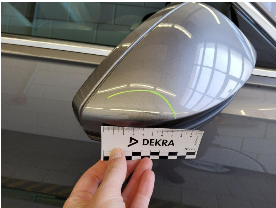
Bild 14 : Außenspiegel rechts Gehäuse, zerkratzt, lackieren mit Lackaufbau
