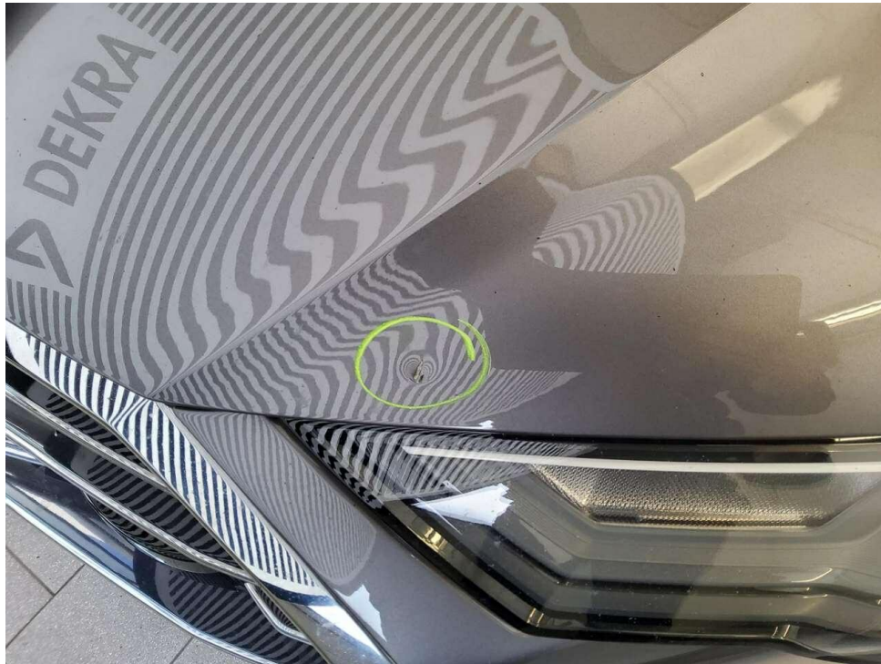
Bild 21 : Motorhaube, eingedellt, instandsetzen und lackieren mit Lackaufbau
