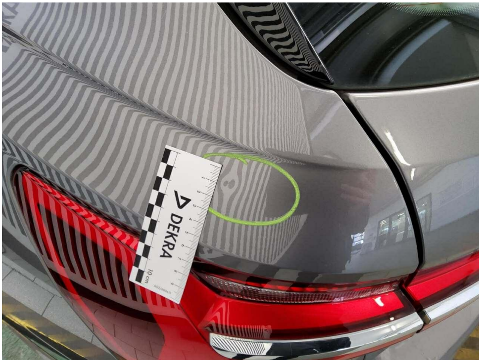
Bild 16 : Seitenteil hinten links, eingedellt, smart repair
