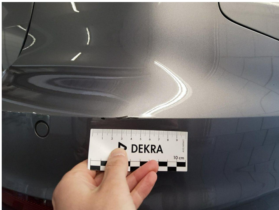
Bild 26 : Stoßfänger hinten, zerkratzt, lackieren mit Lackaufbau
