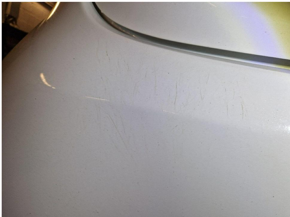
Bild 3 : Stoßfänger hinten Kratzer
