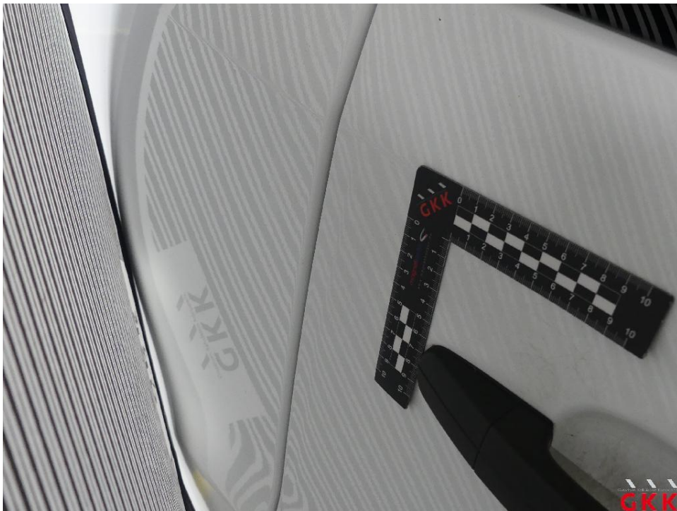
Bild 34 Hecktür rechts, beschädigt, instand setzen - lackieren
