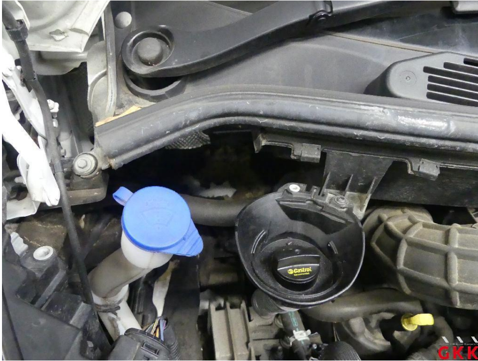
Bild 17 Motorraum, Dämmmatte, beschädigt, ersetzen
