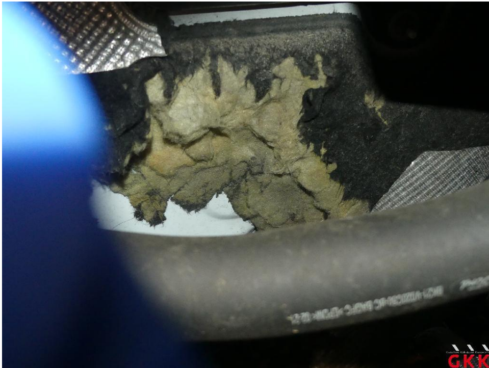
Bild 19 Motorraum, Dämmmatte, beschädigt, ersetzen
