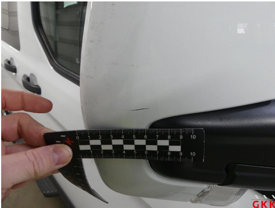
Bild 24 Spiegelgehäuse rechts, Kappe -lackiert-, verkratzt, lackieren ohne LV
