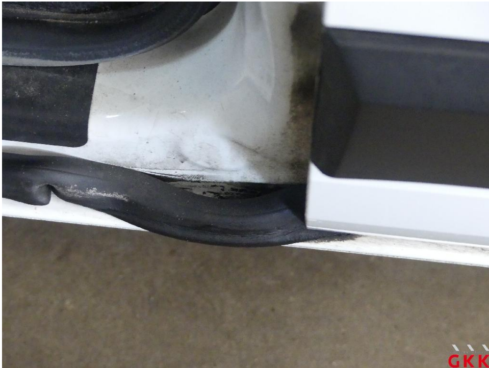
Bild 39 Tür vorne links, Dichtung -Einstieg-, lose, ersetzen
