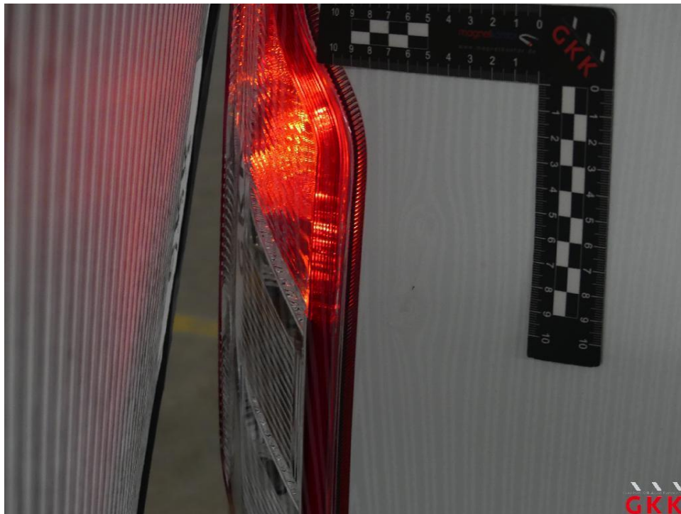
Bild 36 Hecktür links, beschädigt, instand setzen - lackieren
