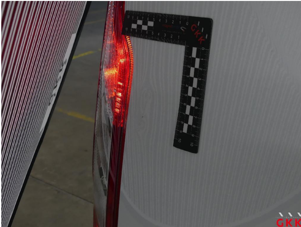
Bild 37 Hecktür links, beschädigt, instand setzen - lackieren
