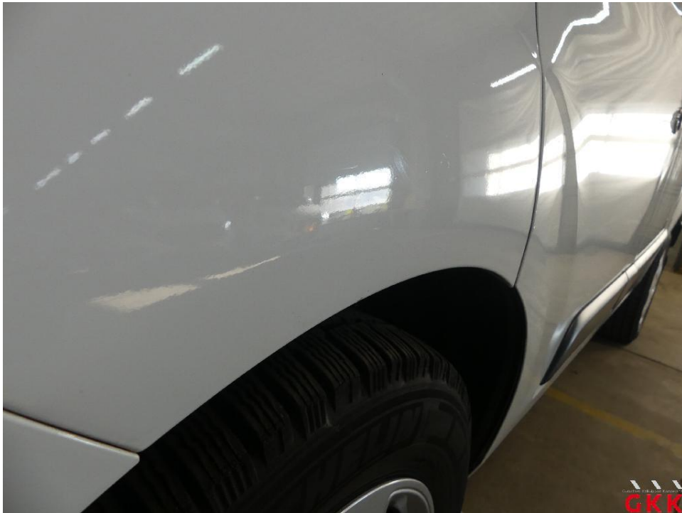
Bild 41 Kotflügel vorne links, Reparaturmangel, polieren
