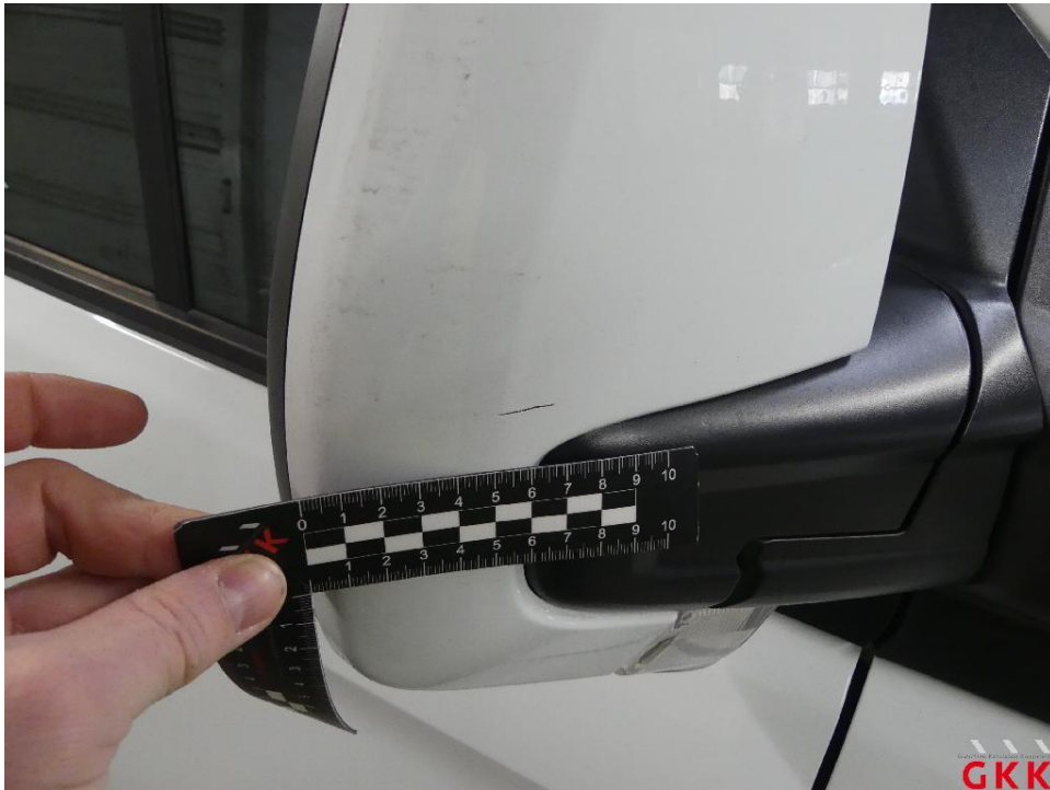
Bild 25 Spiegelgehäuse rechts, Kappe -lackiert-, verkratzt, lackieren ohne LV
