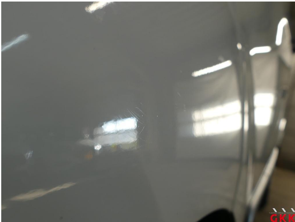
Bild 42 Kotflügel vorne links, Reparaturmangel, polieren
