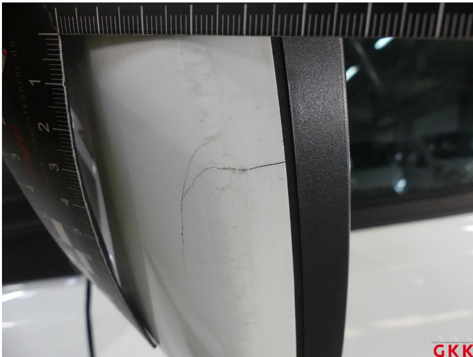
Bild 22 Spiegelgehäuse links, Kappe -lackiert-, gerissen, ersetzen
