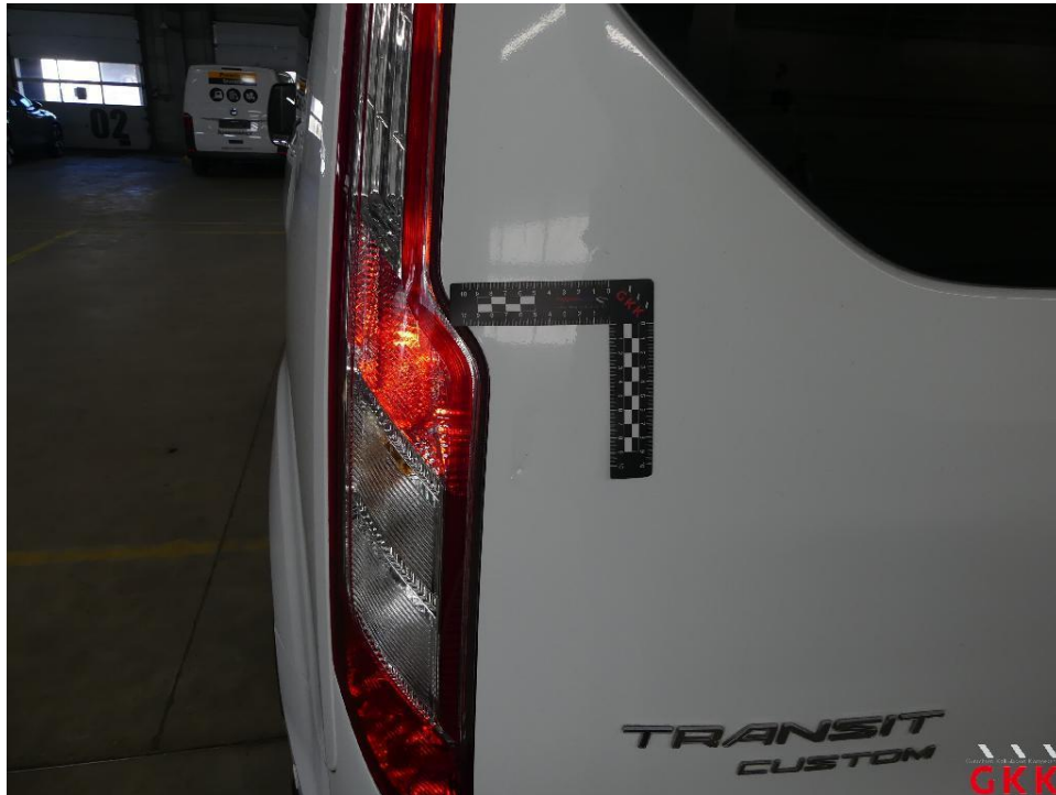
Bild 35 Hecktür links, beschädigt, instand setzen - lackieren
