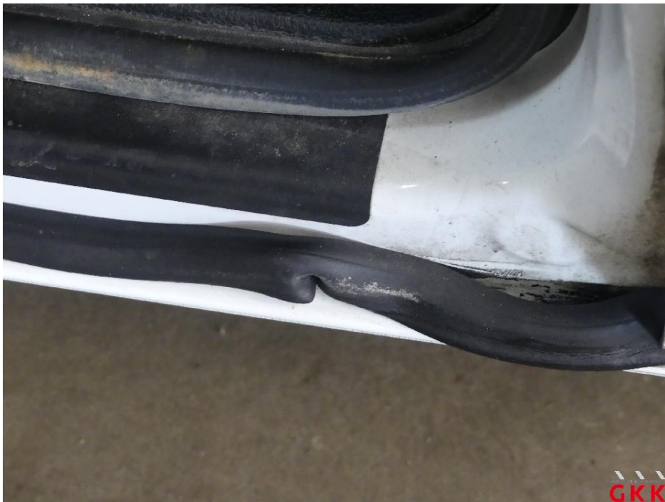
Bild 40 Tür vorne links, Dichtung -Einstieg-, lose, ersetzen
