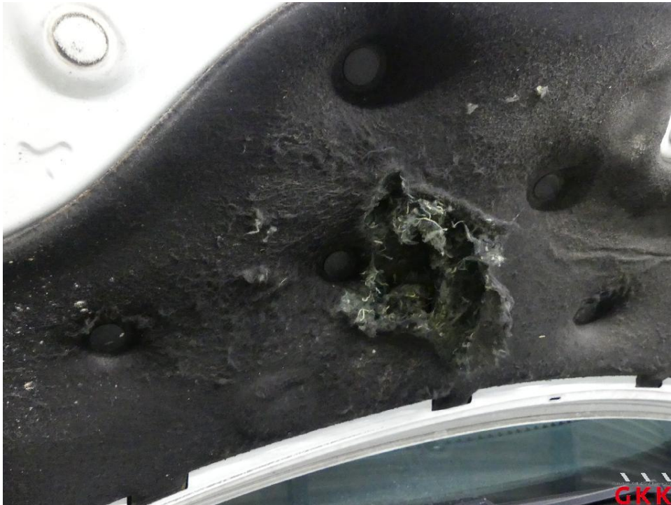
Bild 15 Motorhaube, Dämmmatte, beschädigt, ersetzen
