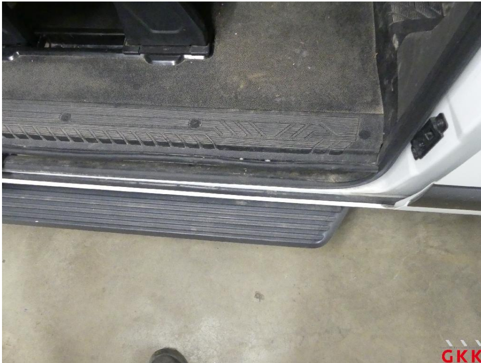
Bild 29 Schiebetür rechts, Dichtung -Einstieg-, lose, ersetzen
