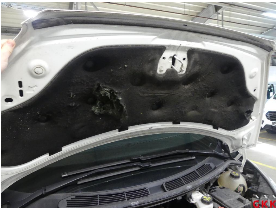
Bild 14 Motorhaube, Dämmmatte, beschädigt, ersetzen
