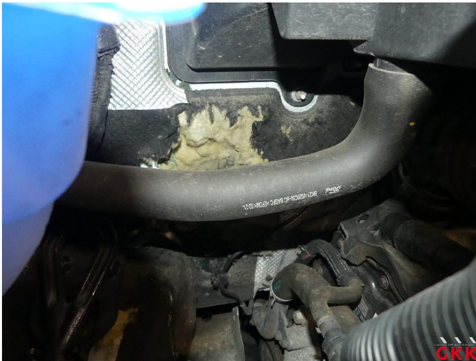
Bild 18 Motorraum, Dämmmatte, beschädigt, ersetzen
