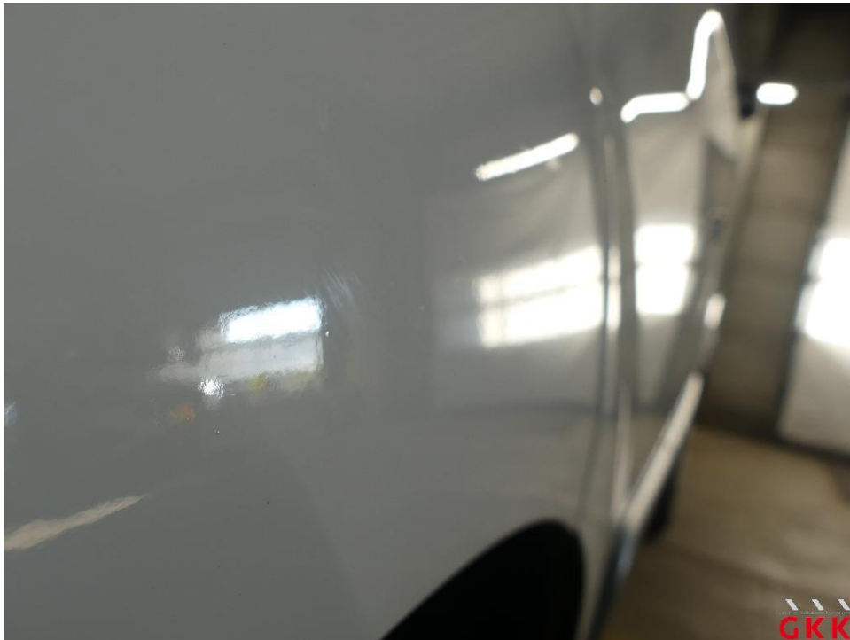
Bild 43 Kotflügel vorne links, Reparaturmangel, polieren
