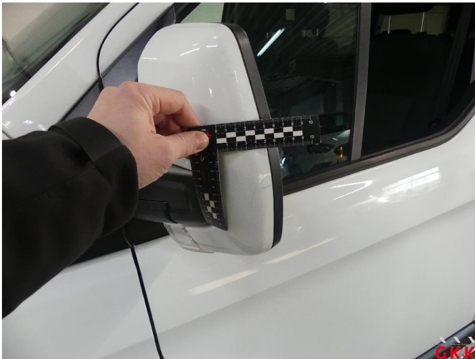
Bild 20 Spiegelgehäuse links, Kappe -lackiert-, gerissen, ersetzen
