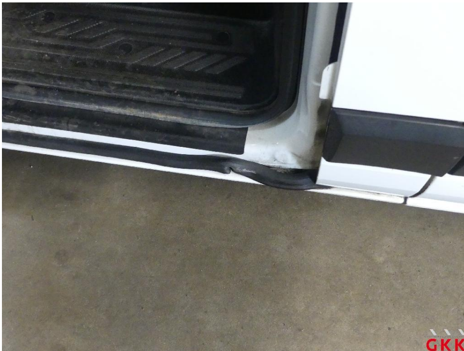
Bild 38 Tür vorne links, Dichtung -Einstieg-, lose, ersetzen
