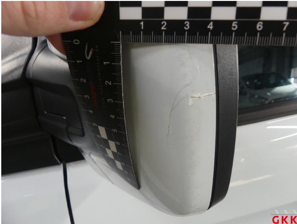
Bild 21 Spiegelgehäuse links, Kappe -lackiert-, gerissen, ersetzen
