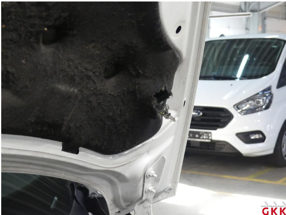
Bild 16 Motorhaube, Dämmmatte, beschädigt, ersetzen
