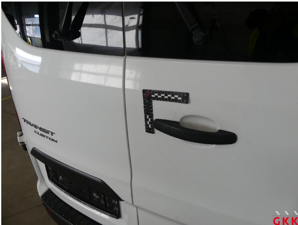
Bild 32 Hecktür rechts, beschädigt, instand setzen - lackieren
