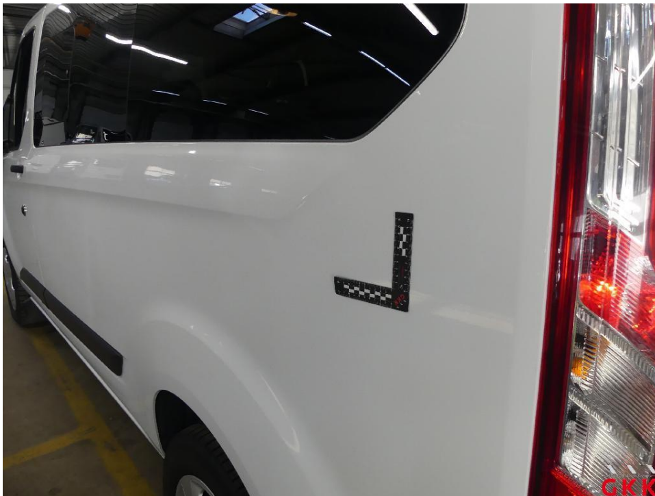
Bild 16 Seitenwand links, beschädigt, instand setzen - lackieren
