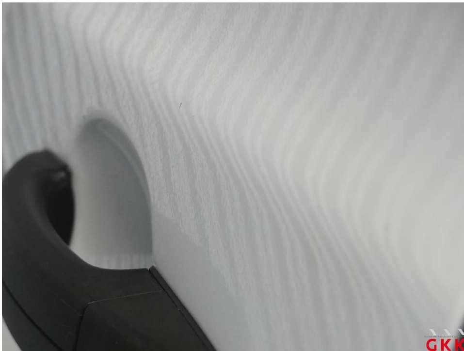
Bild 26 Tür vorne links, Reparaturmangel, polieren
