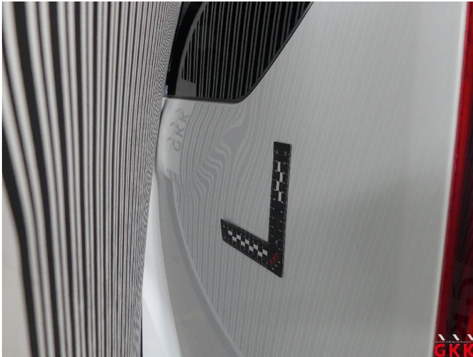
Bild 17 Seitenwand links, beschädigt, instand setzen - lackieren
