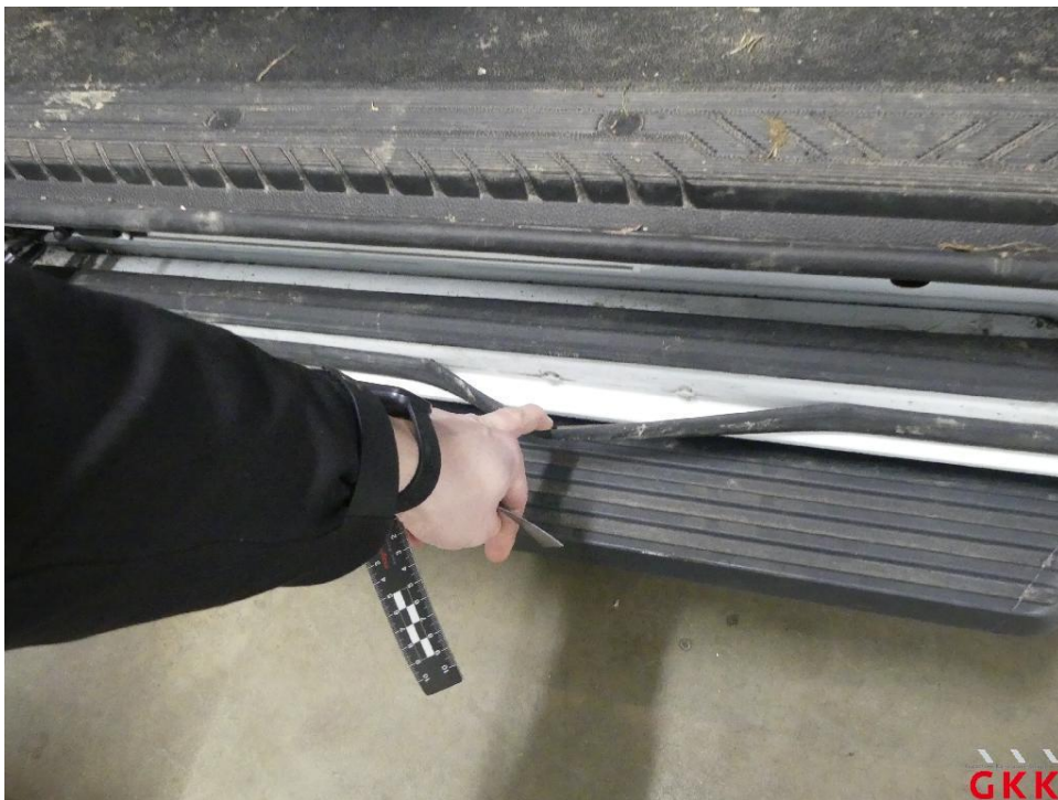
Bild 14 Schiebetür rechts, Dichtung -Einstieg-, lose, ersetzen
