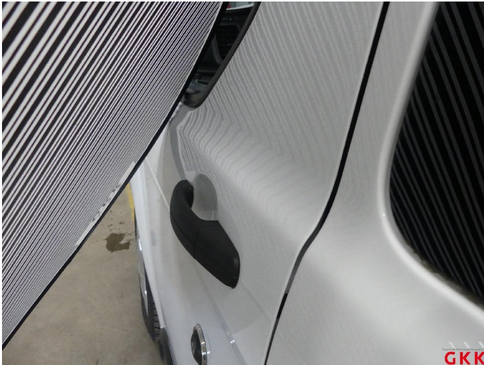
Bild 25 Tür vorne links, Reparaturmangel, polieren
