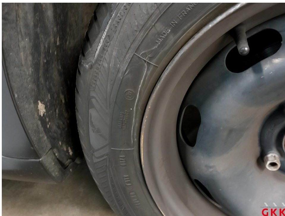
Bild 18 Stahlrad, vorne rechts, beschädigt, ersetzen
