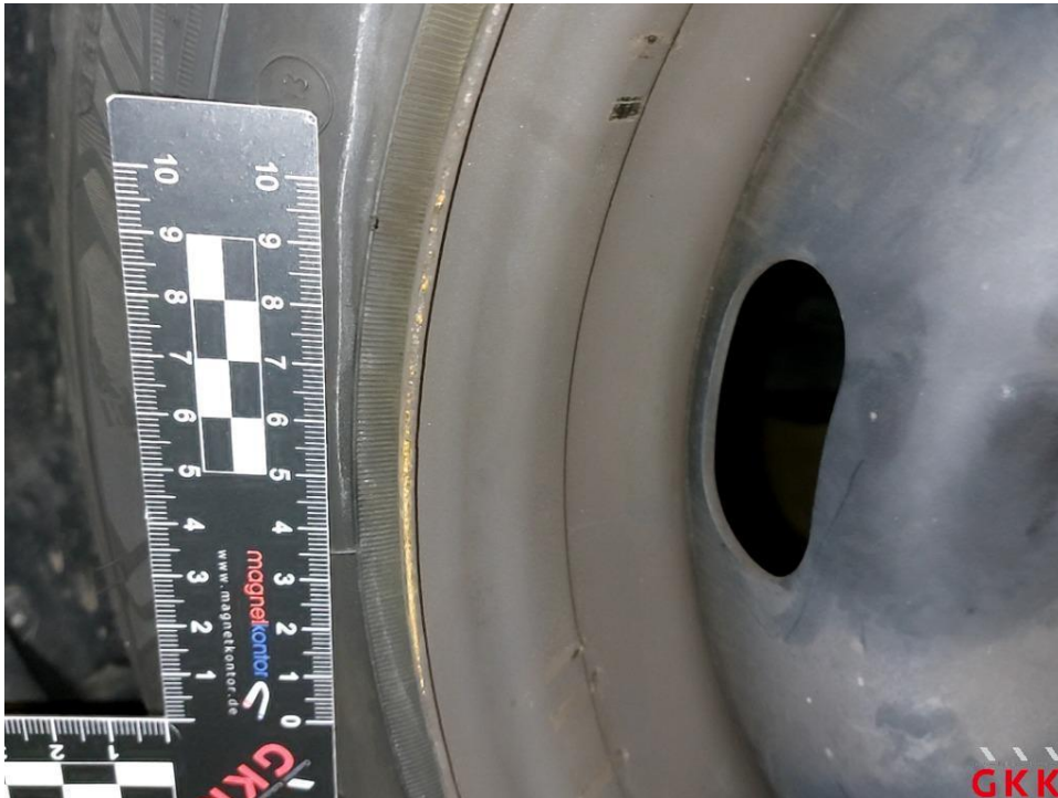
Bild 19 Stahlrad, vorne rechts, beschädigt, ersetzen
