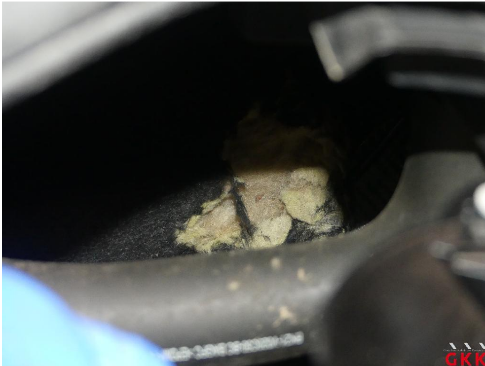
Bild 15 Motorraum, Dämmmatte, beschädigt, ersetzen
