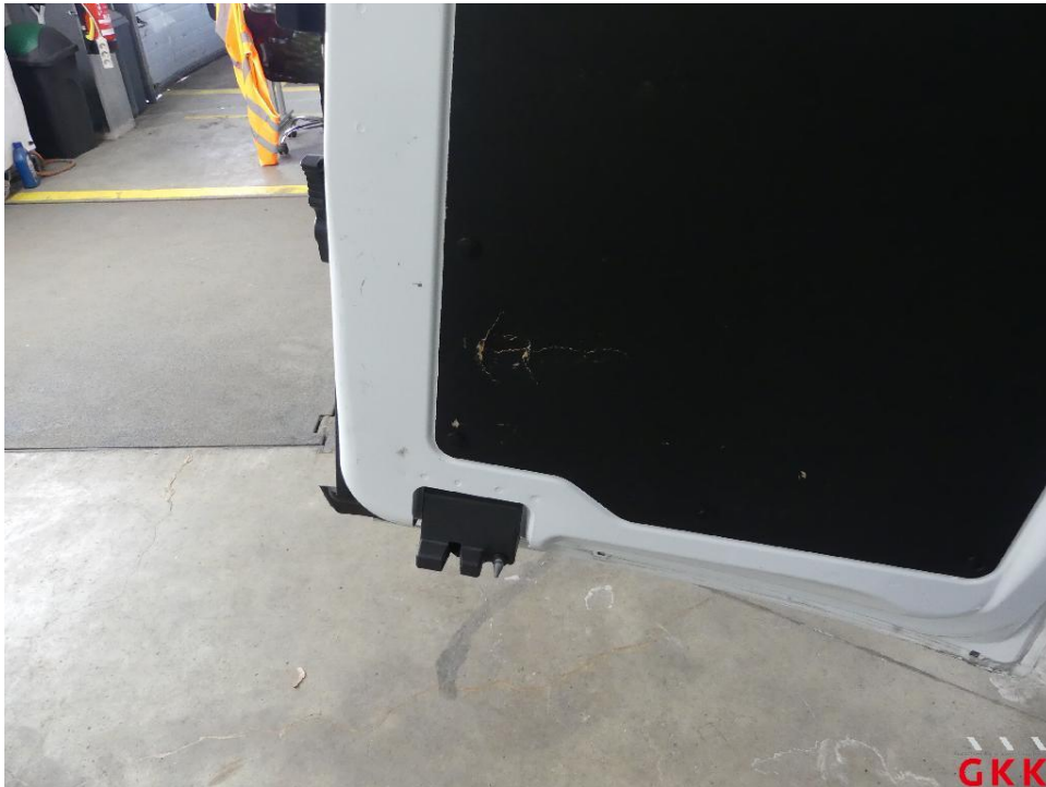
Bild 27 Hecktür links, Innenverkleidung -Abdeckung-, beschädigt, ersetzen
