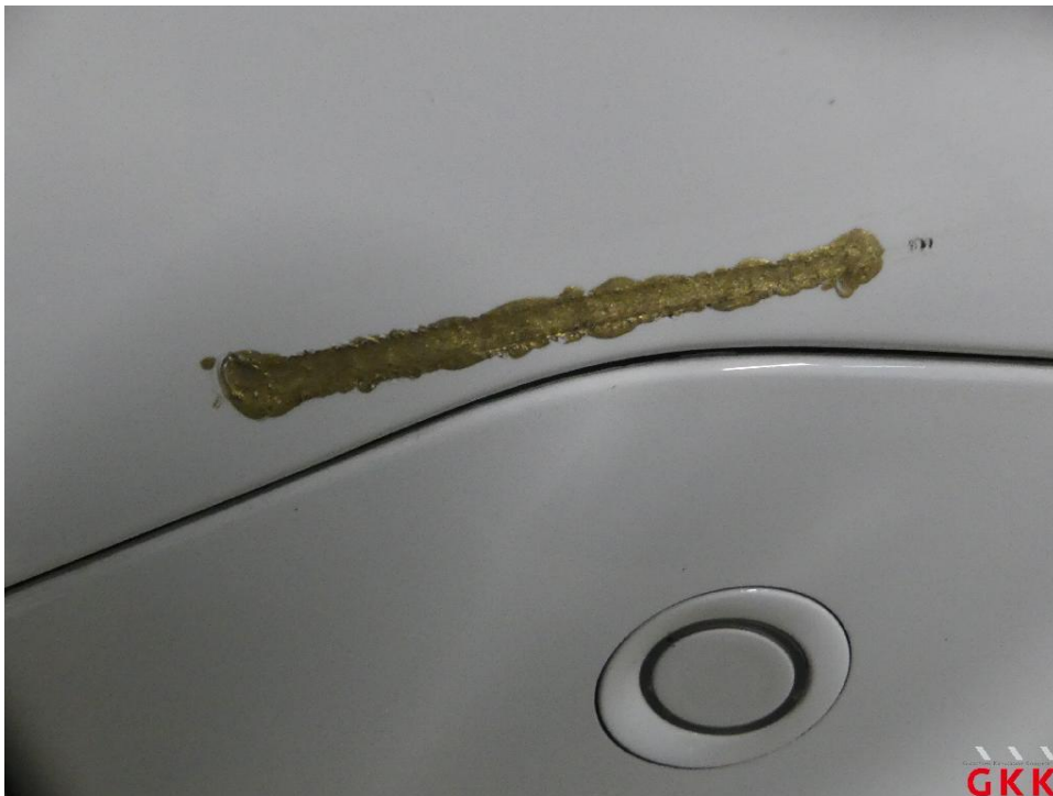
Bild 18 Stoßfänger vorne, Verkleidung -lackiert-, verkratzt, Smartrepair
