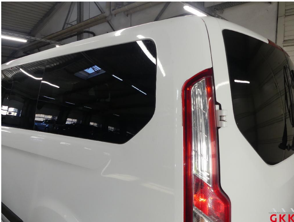
Bild 30 Seitenwand links, Klebreiste, entfernen
