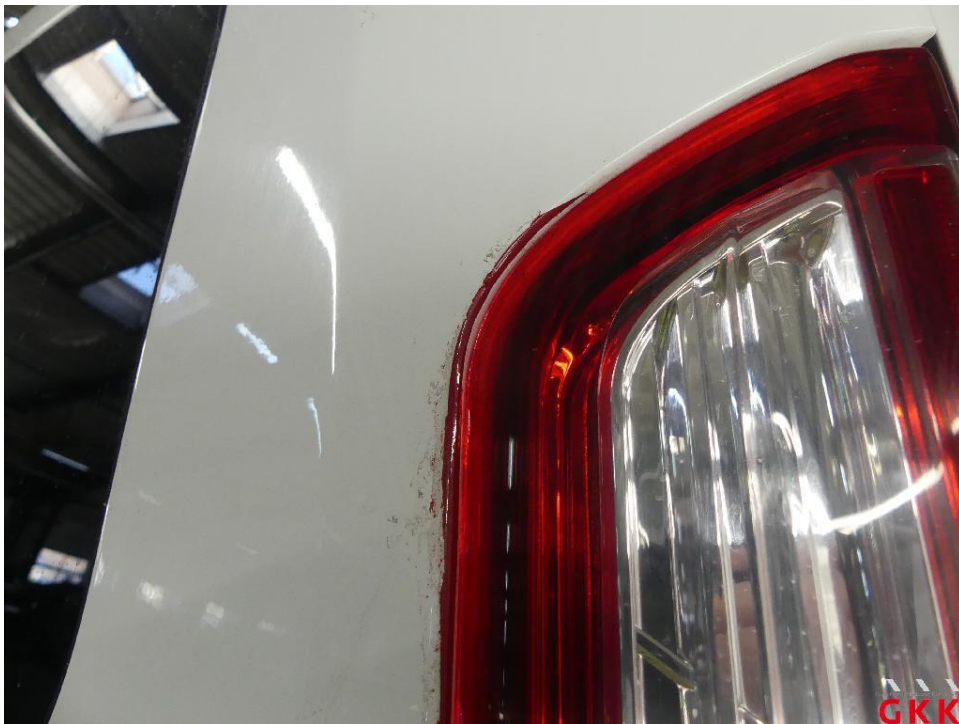
Bild 32 Seitenwand links, Klebreste, entfernen
