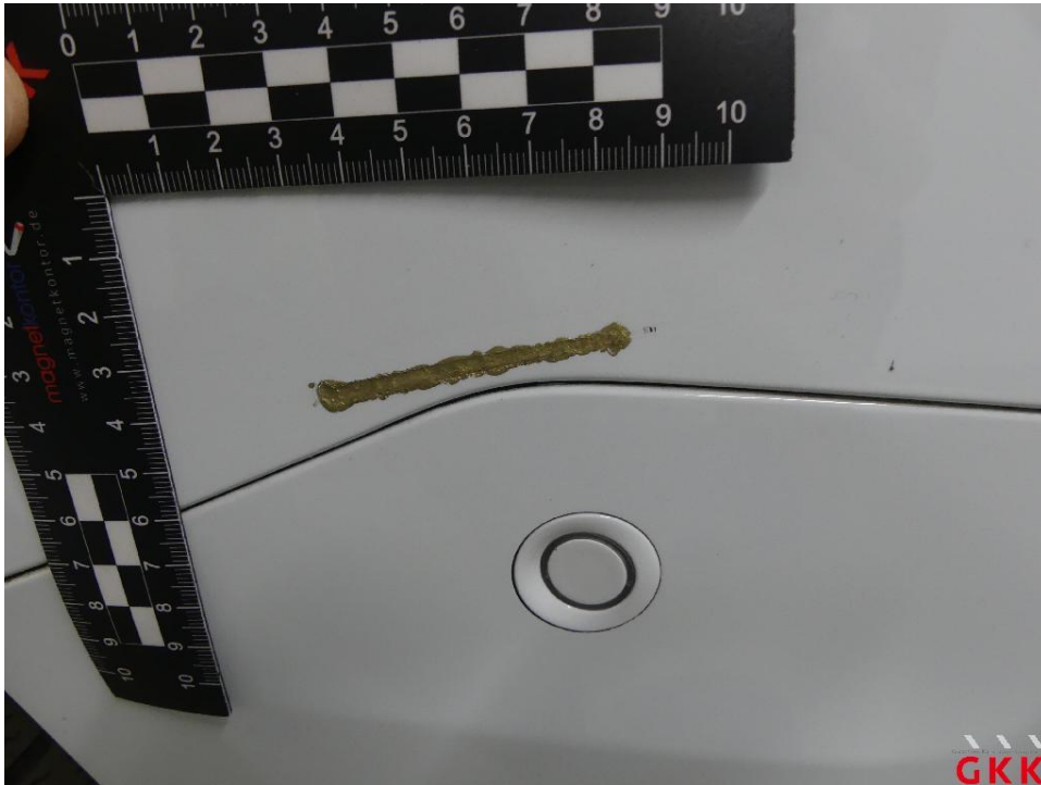
Bild 17 Stoßfänger vorne, Verkleidung -lackiert-, verkratzt, Smartrepair
