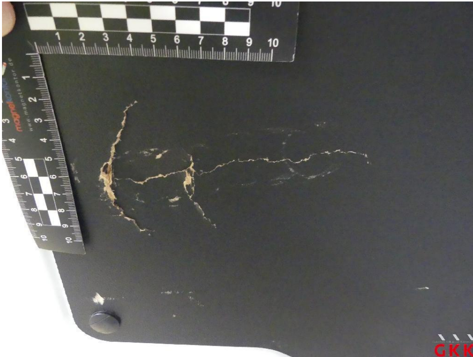
Bild 29 Hecktür links, Innenverkleidung -Abdeckung-, beschädigt, ersetzen
