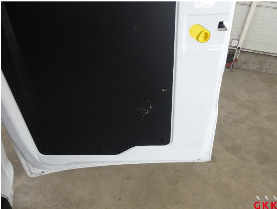
Bild 24 Hecktür rechts, Innenverkleidung -Abdeckung-, beschädigt, ersetzen
