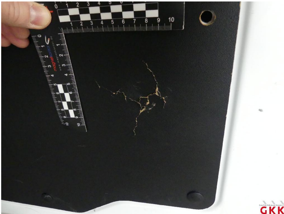
Bild 26 Hecktür rechts, Innenverkleidung -Abdeckung-, beschädigt, ersetzen
