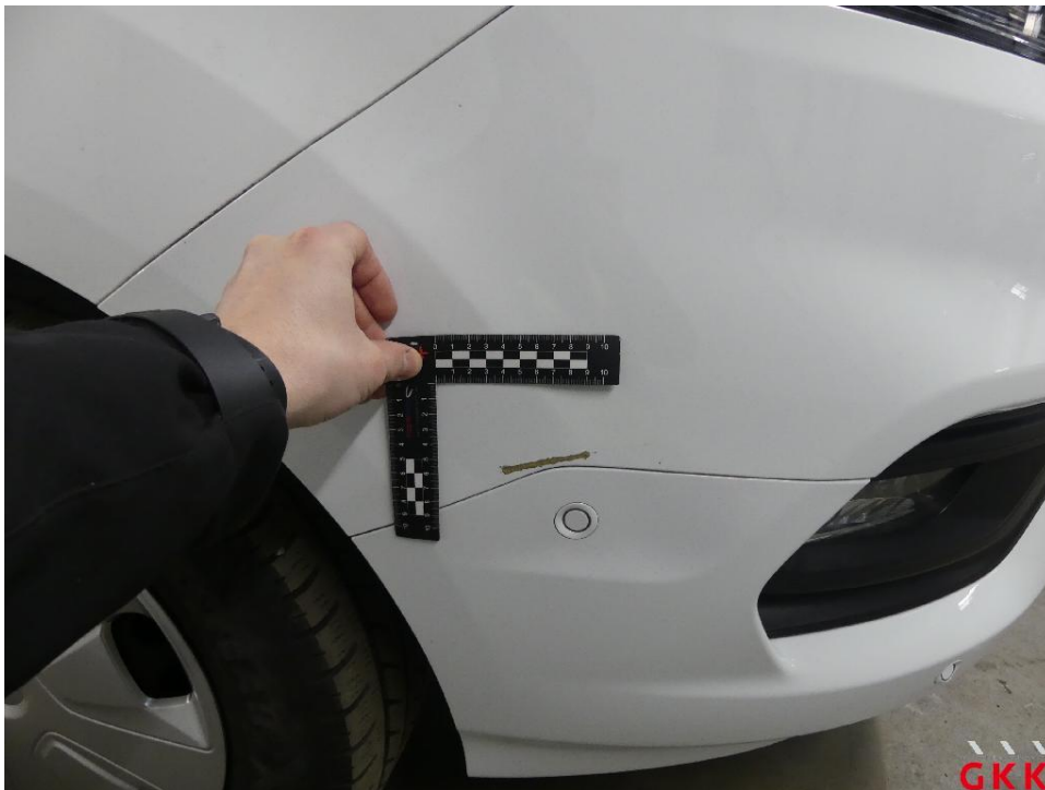
Bild 16 Stoßfänger vorne, Verkleidung -lackiert-, verkratzt, Smartrepair
