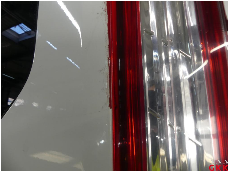
Bild 31 Seitenwand links, Klebreste, entfernen
