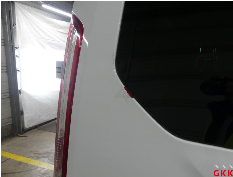
Bild 22 Seitenwand rechts, Klebreste, entfernen
