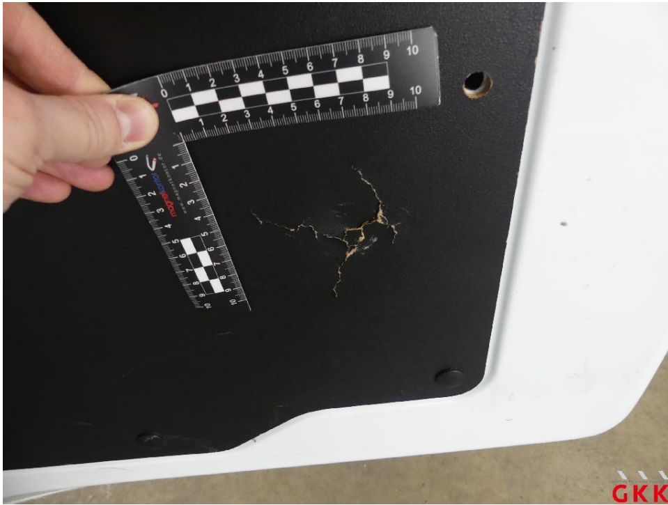
Bild 25 Hecktür rechts, Innenverkleidung -Abdeckung-, beschädigt, ersetzen
