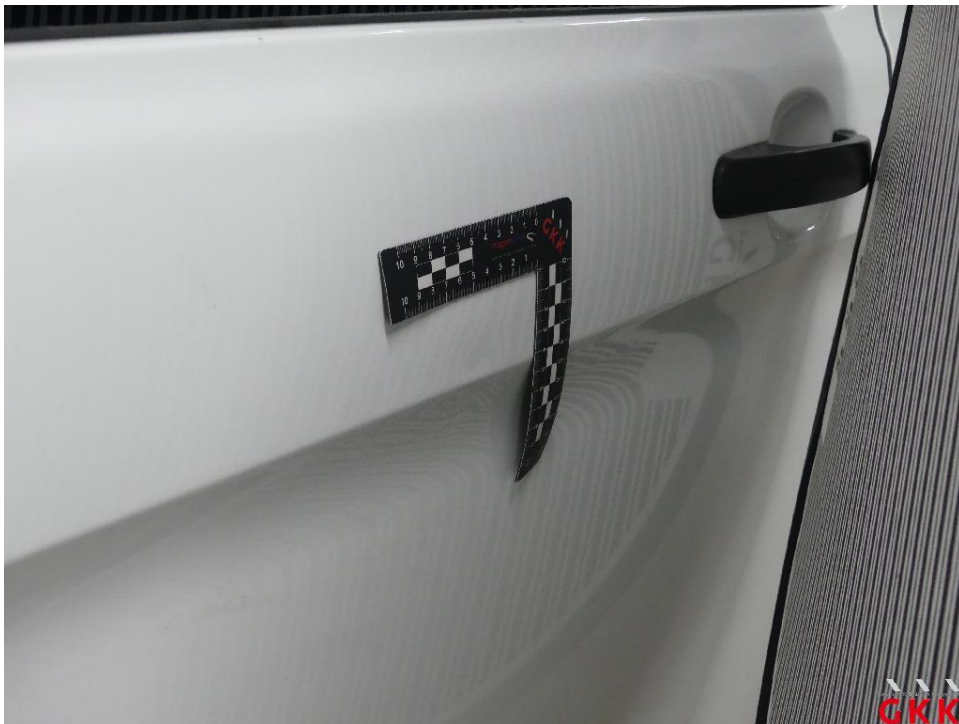
Bild 20 Schiebetür rechts, beschädigt, instand setzen - lackieren
