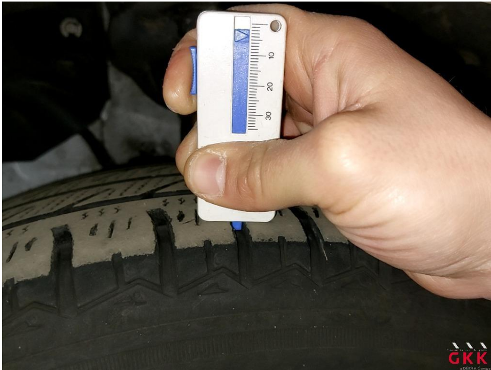
Bild 15 Reifen, vorn links und rechts, Untermaß, ersetzen
