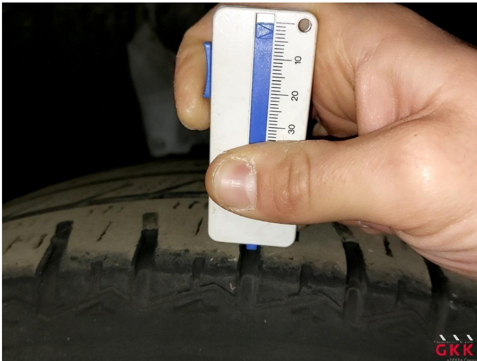
Bild 16 Reifen, vorn links und rechts, Untermaß, ersetzen
