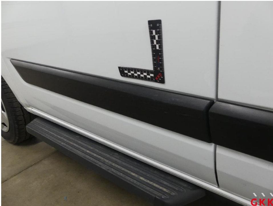
Bild 17 Schiebetür rechts, Leiste -unten-, verkratzt, ersetzen
