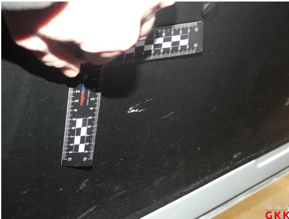
Bild 24 Schiebetür rechts, Innenverkleidung -Abdeckung-, beschädigt, ersetzen
