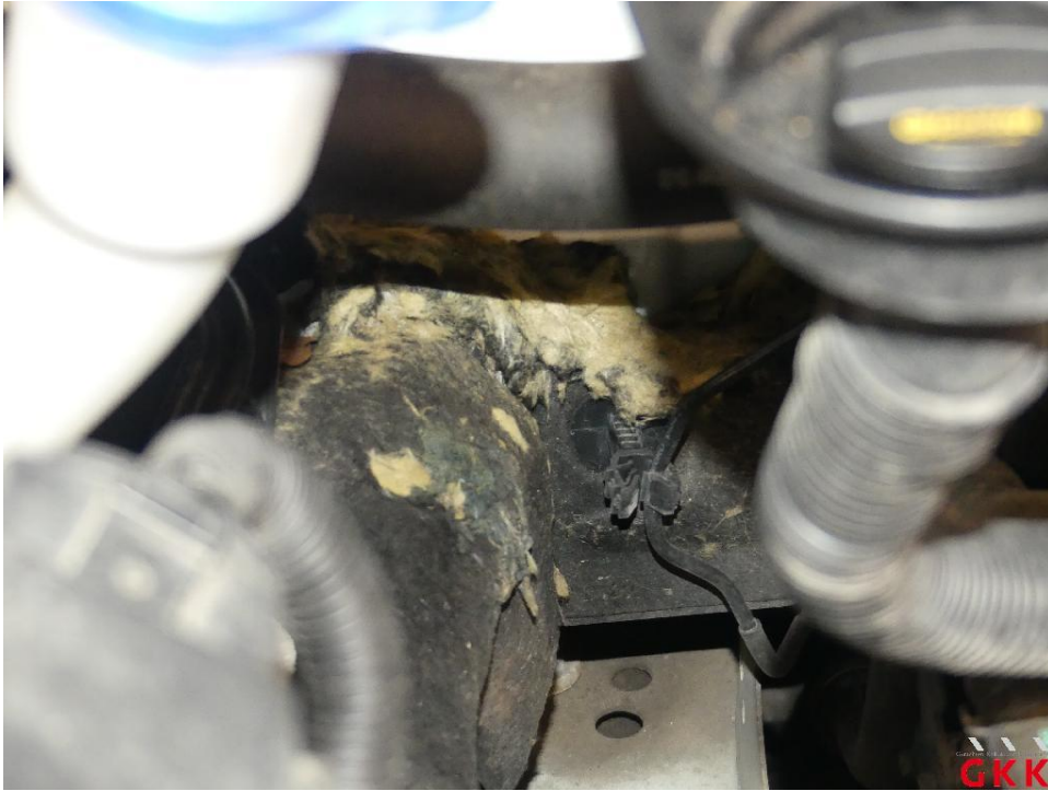
Bild 15 Motorraum, Dämmmatte, beschädigt, ersetzen
