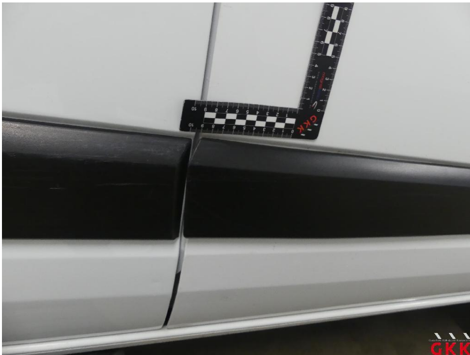
Bild 20 Tür vorne rechts, Leiste -unten-, verkratzt, ersetzen
