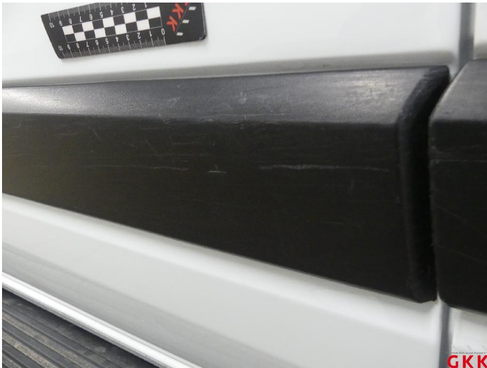
Bild 18 Schiebetür rechts, Leiste -unten-, verkratzt, ersetzen
