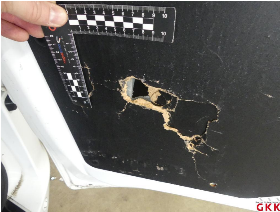
Bild 27 Hecktür rechts, Innenverkleidung -Abdeckung-, beschädigt, ersetzen
