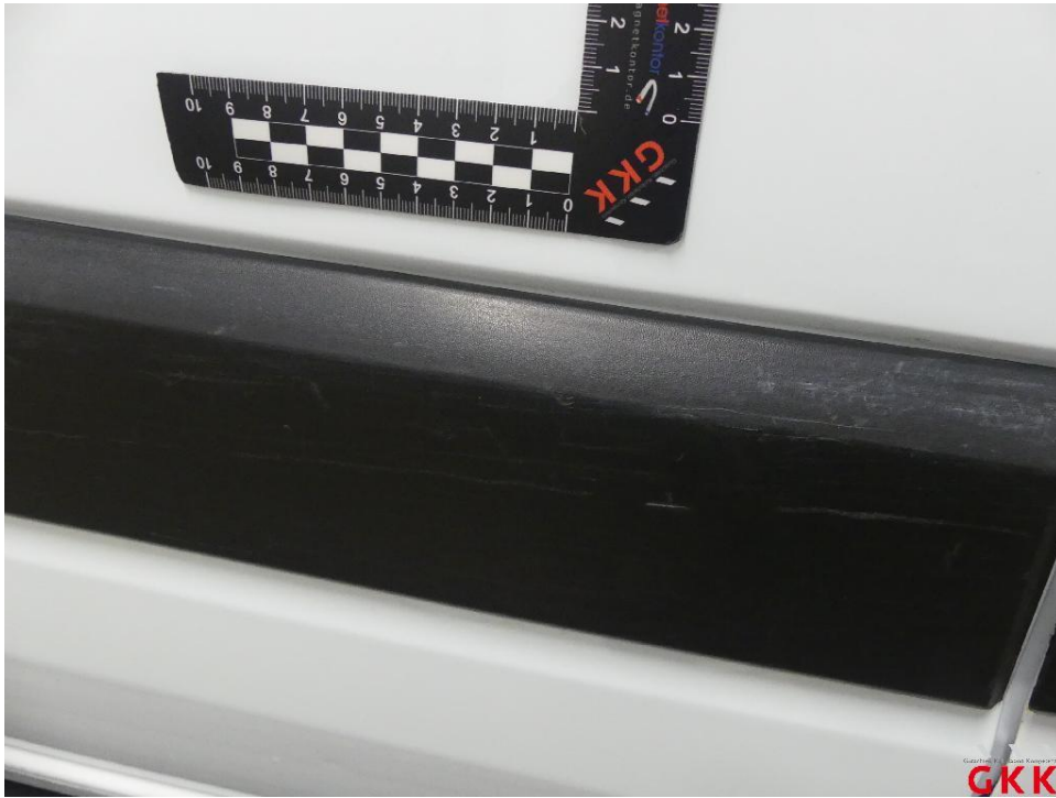
Bild 19 Schiebetür rechts, Leiste -unten-, verkratzt, ersetzen
