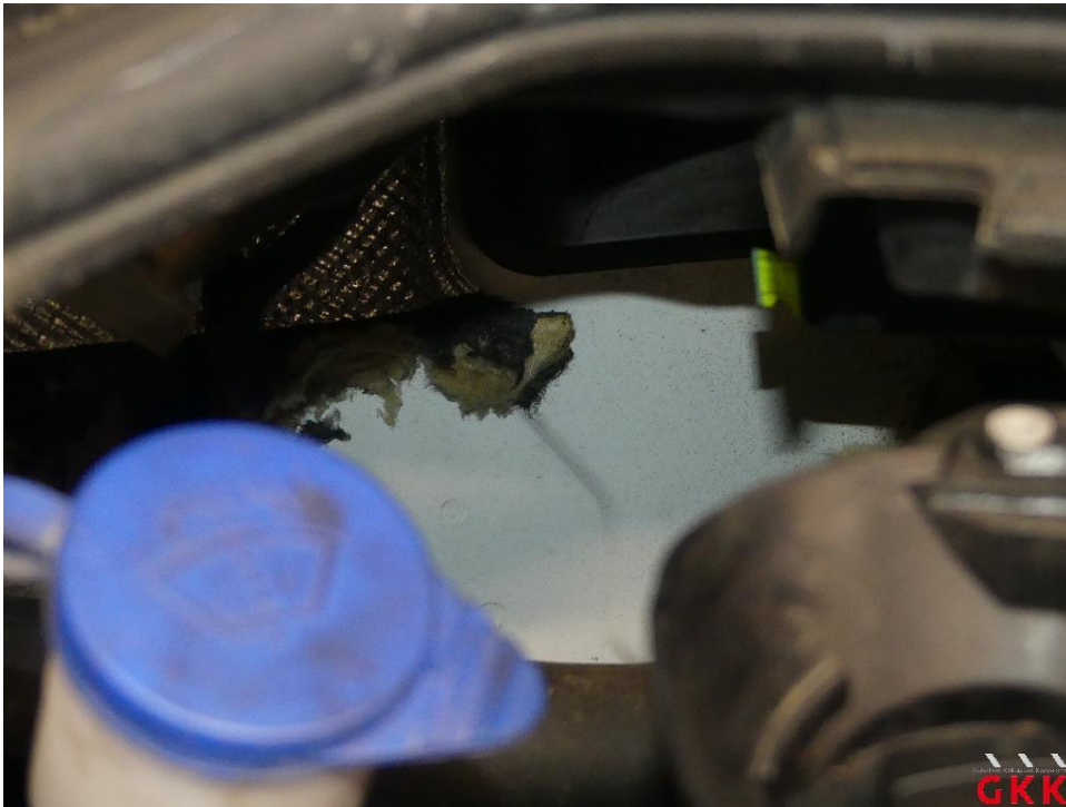
Bild 16 Motorraum, Dämmmatte, beschädigt, ersetzen
