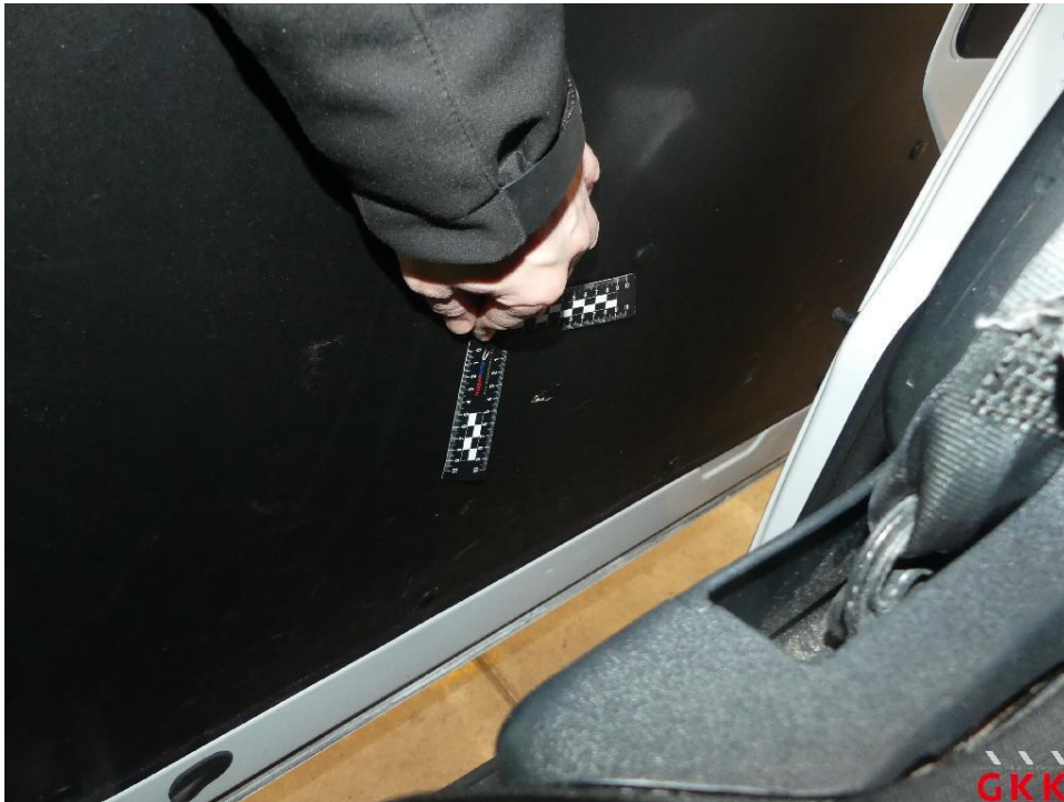
Bild 23 Schiebetür rechts, Innenverkleidung -Abdeckung-, beschädigt, ersetzen
