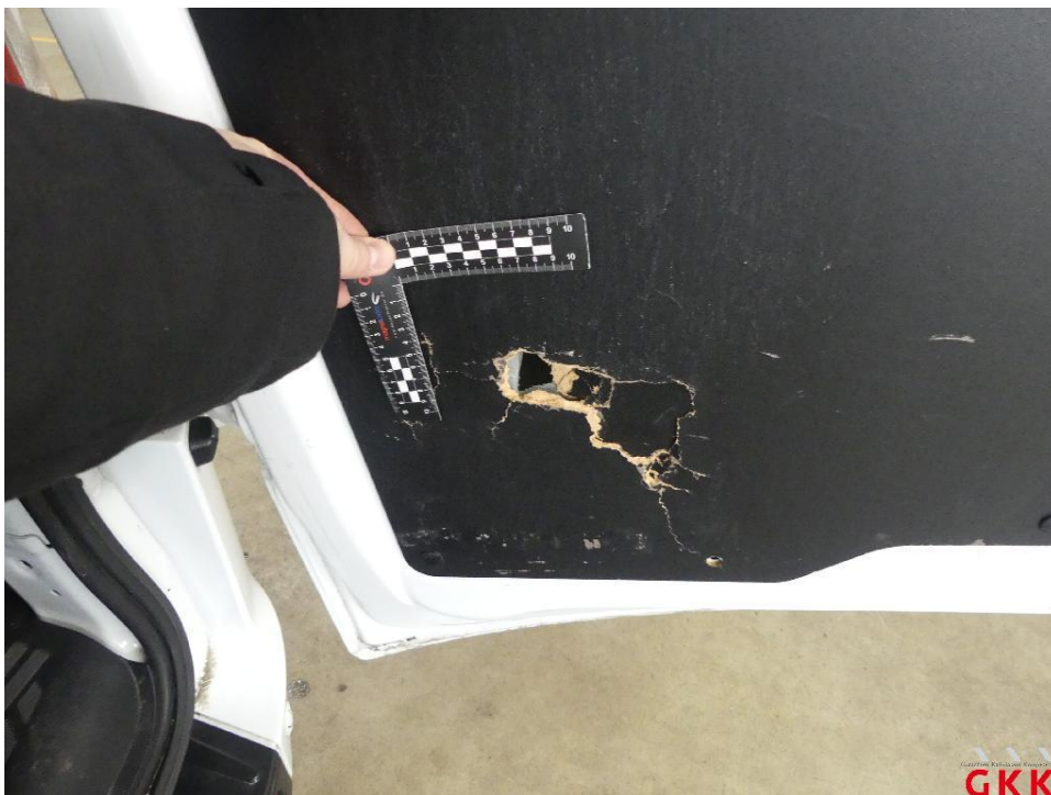
Bild 26 Hecktür rechts, Innenverkleidung -Abdeckung-, beschädigt, ersetzen
