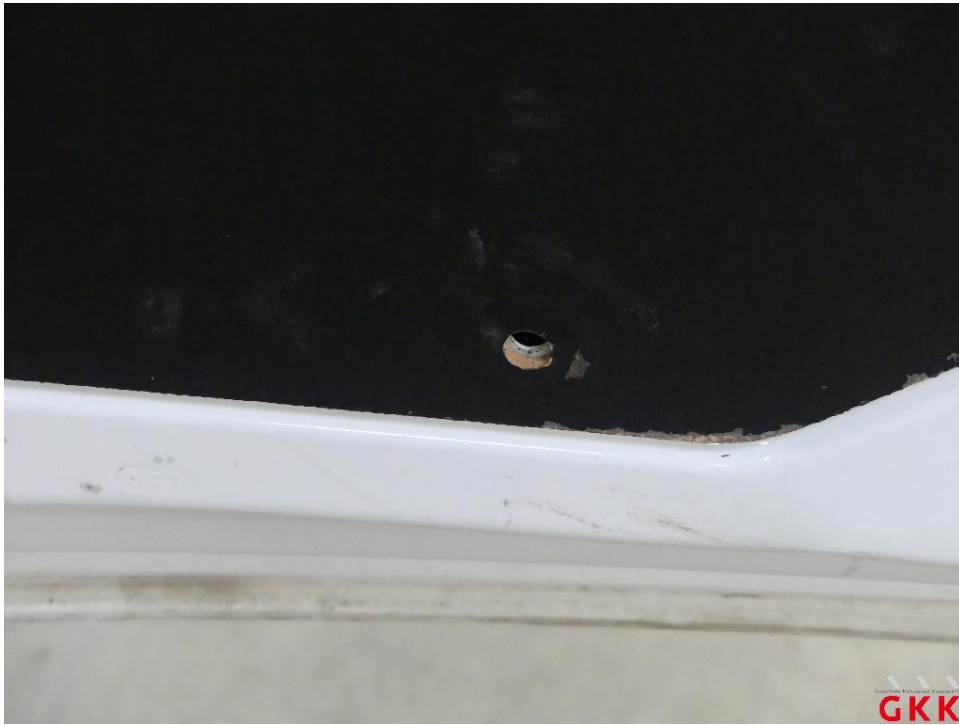
Bild 19 Hecktür rechts, Innenverkleidung, lose, instand setzen
