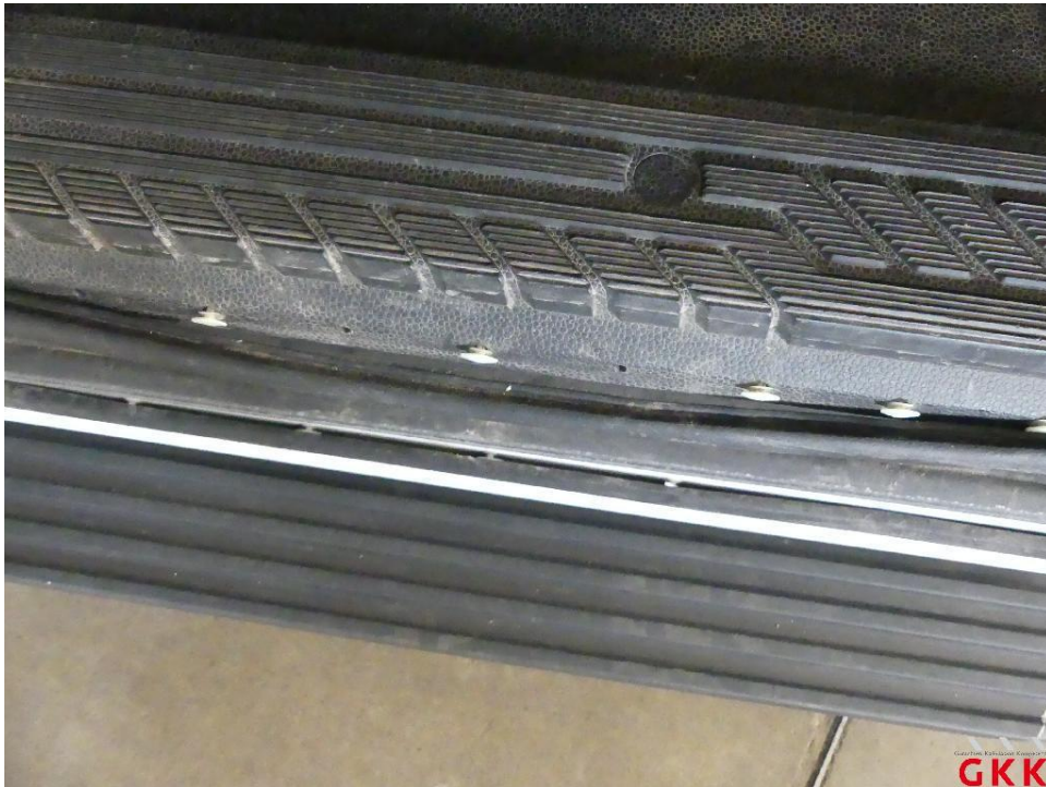
Bild 15 Schiebetür rechts, Dichtung -Einstieg-, lose, ersetzen
