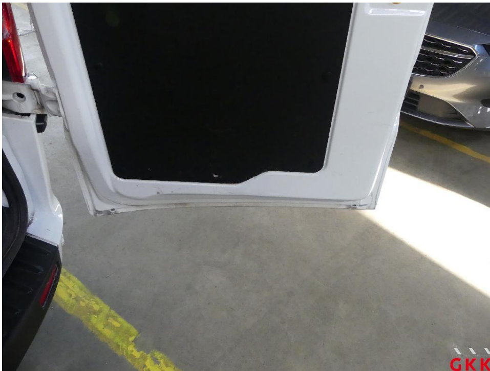
Bild 18 Hecktür rechts, Innenverkleidung, lose, instand setzen
