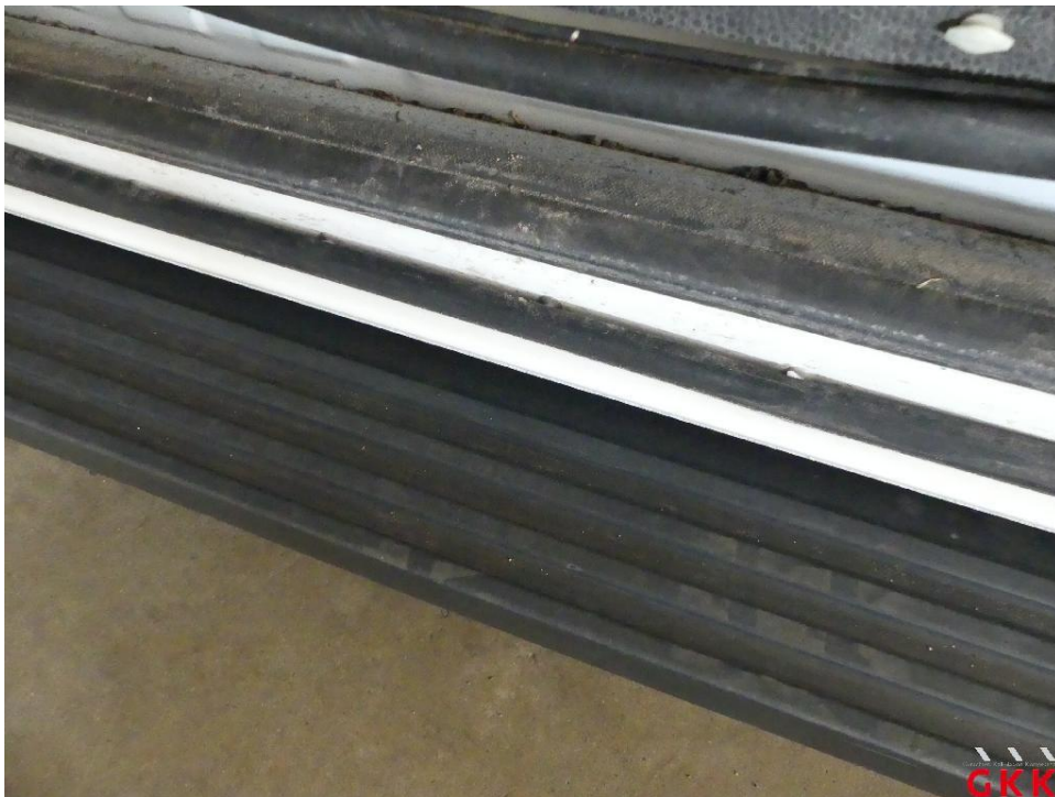
Bild 16 Schiebetür rechts, Dichtung -Einstieg-, lose, ersetzen
