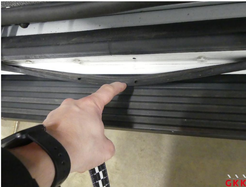
Bild 24 Schiebetür rechts, Dichtung -Einstieg-, lose, ersetzen
