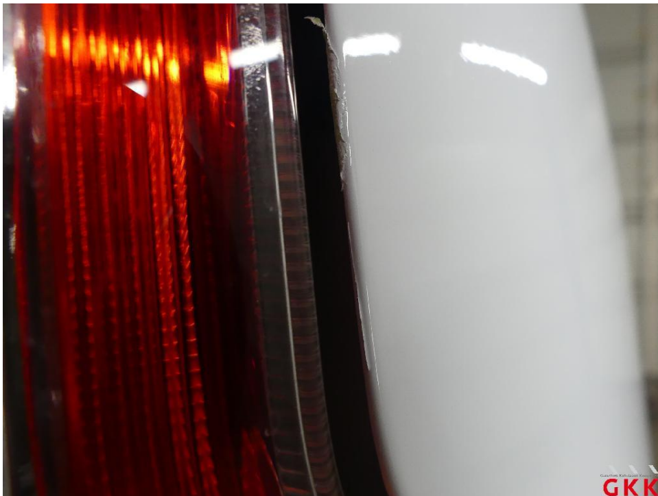
Bild 30 Hecktür links, Reparaturmangel, polieren
