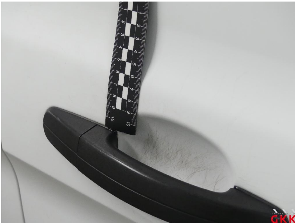
Bild 16 Tür vorne rechts / oberhalb, beschädigt, Smartrepair
