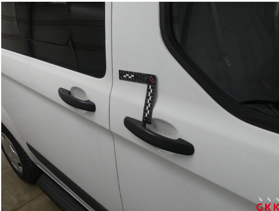
Bild 14 Tür vorne rechts / oberhalb, beschädigt, Smartrepair
