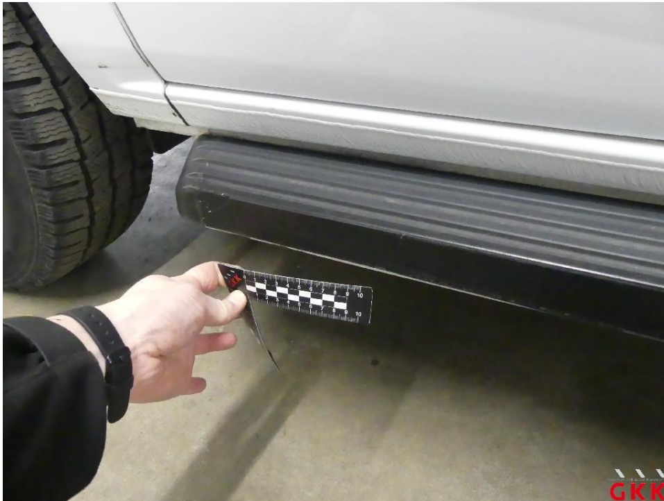
Bild 17 Schweller rechts, Trittbrett, beschädigt, ersetzen
