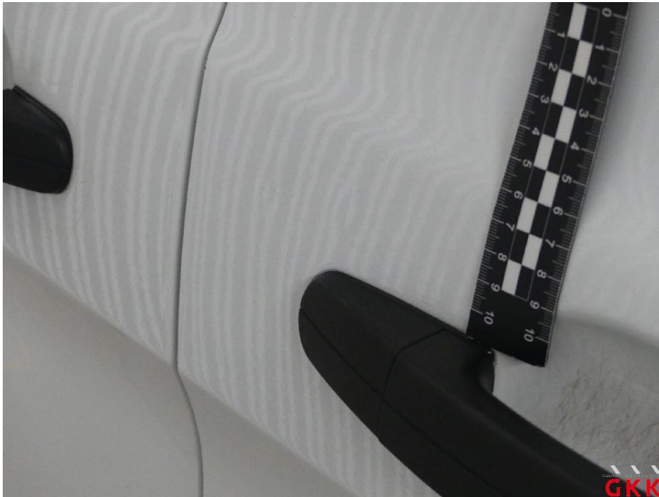
Bild 15 Tür vorne rechts / oberhalb, beschädigt, Smartrepair
