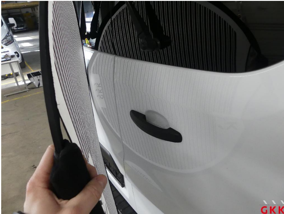
Bild 25 Hecktür rechts, Reparaturmangel, polieren
