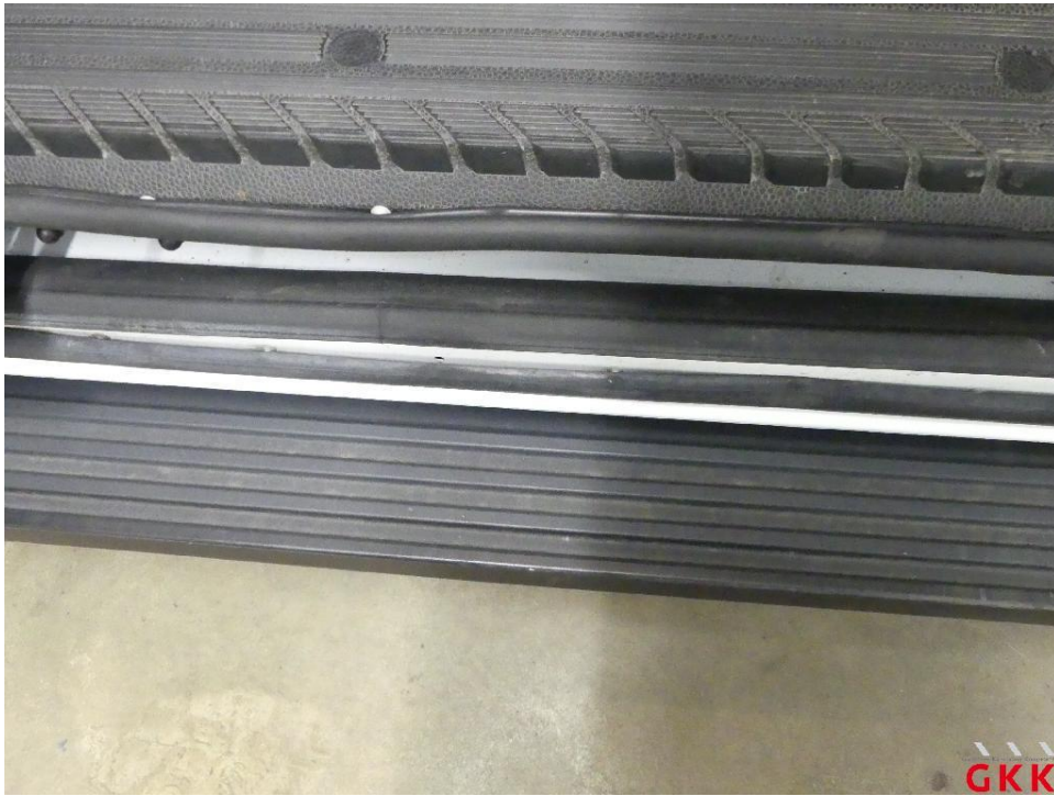
Bild 23 Schiebetür rechts, Dichtung -Einstieg-, lose, ersetzen
