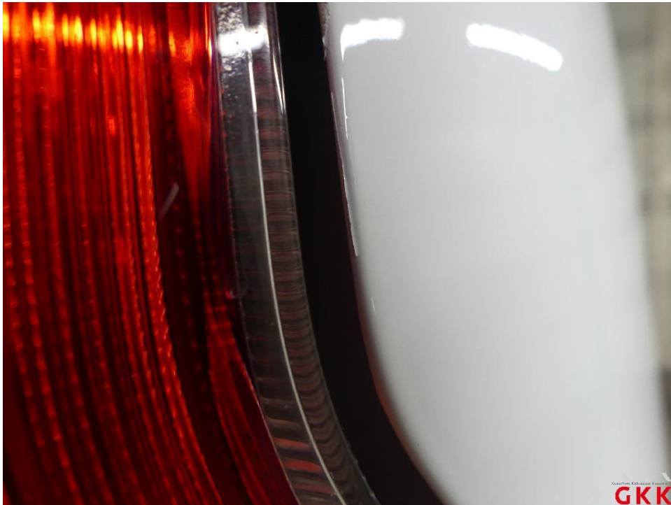
Bild 29 Hecktür links, Reparaturmangel, polieren
