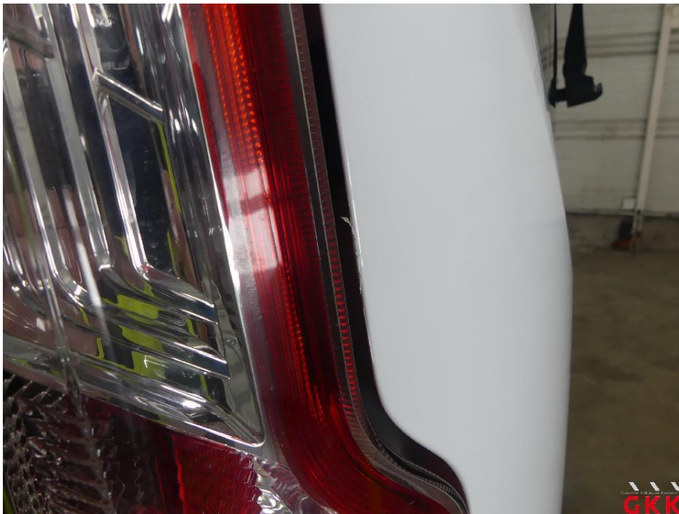
Bild 28 Hecktür links, Reparaturmangel, polieren
