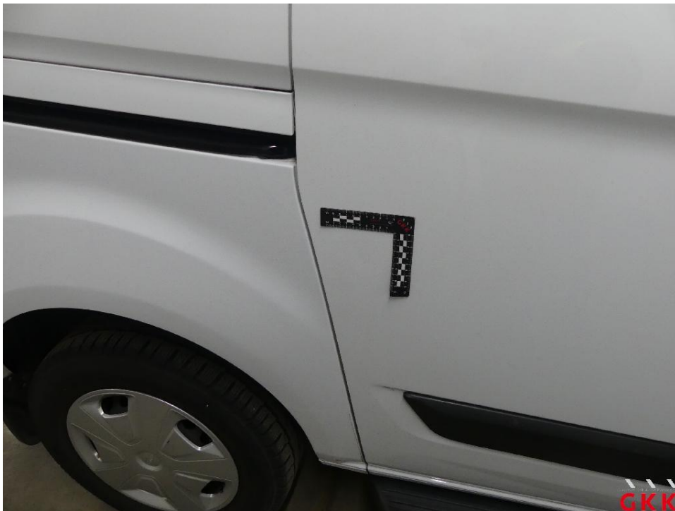
Bild 20 Schiebetür rechts, unterhalb, beschädigt, kalt drücken
