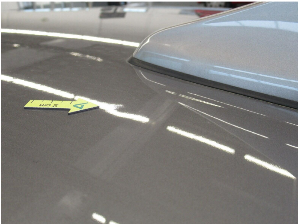
Bild 14 : Dach, eingedellt, drücken
