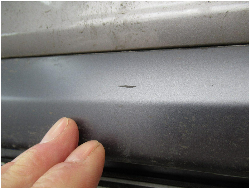
Bild 12 : Blenden Stoßfänger hinten leicht verschrammt
