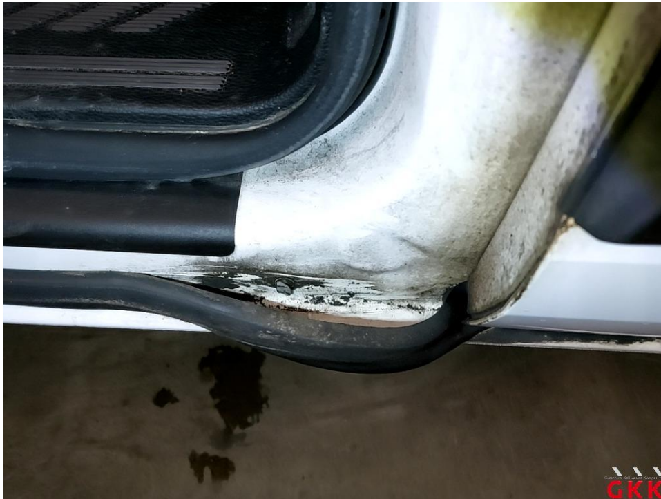
Bild 17 Tür vorne links, Dichtung -Einstieg-, beschädigt, ersetzen
