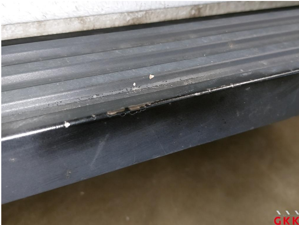
Bild 33 Trittbrett rechts verkratzt, ersetzen
