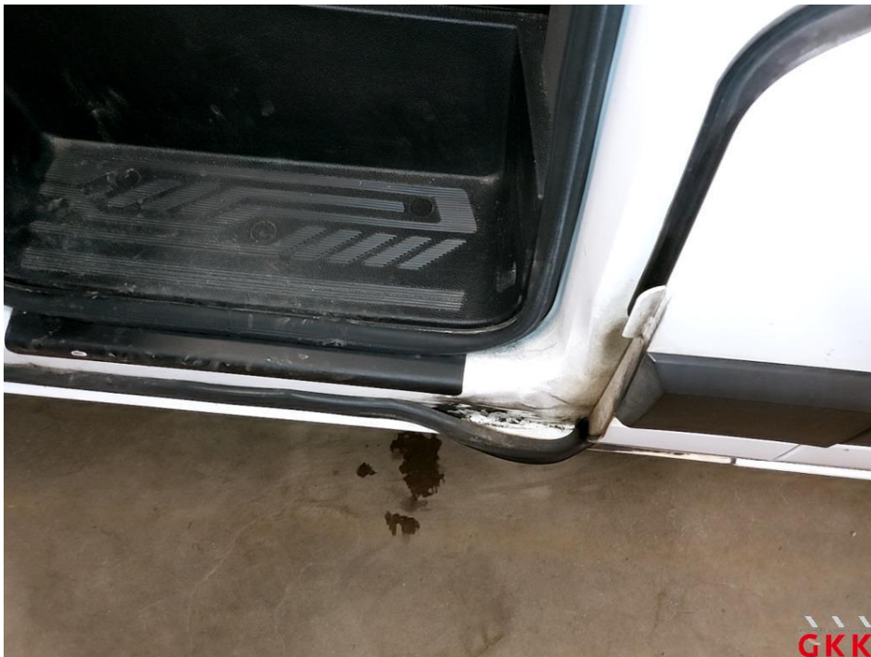
Bild 16 Tür vorne links, Dichtung -Einstieg-, beschädigt, ersetzen
