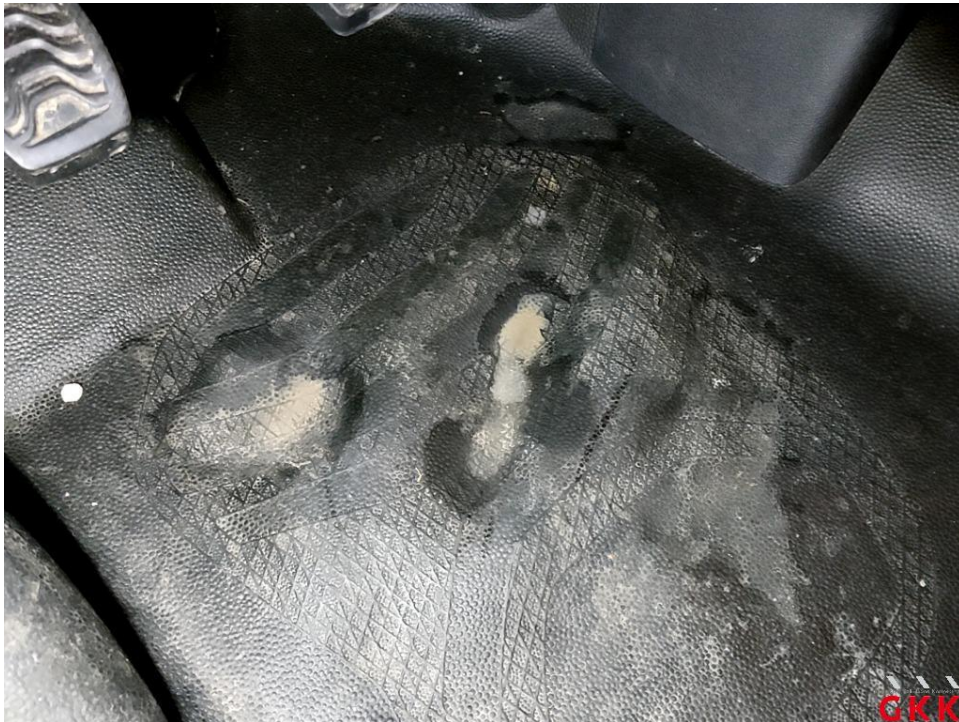
Bild 15 Bodenbelag vorne beschädigt - ersetzen
