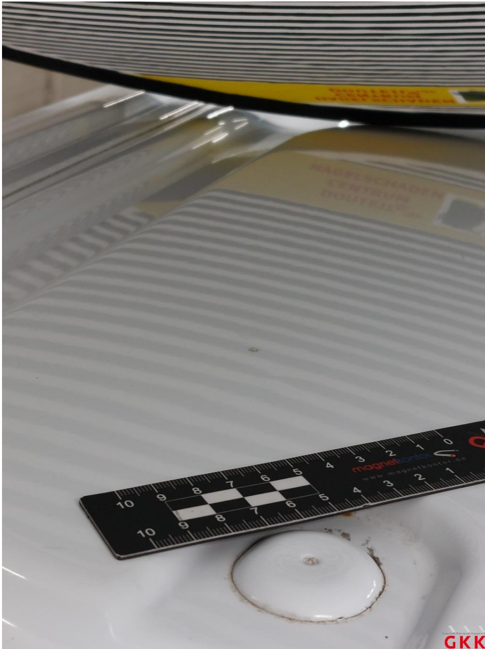
Bild 26 Dach, beschädigt, Smartrepair
