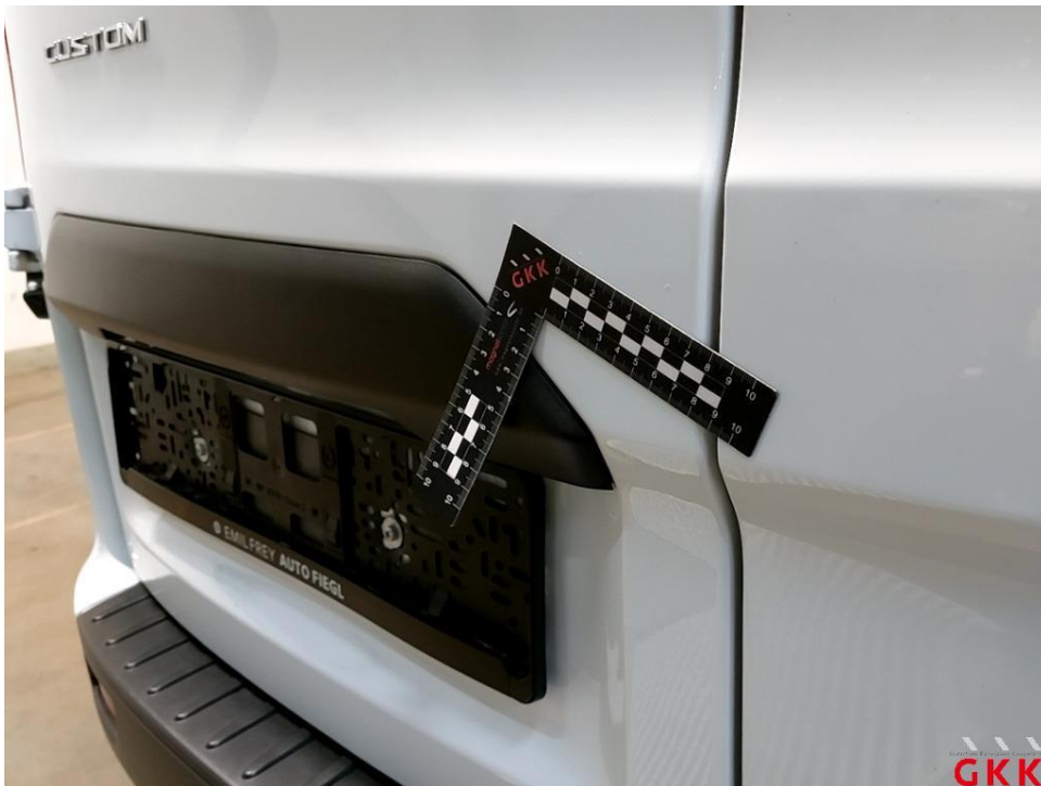
Bild 22 Hecktür links, Reparaturmangel, instand setzen - lackieren
