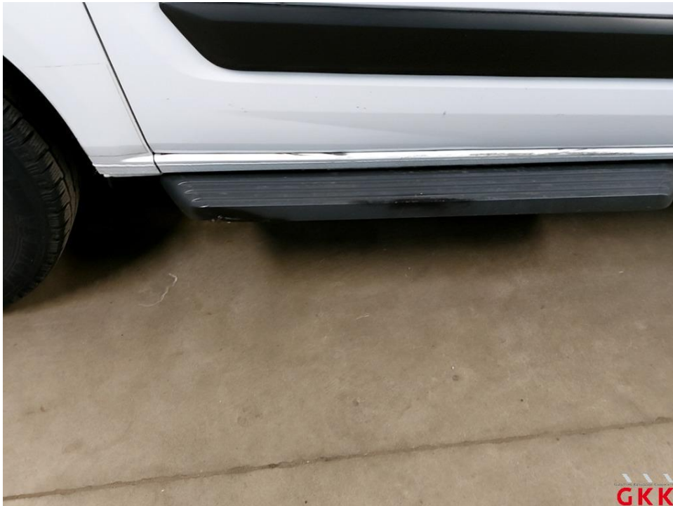
Bild 31 Trittbrett rechts verkratzt, ersetzen
