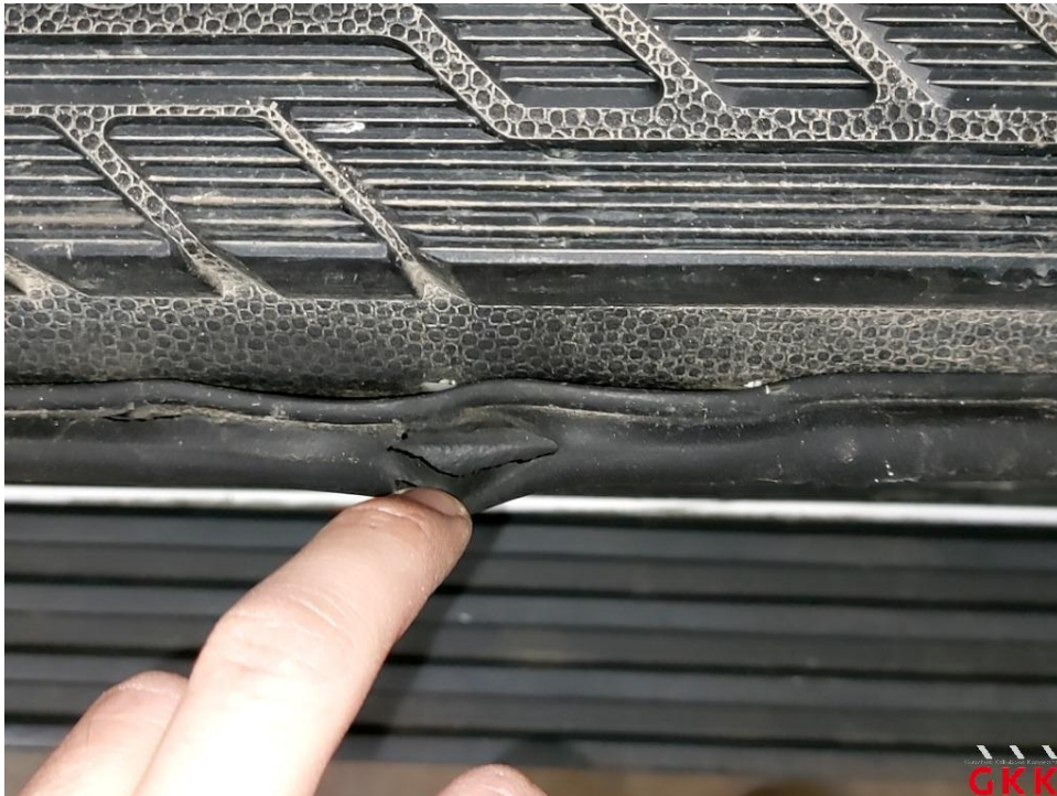
Bild 21 Schiebetür rechts, Dichtung -Einstieg-, beschädigt, ersetzen
