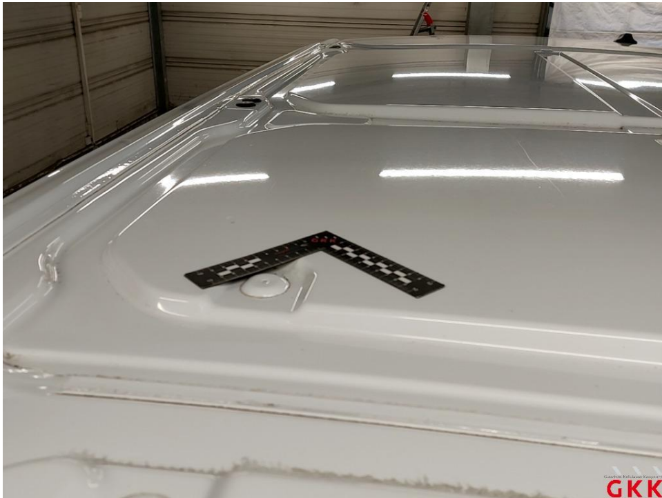
Bild 25 Dach, beschädigt, Smartrepair
