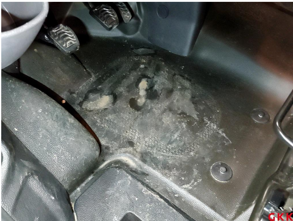
Bild 14 Bodenbelag vorne beschädigt - ersetzen
