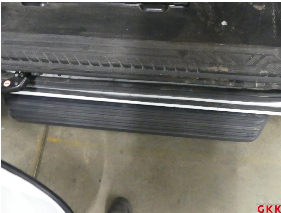
Bild 14 Schiebetür rechts, Dichtung -Einstieg-, lose, ersetzen
