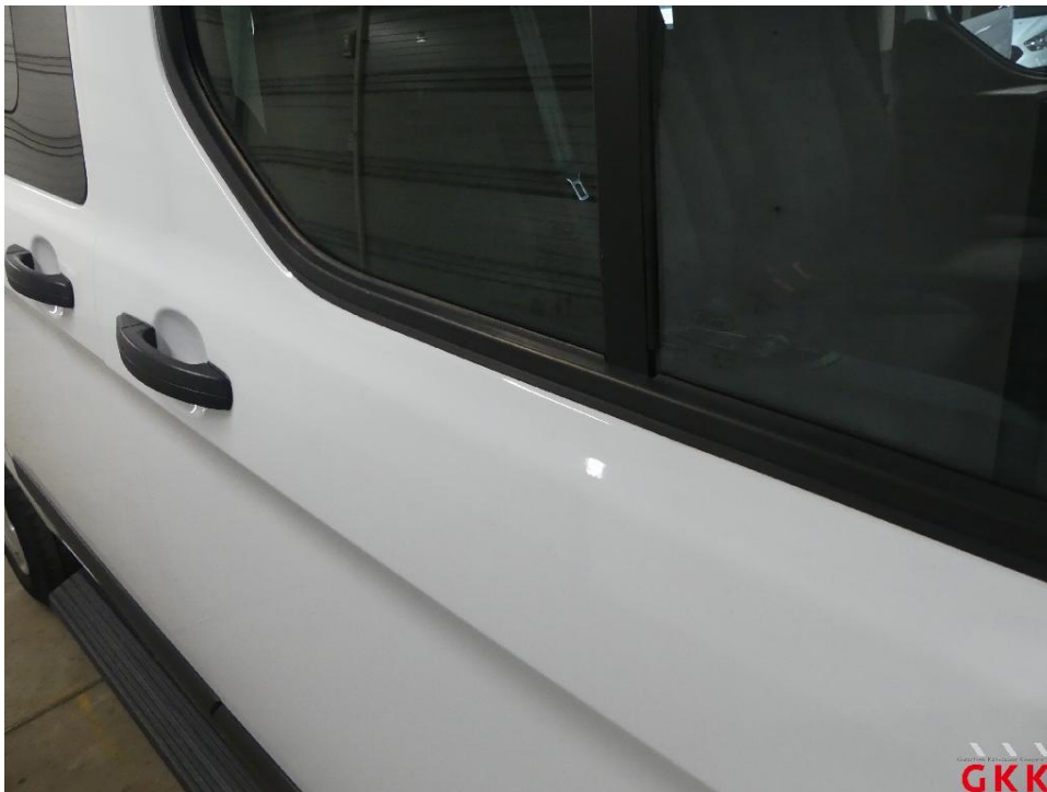
Bild 22 Tür vorne rechts, Reparaturmangel, polieren
