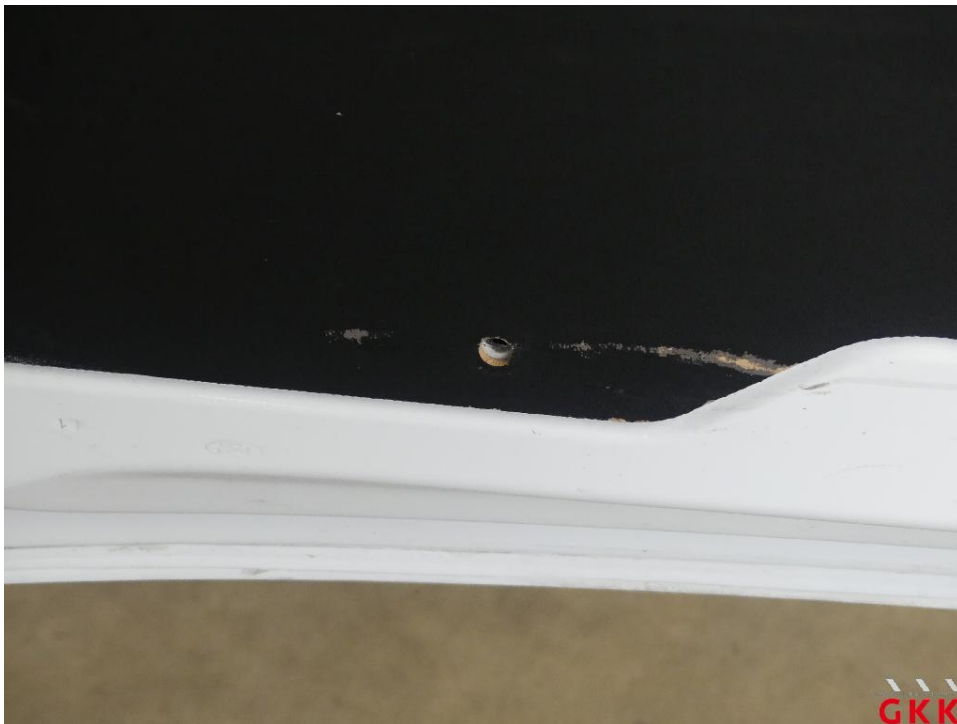
Bild 18 Hecktür rechts, Innenverkleidung, lose, instand setzen
