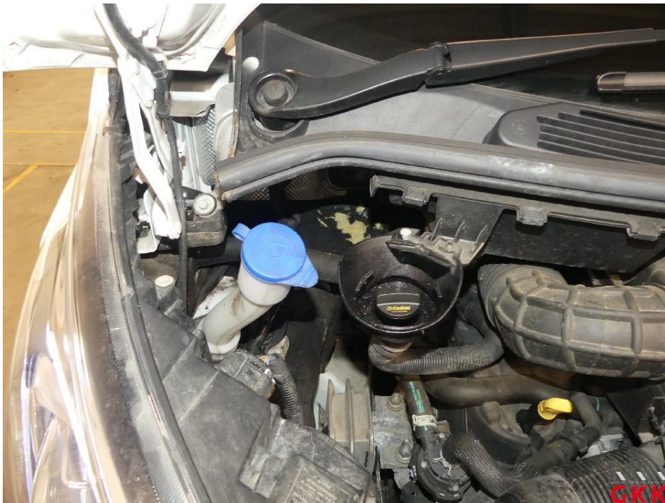
Bild 26 Motorraum, Dämmmatte, beschädigt, ersetzen
