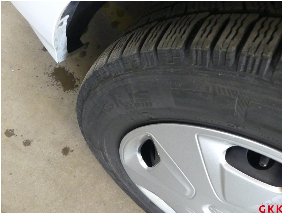
Bild 25 Reifen, vorn links und rechts, falsche Reifenart, ersetzen
