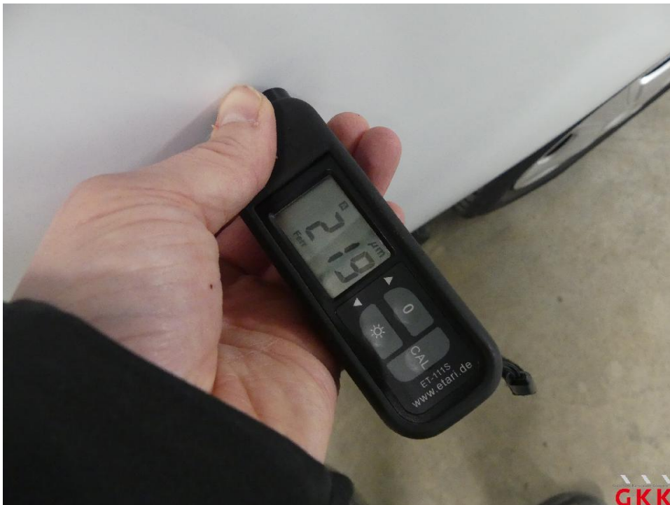
Bild 24 Tür vorne rechts, Reparaturmangel, polieren
