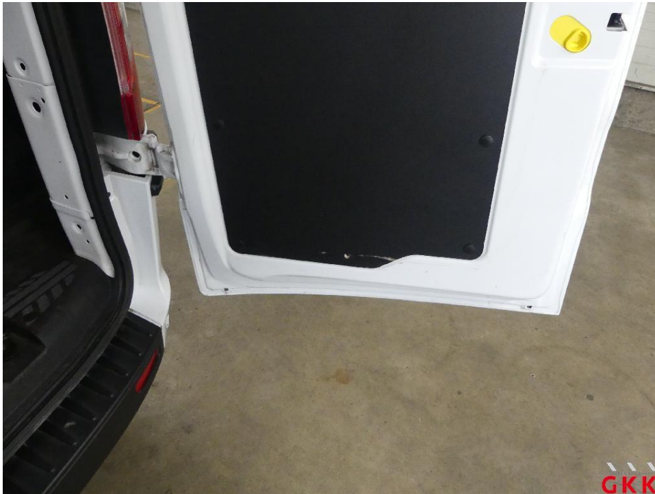
Bild 17 Hecktür rechts, Innenverkleidung, lose, instand setzen
