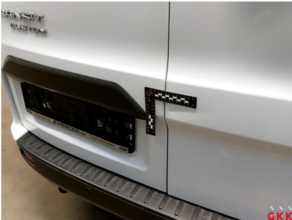
Bild 32 Hecktür links, bis 3 Dellen / Bauteil, Smartrepair
