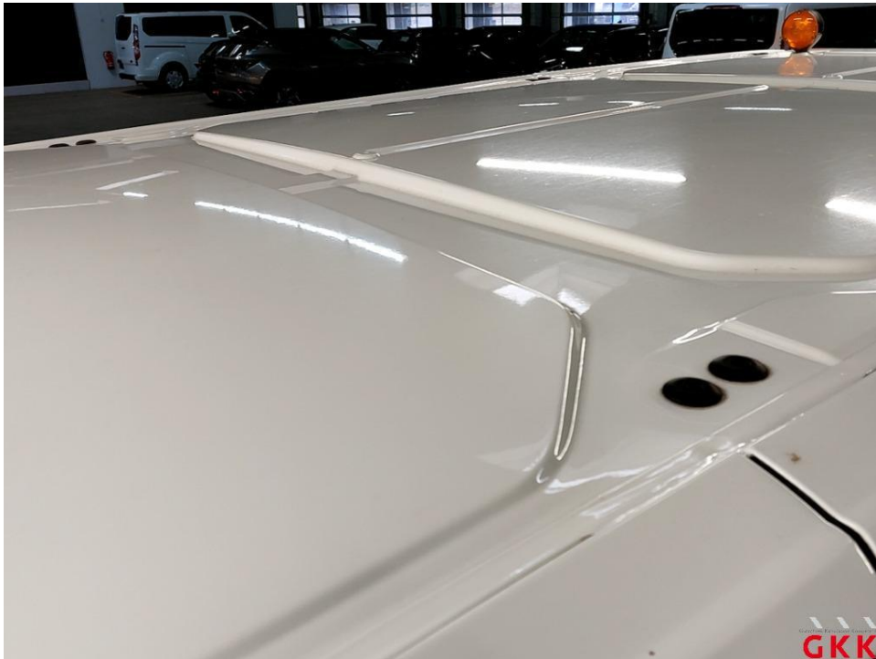
Bild 17 Dach, bis 3 Dellen / Bauteil, kalt drücken
