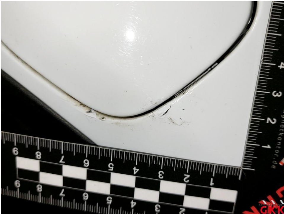
Bild 23 Stoßfänger vorne, Verkleidung -lackiert-, verkratzt, auslegen, schleifen, polieren
