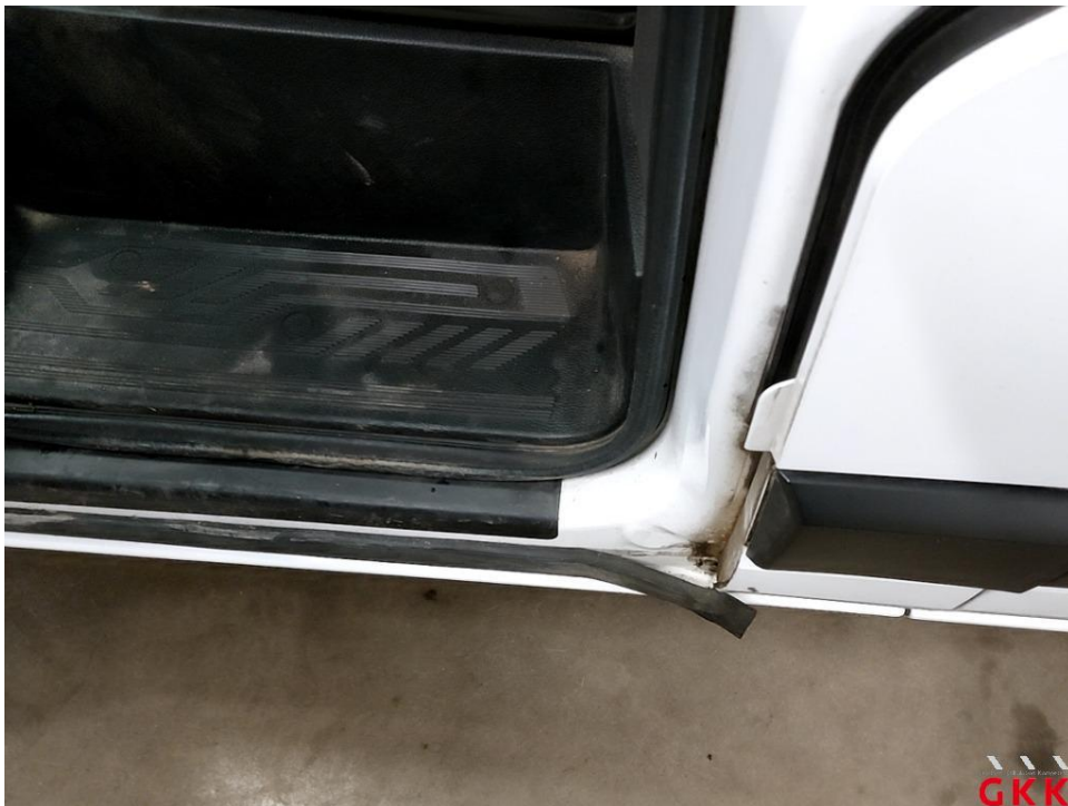
Bild 18 Tür vorne links, Dichtung -Einstieg-, lose, ersetzen
