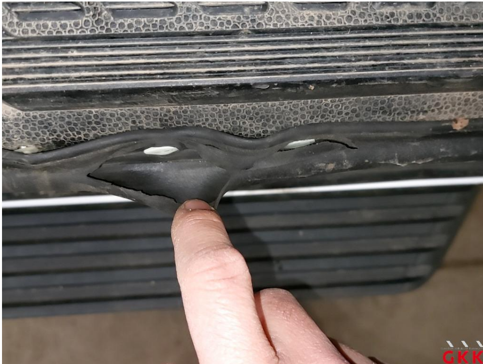
Bild 15 Schiebetür rechts, Dichtung -Einstieg-, beschädigt, ersetzen
