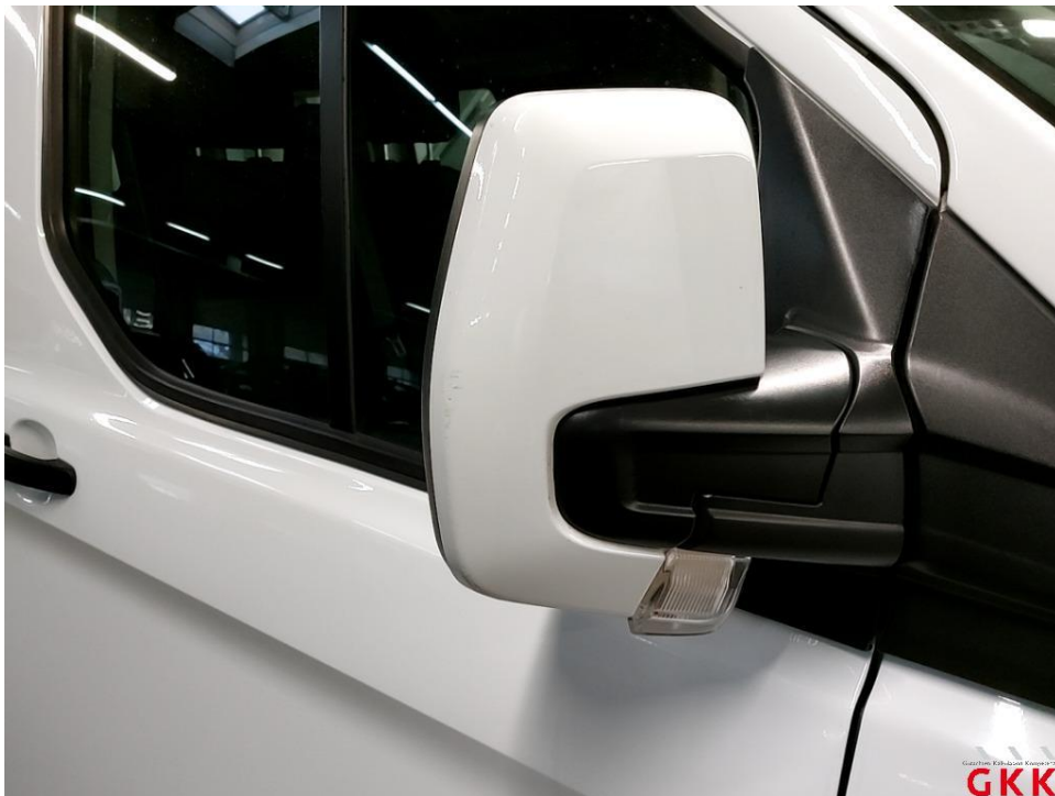
Bild 24 Spiegelgehäuse links, Kappe -lackiert-, verkratzt, lackieren ohne LV
