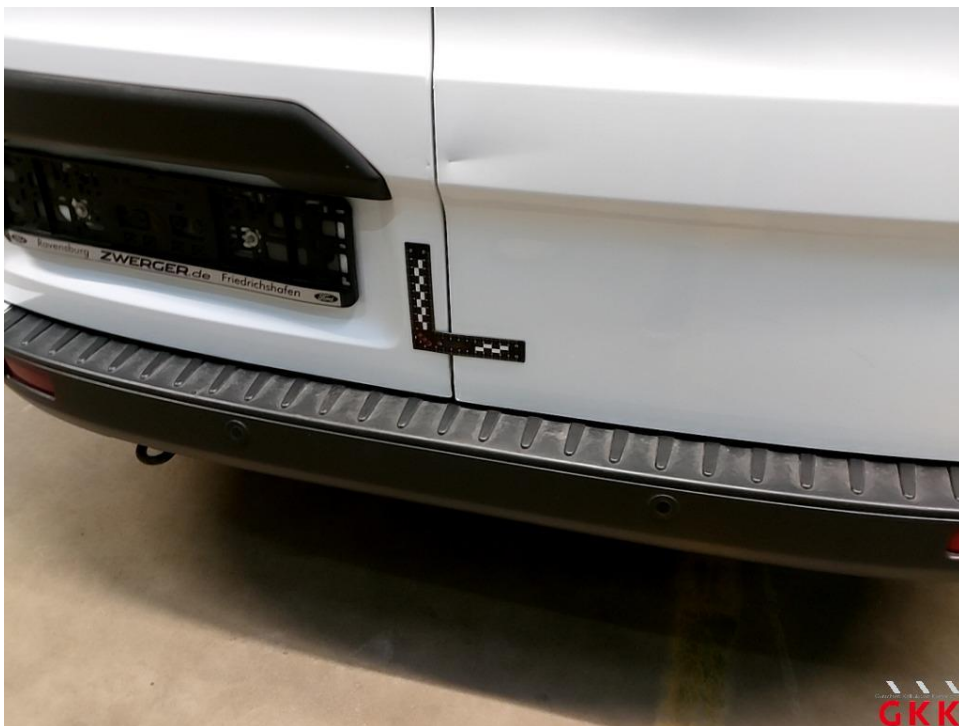
Bild 28 Hecktür rechts, Reparaturmangel, lackieren
