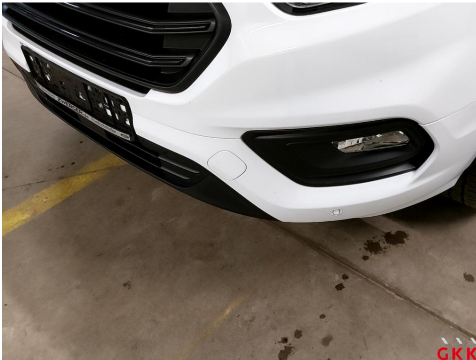
Bild 22 Stoßfänger vorne, Verkleidung -lackiert-, verkratzt, auslegen, schleifen, polieren
