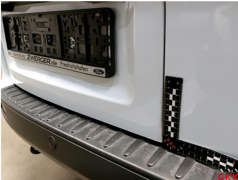
Bild 30 Hecktür links, Reparaturmangel, lackieren
