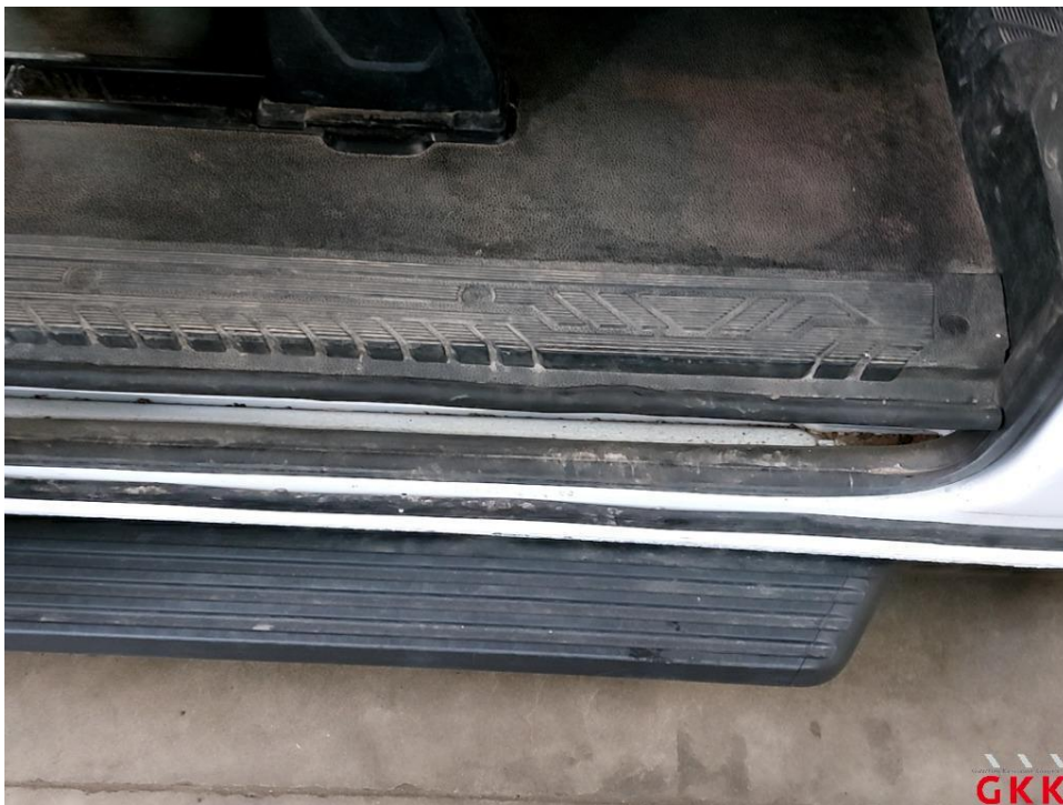
Bild 14 Schiebetür rechts, Dichtung -Einstieg-, beschädigt, ersetzen
