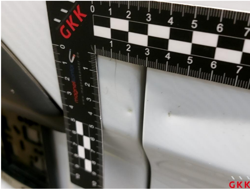
Bild 33 Hecktür links, bis 3 Dellen / Bauteil, Smartrepair
