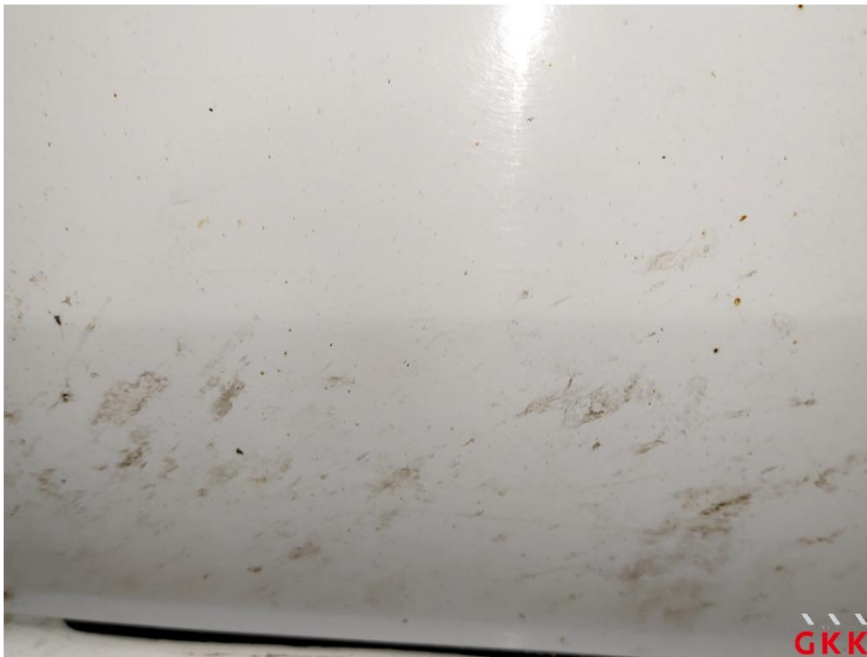
Bild 20 Fahrzeug, außen, Lackierung verwittert / matt, aufbereiten
