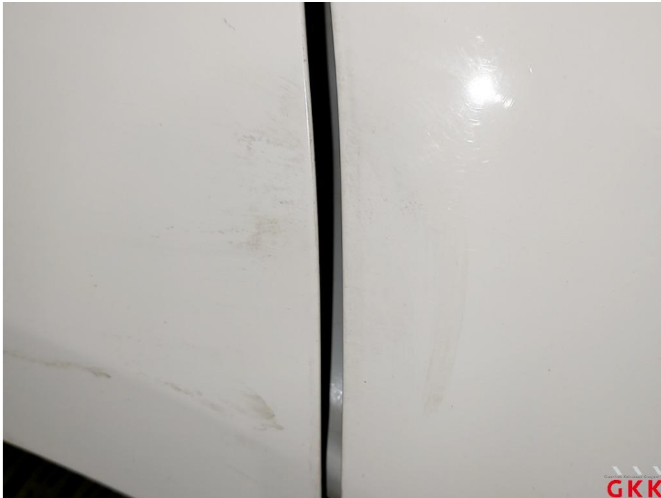
Bild 21 Fahrzeug, außen, Lackierung verwittert / matt, aufbereiten
