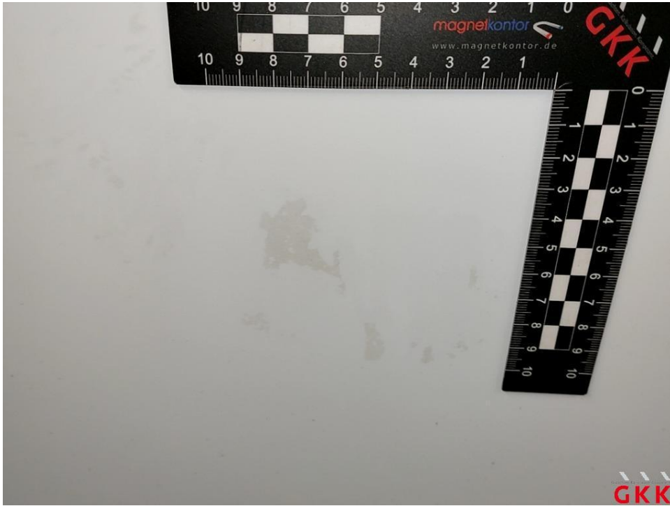
Bild 19 Fahrzeug, außen, Lackierung verwittert / matt, aufbereiten
