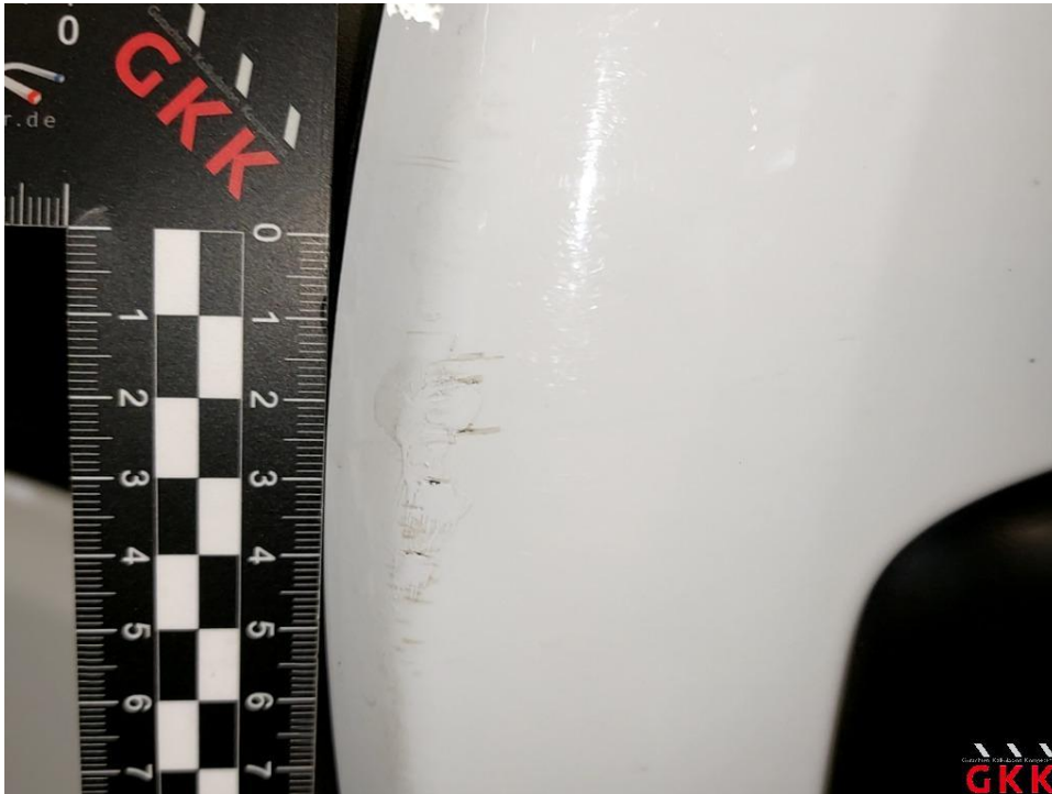
Bild 25 Spiegelgehäuse links, Kappe -lackiert-, verkratzt, lackieren ohne LV
