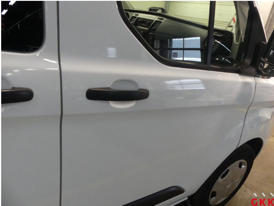
Bild 27 Tür vorne rechts, Reparaturmangel, polieren
