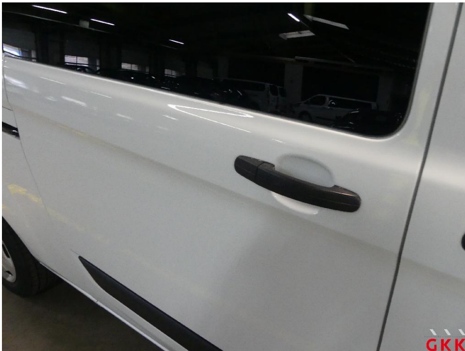
Bild 24 Schiebetür rechts, Reparaturmangel, polieren
