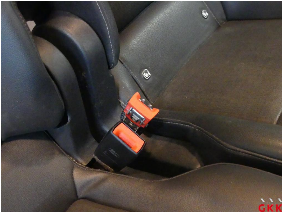
Bild 17 Sitz vorne Mitte, Gurtschloss, beschädigt, ersetzen
