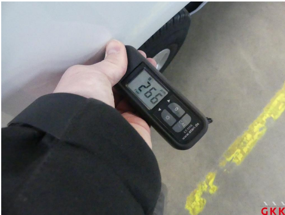
Bild 22 Seitenwand rechts, Reparaturmangel, polieren
