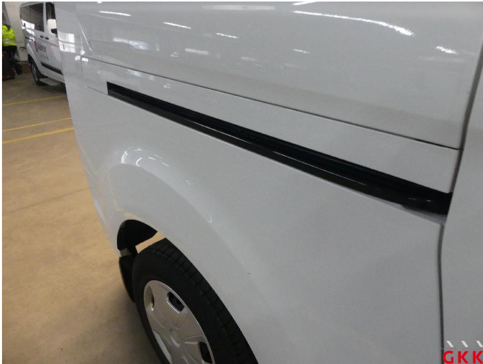
Bild 21 Seitenwand rechts, Reparaturmangel, polieren
