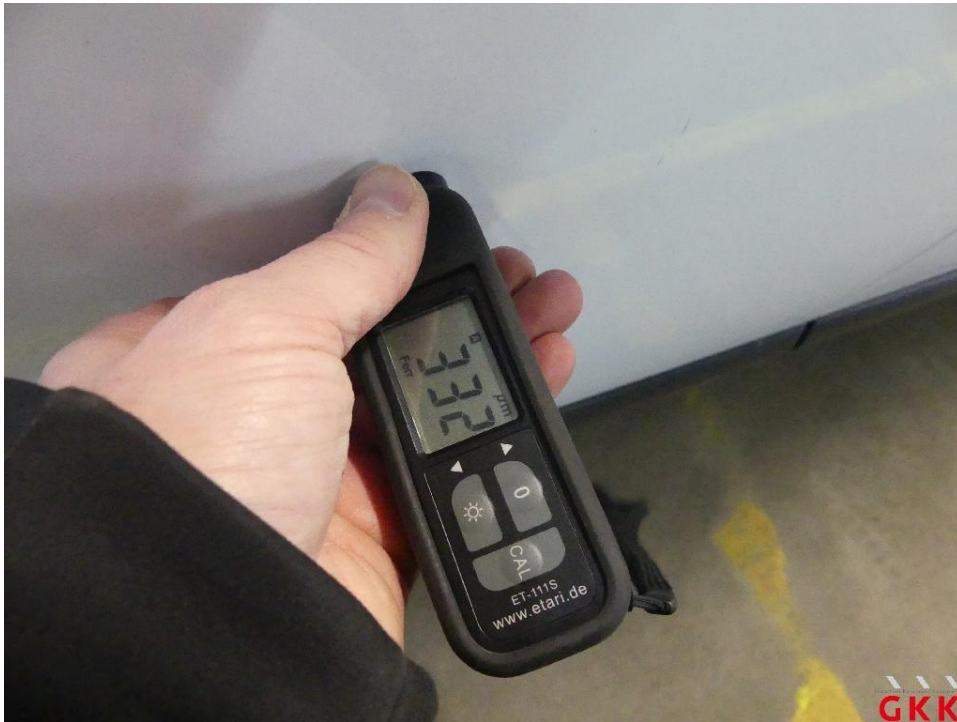
Bild 25 Schiebetür rechts, Reparaturmangel, polieren
