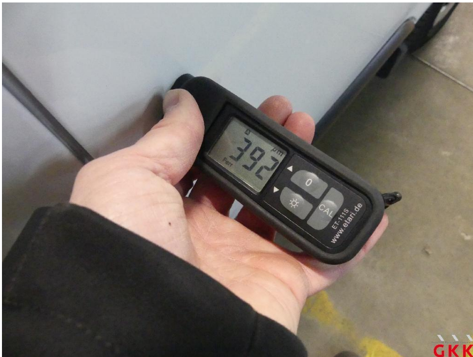
Bild 28 Tür vorne rechts, Reparaturmangel, polieren
