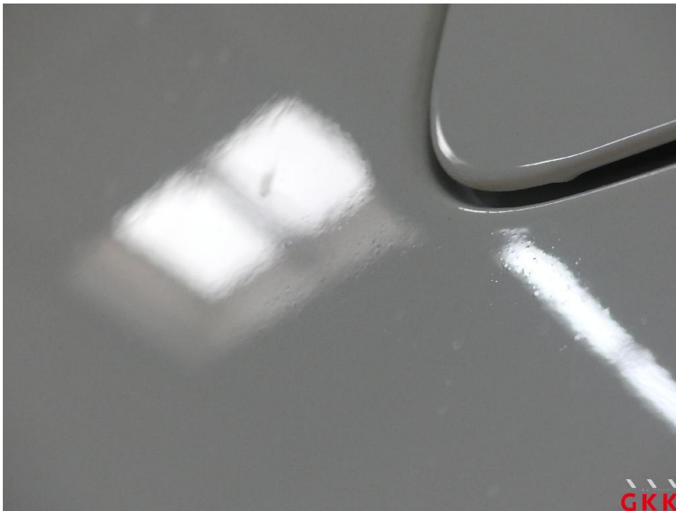
Bild 26 Schiebetür rechts, Reparaturmangel, polieren
