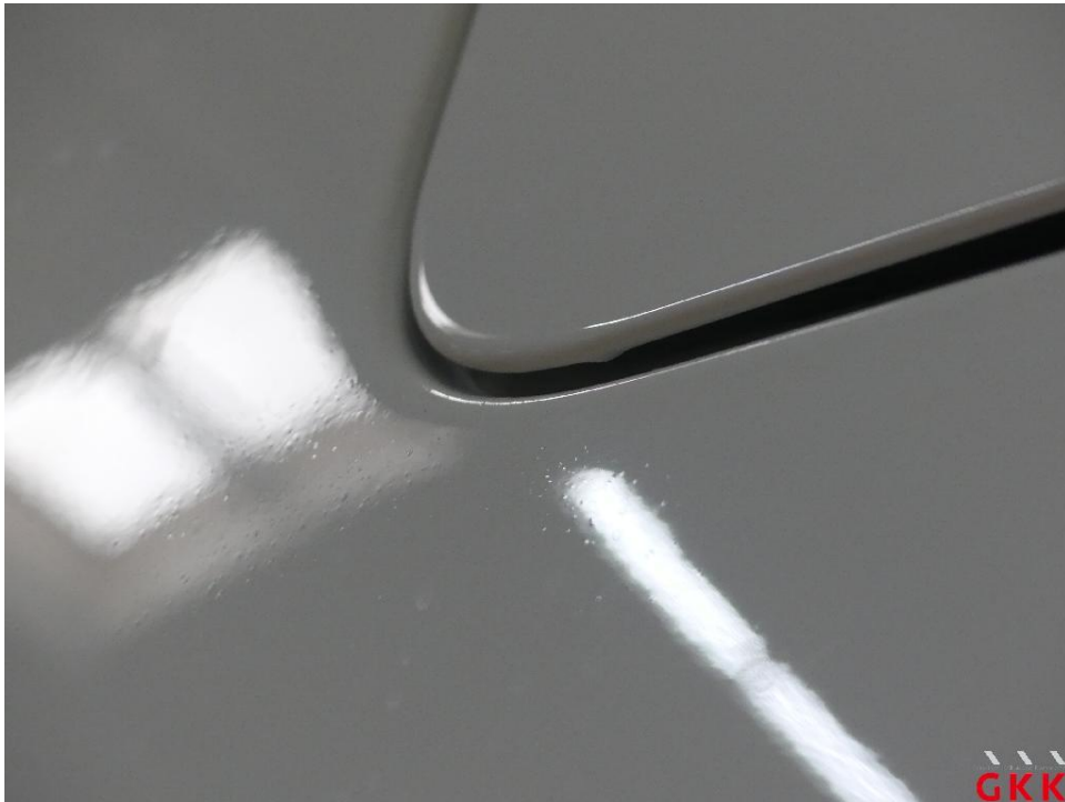
Bild 29 Tür vorne rechts, Reparaturmangel, polieren
